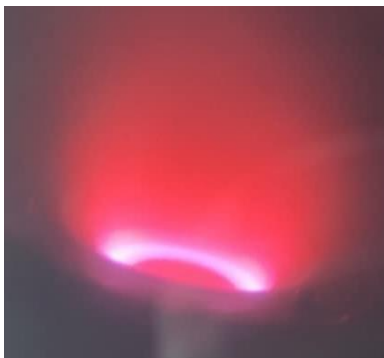
Rysunek 6.2. Obszar gęstej plazmy nad powierzchnią targetu (target – Al, gaz szlachetny – Ar)
