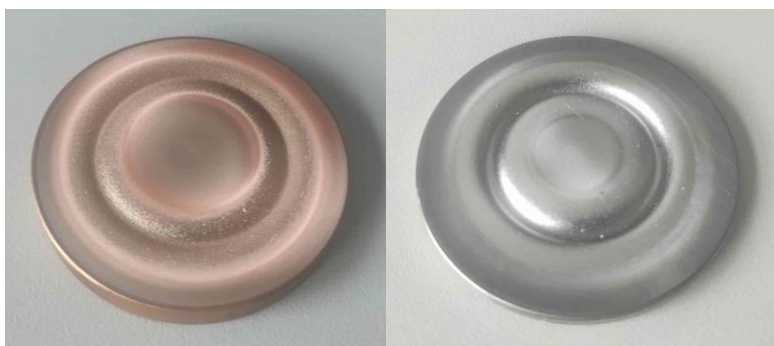
Rysunek 6.3. Targety miedzi oraz permaloju wykorzystywane w metodzie rozpylania magnetronowego
