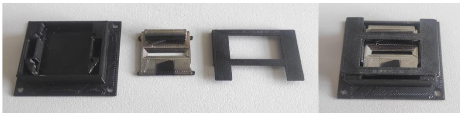
Rysunek 8.7. Elementy obudowy druku 3D służące określeniu szerokości i długości struktur serii 2 i 3
