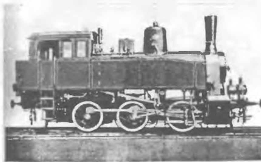
Rys. 5. Pierwszy parowóz z FABLOK-u typu T1A dla kolei przemysłowych z 1928 roku.
