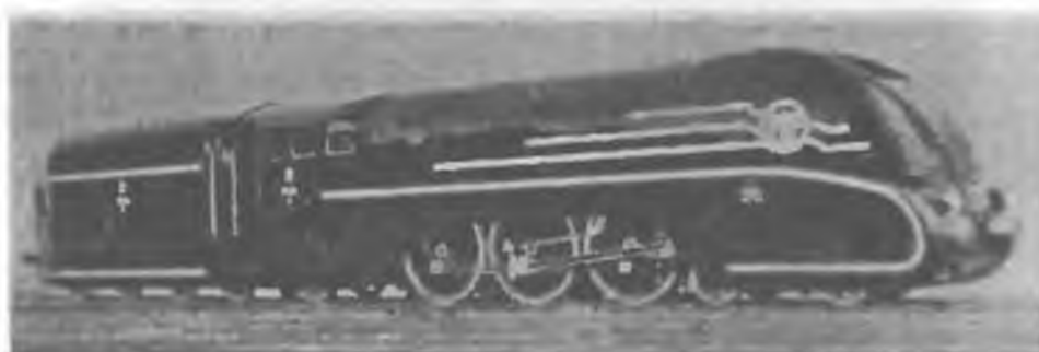
Rys. 9. Pierwszy polski parowóz pospieszny z otuliną opływową serii Pm36-1 (nr. fabr. 662 z 1937 r.).
