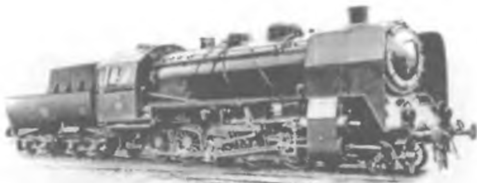
Ryc. 10. Parowóz towarowy Ty45-1 (nr fabr.1579) zbudowany w Fabloku w 1946 roku według zmodernizowanej dokumentacji parowozu Ty37.
