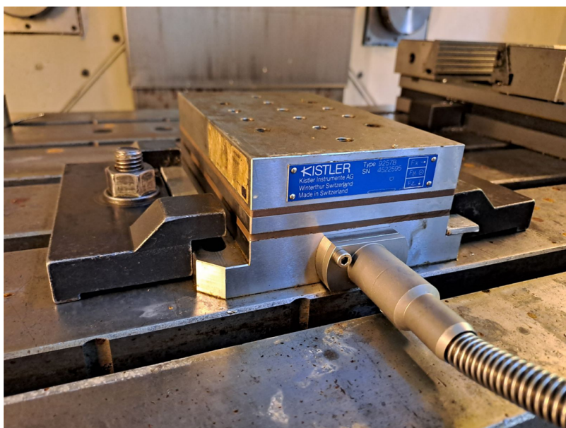
Ryc. 4.4. Siłomierz piezoelektryczny Kistler 9257B
