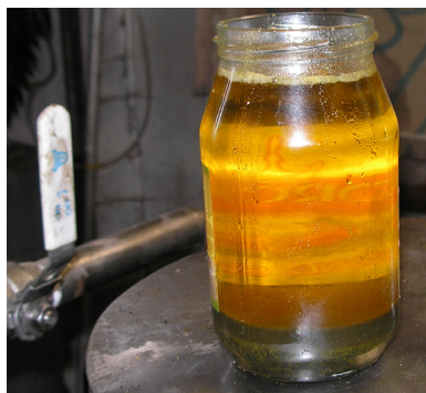
Rys. 4. Rozwarstwienie związków na metyloester i glicerynę
