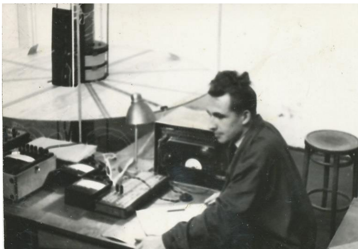
Pomiary rozkładu strumienia magnetycznego modelu transformatora bezjarmowego
