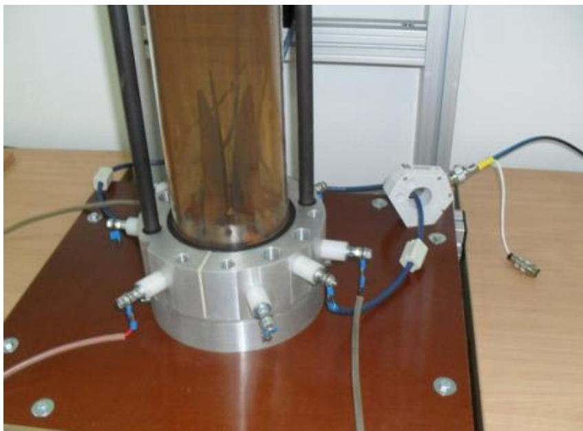
Rys. 9 Zdjęcie fragmentu instalacji reaktora w trakcie badań (widok na koraliki ferrytowe na przewodach zapłonowych i na sondę prądową)
