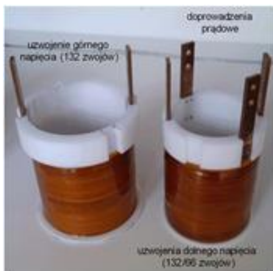
Rys. 9. Uzwojenia nadprzewodnikowe transformatora
