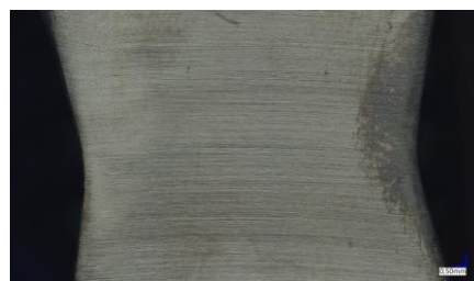
Rysunek 7.8. Widok na powierzchnię próbki nagrzanej do temperatury 950 °C, kształtowanej na drodze s = 165 mm, od lewej przekrój prostopadły do osi, przekrój zgodny z osią
