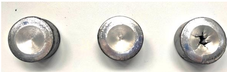
Rysunek 4.7. Próbkki ze stali S355 odkształcone w kanale, otrzymane dla drogi kształtowania s wynoszącej (licząc od lewej): 500 mm, 600 mm, 800 mm, stopień gniotu \delta = 1,04
