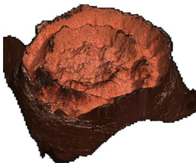
Rysunek 5.17. Trójwymiarowa wizualizacja i widok powierzchni rozdzielenia próbki z miedzi CW008A po próbie rozciągania, typ próbki 3
