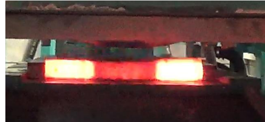
Rysunek 8.1. Test walcowania poprzeczno-klinowego przeprowadzony na próbce o wymiarach \varnothing 26 \times 215 mm nagrzanej do temperatury 1150 °C; a) umieszczenie próbki na ścieżce prowadzącej dolnego narzędzia, b) zaawansowany etap procesu walcowania, c) przewalcowana próbka
