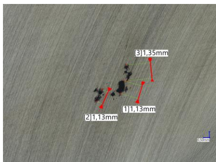
Rysunek 7.9. Widok na powierzchnię próbki nagrzanej do temperatury 950 °C, kształtowanej na drodze s = 175 mm, od lewej przekrój prostopadły do osi, przekrój zgodny z osią
