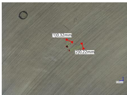
Rysunek 7.12. Widok na powierzchnię próbki nagrzanej do temperatury 1050 °C, kształtowanej na drodze s = 260 mm, od lewej przekrój prostopadły do osi, przekrój zgodny z osią
