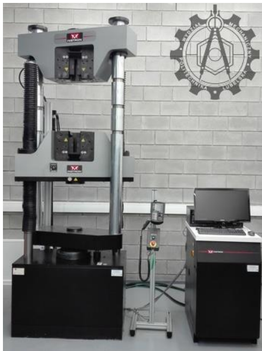
Rysunek 3.1. Maszyna wytrzymałościowa INSTRON o obciążeniu maksymalnym do 1000 kN
