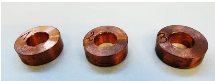
Rysunek 3.10. Próbk pierścieniowe z miedzi CW008A przygotowane do badań warunków tarcia
