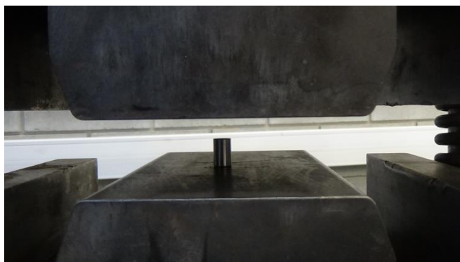
Rysunek 3.4. Widok próbki umieszczonej między dwoma płaskimi kowadłami do badań plastometrycznych – próba ściskania
