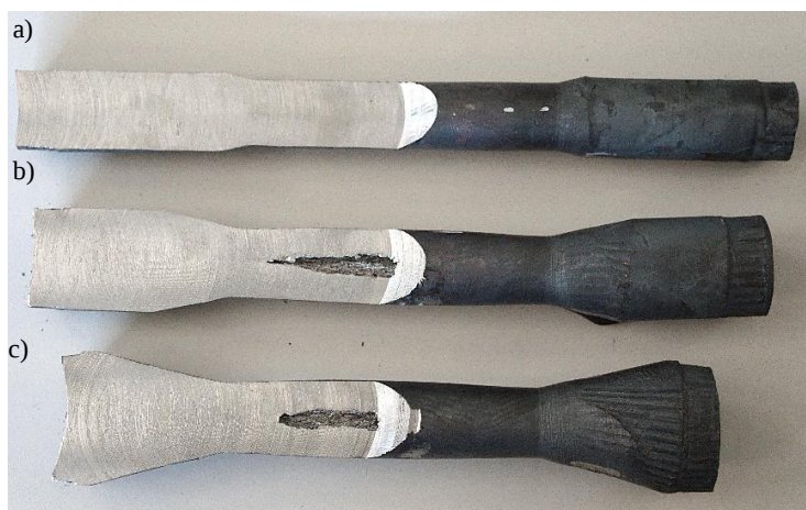
Rysunek 8.2. Próbkki uzyskane z próby walcowania poprzeczno-klinowego, a) \delta = 1,182 , b) \delta = 1,500 , c) \delta = 1,818
