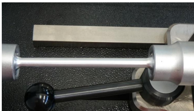
Rysunek 3.6. Widok próbki umieszczonej w uchwytach maszyny skręcającej do badań plastometrycznych – próba skręcania
