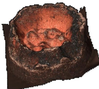
Rysunek 5.15. Trójwymiarowa wizualizacja i widok powierzchni rozdzielenia próbki z miedzi CW008A po próbie rozciągania, typ próbki 2
