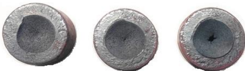
Rysunek 7.1. Próbkki odkształcone w kanale z wsadów nagranych do temperatury 950 °C, otrzymane dla drogi kształtowania s wynoszącej (licząc od lewej): 185 mm, 200 mm, 250 mm, stopień gniotu \delta = 1,05
