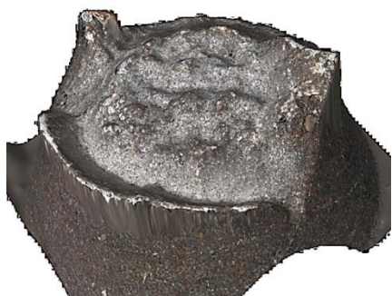
Rysunek 5.14. Trójwymiarowa wizualizacja i widok powierzchni rozdzielenia próbki ze stali S355 po próbie rozciągania, typ próbki 1
