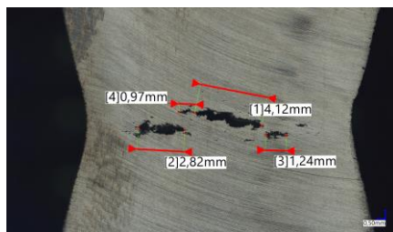
Rysunek 7.9. Widok na powierzchnię próbki nagrzanej do temperatury 950 °C, kształtowanej na drodze s = 175 mm, od lewej przekrój prostopadły do osi, przekrój zgodny z osią
