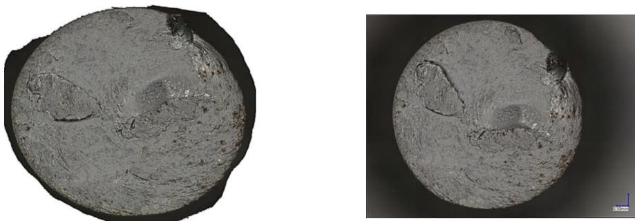
Rysunek 5.20. Trójwymiarowa wizualizacja i widok powierzchni rozdzielenia próbki ze stali S355, po próbie skręcania
