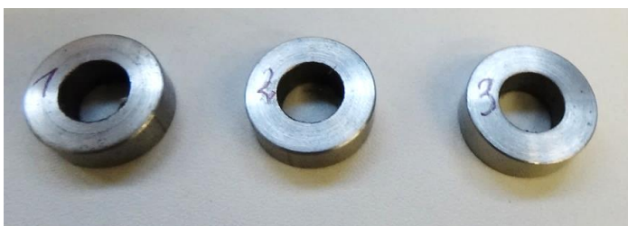
Rysunek 3.11. Próbk pierścieniowe ze stali S355 przygotowane do badań warunków tarcia
