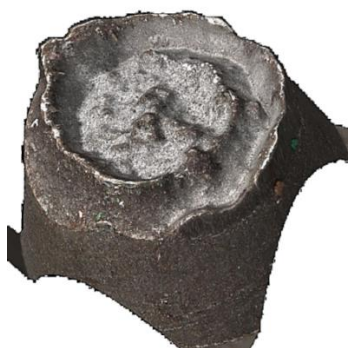
Rysunek 5.16. Trójwymiarowa wizualizacja i widok powierzchni rozdzielenia próbki ze stali S355 po próbie rozciągania, typ próbki 2
