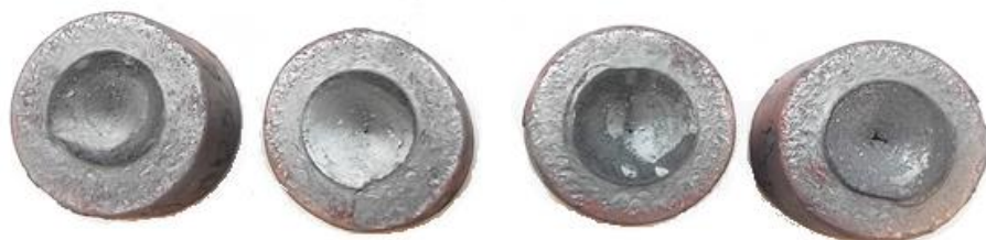
Rysunek 7.2. Próbkki odkształcone w kanale z wsadów nagranych do temperatury 1050 °C, otrzymane dla drogi kształtowania s wynoszącej (licząc od lewej): 280 mm, 290 mm, 300 mm, 320 mm, stopień gniotu \delta = 1,05
