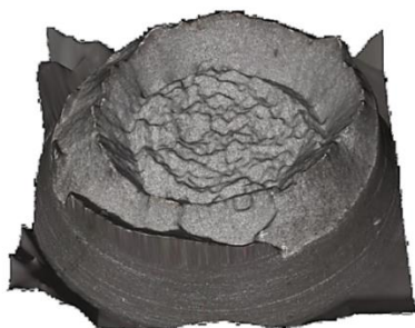
Rysunek 5.18. Trójwymiarowa wizualizacja i widok powierzchni rozdzielenia próbki ze stali S355 po próbie rozciągania, typ próbki 3
