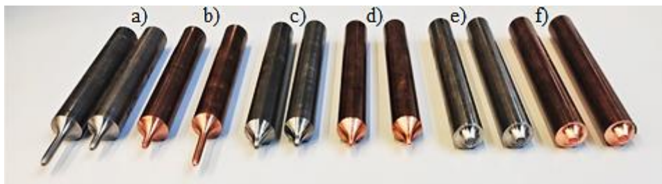
Rysunek 5.5. Widok próbek po przeprowadzonej próbie rozciągania dla prędkości ruchu narzędzi 5 mm/min, a) stal S355 – typ 1, b) miedź CW008A – typ 1, c) stal S355 – typ 2, d) miedź CW008A – typ 2, e) stal S355 – typ 3, f) miedź CW008A – typ 3
