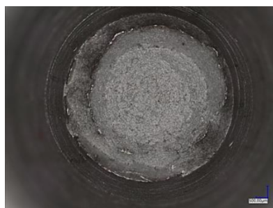
Rysunek 5.17. Trójwymiarowa wizualizacja i widok powierzchni rozdzielenia próbki z miedzi CW008A po próbie rozciągania, typ próbki 3
