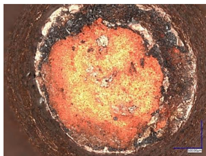
Rysunek 5.15. Trójwymiarowa wizualizacja i widok powierzchni rozdzielenia próbki z miedzi CW008A po próbie rozciągania, typ próbki 2
