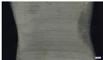
Rysunek 7.11. Widok na powierzchnię próbki nagrzanej do temperatury 1050 °C, kształtowanej na drodze s = 250 mm, od lewej przekrój prostopadły do osi, przekrój zgodny z osią
