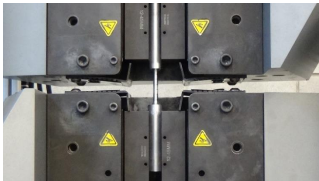
Rysunek 3.5. Widok próbki umieszczonej w szczękach maszyny wytrzymałościowej do badań plastometrycznych – próba rozciągania
