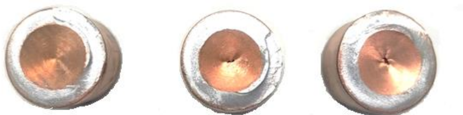
Rysunek 4.6. Próbkki z miedzi CW008A odkształcone w kanale, otrzymane dla drogi kształtowania s wynoszącej (licząc od lewej): 300 mm, 350 mm, 400 mm, stopień gniotu \delta = 1,05
