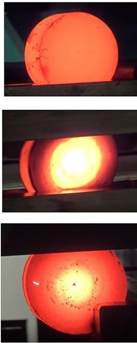
Rysunek 7.4. Przebieg obciskania obrotowego w kanale próbki nagrzanej do temperatury 950 °C, kształtowanej na długości drogi s = 200 mm; kolejno od góry: ustawienie próbki, obciskanie z widocznym zwiększeniem temperatury w strefie osiowej, powstawanie pęknięcia osiowego
