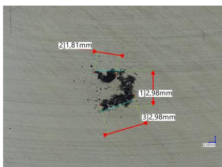
Rysunek 7.16. Widok na powierzchnię próbki nagrzanej do temperatury 1150 °C, kształtowanej na drodze s = 500 mm, od lewej przekrój prostopadły do osi, przekrój zgodny z osią
