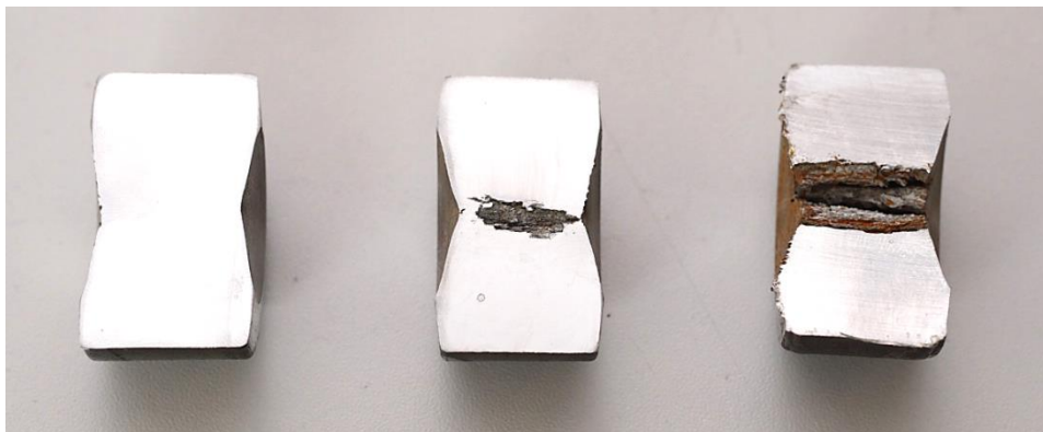
Rysunek 4.9. Przekroje próbek ze stali S355 odkształconych w temperaturze otoczenia 20 °C, otrzymane dla drogi kształtowania s wynoszącej (licząc od lewej): 500, 600, 800 mm
