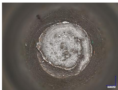
Rysunek 5.16. Trójwymiarowa wizualizacja i widok powierzchni rozdzielenia próbki ze stali S355 po próbie rozciągania, typ próbki 2
