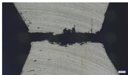
Rysunek 7.13. Widok na powierzchnię próbki nagrzanej do temperatury 1050 °C, kształtowanej na drodze s = 270 mm, od lewej przekrój prostopadły do osi, przekrój zgodny z osią
