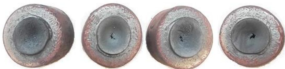
Rysunek 7.2. Próbkki odkształcone w kanale z wsadów nagranych do temperatury 1050 °C, otrzymane dla drogi kształtowania s wynoszącej (licząc od lewej): 280 mm, 290 mm, 300 mm, 320 mm, stopień gniotu \delta = 1,05
