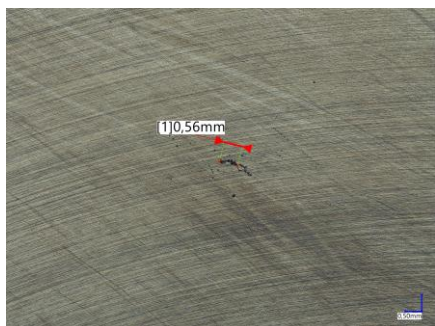
Rysunek 7.11. Widok na powierzchnię próbki nagrzanej do temperatury 1050 °C, kształtowanej na drodze s = 250 mm, od lewej przekrój prostopadły do osi, przekrój zgodny z osią
