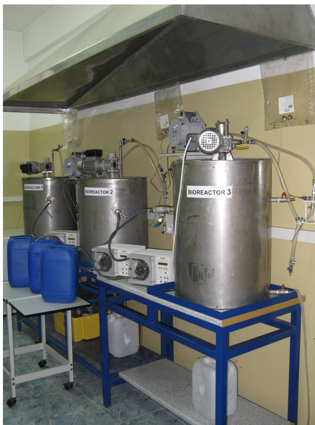
Fot. 3.1 Stanowisko do badań procesu współfermentacji
