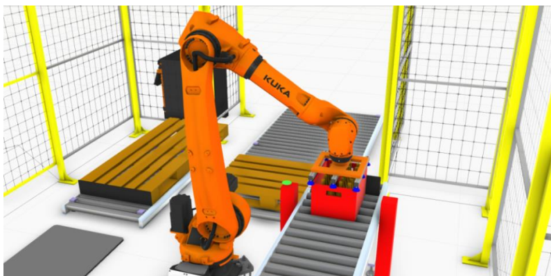
Rys. 10. Robot paletyzujący pobierający kontener z butelkami z przenośnika rolkowego
