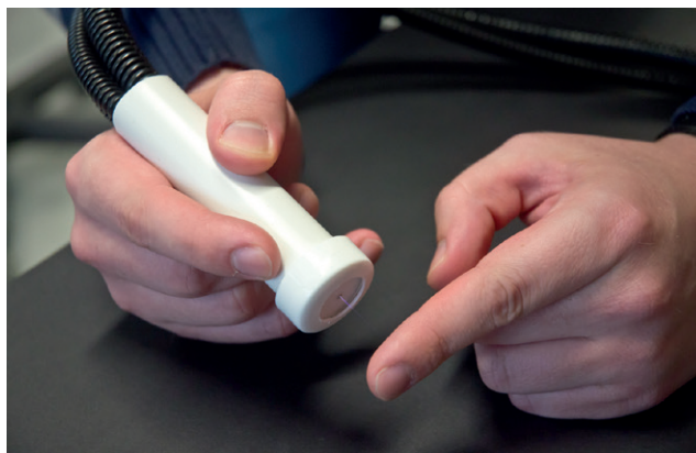
Generator plazmy z wyładowaniem barierowym do zastosowań biologicznych (fot. D. Sowa)
