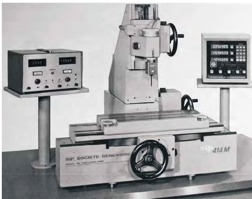
Rys. 9.8. Uniwersalna maszyna pomiarowa z cyfrową indykacją trzech współrzędnych SIP414M (Szwajcaria)
