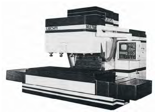
Rys. 4.38. Wielowrzecionowe centrum Multimill firmy „Liechti & Co” (Szwajcaria)
