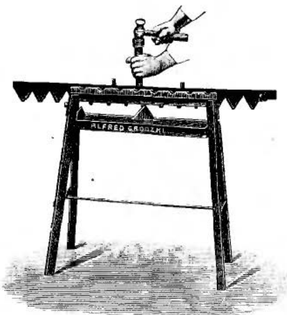
Ryc. 136. Zanitowywanie zmieniających nożyków.
