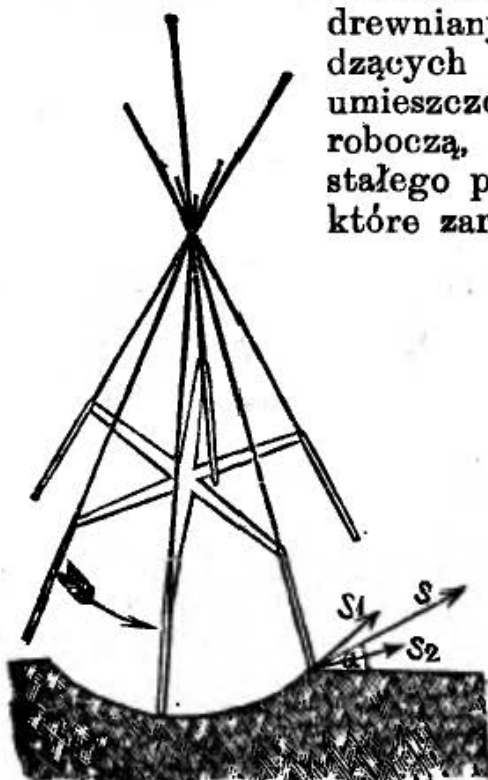
Ryc. 16. Schemat drążków w kopaczce Hardera.
