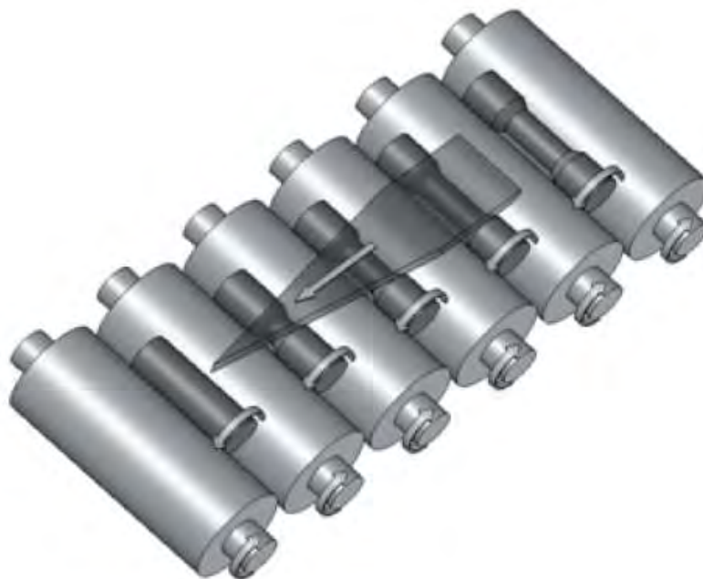
Rys. 2.21. Proces walcowania klinowo-rolkowego kilku wyrobów [41]
