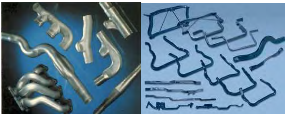
Rys. 2.15. Wyroby wykonane w procesie kształtowania hydrostatycznego [69]
