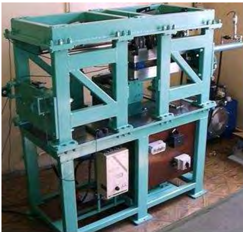
Rys. 2.24. Walcarka laboratoryjna LUW-2 przystosowana do walcowania klinowo-rolkowego [38]
