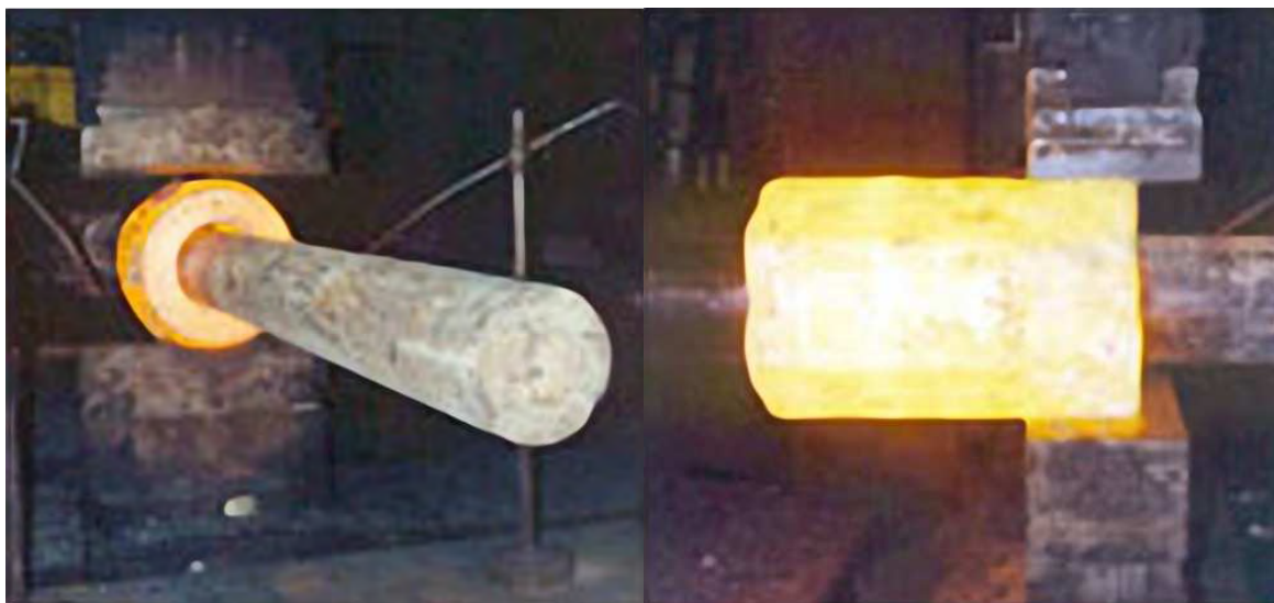
Rys. 2.11. Proces kucia wału drążonego [62]
