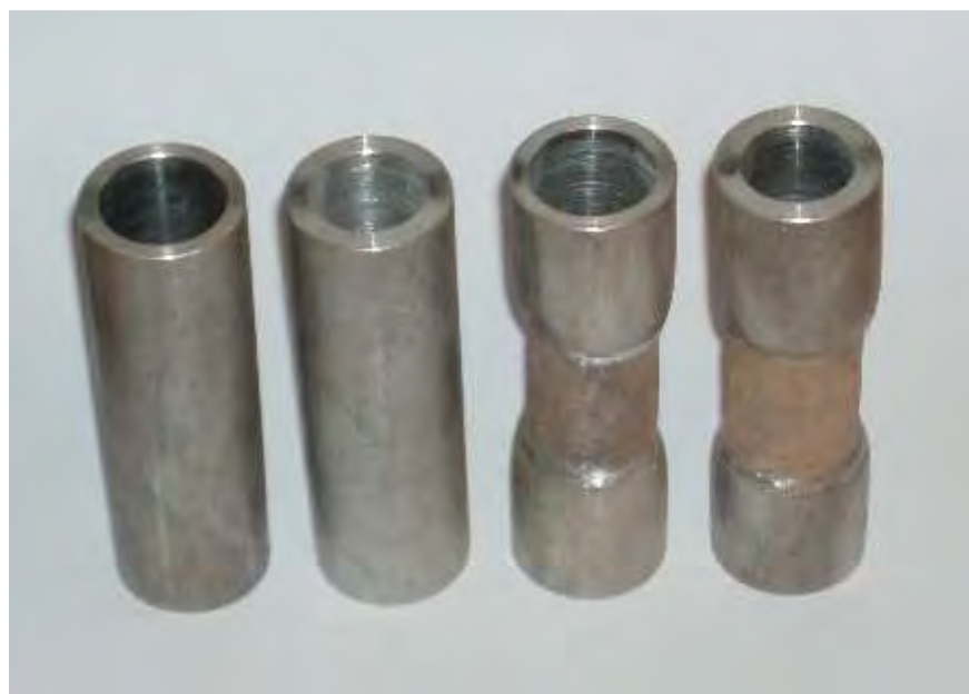
Rys. 5.15. Wsady drążone oraz ukształtowane wyroby wykonane ze stopu aluminium 6061
