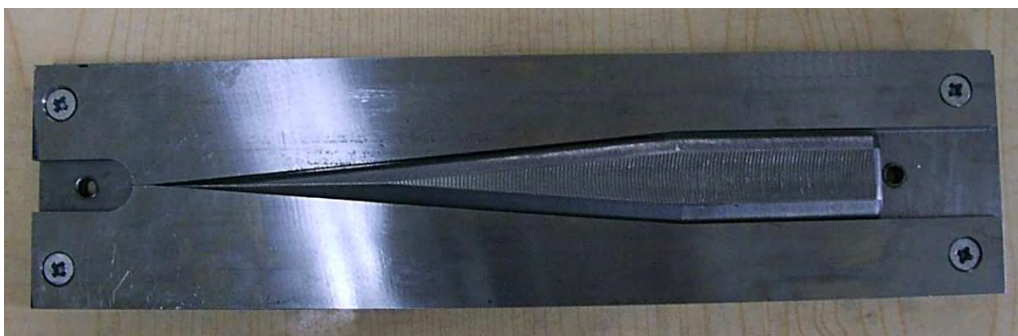
Rys. 2.26. Przykładowe narzędzie klinowe do procesu WKR na rolkach gładkich [38]
