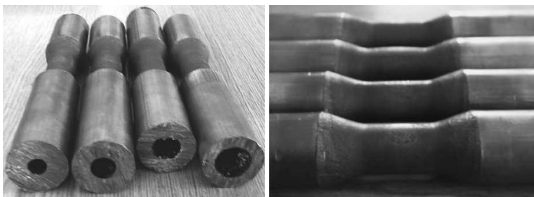
Rys. 2.18. Przykłady próbek drążonych wykonanych z ołowiu w gatunku Pb 1, odkształconych w procesie WPK [4]
