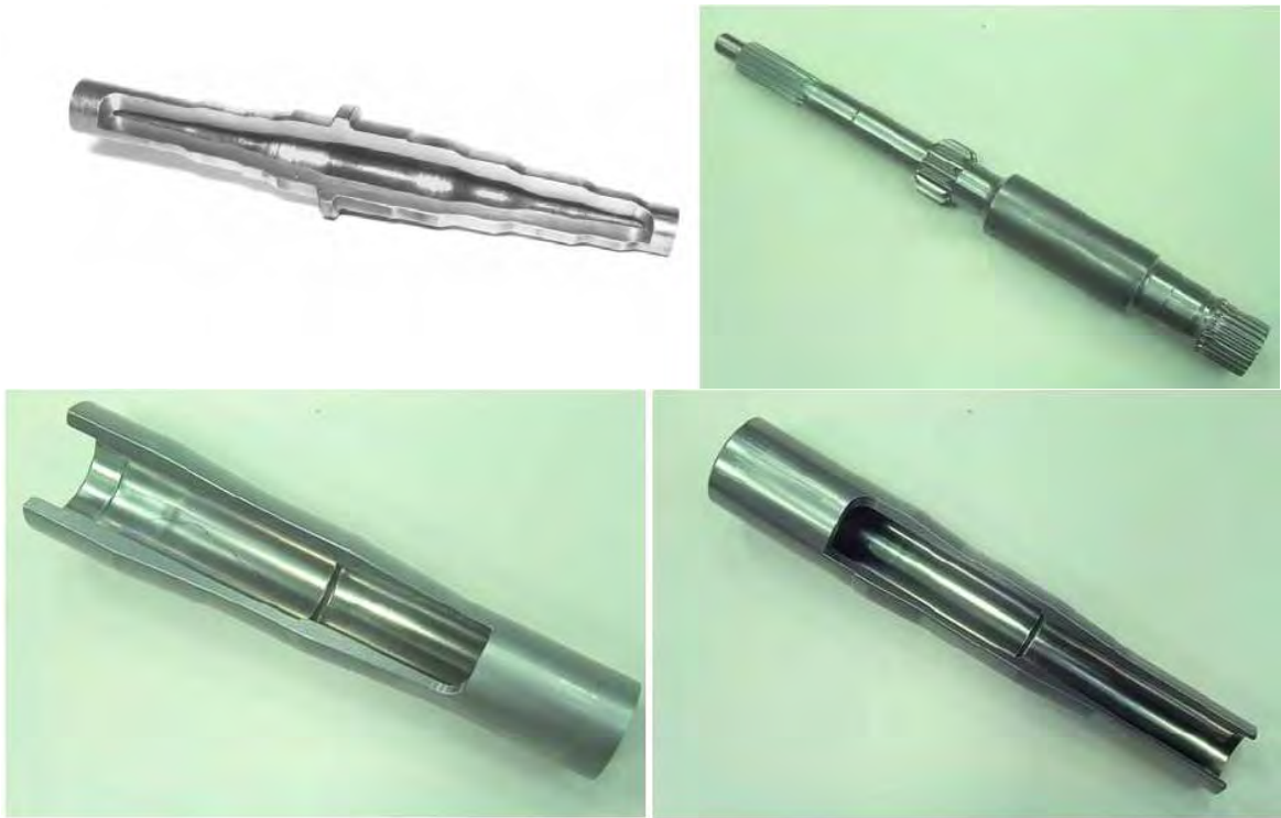
Rys. 2.12. Wałki drążone wykonane w procesie kowarkowym [65]
