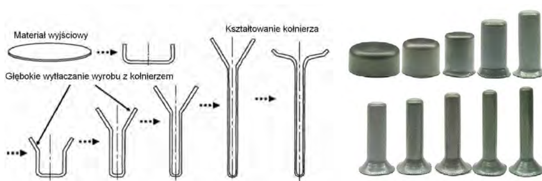
Rys. 2.3. Etapy wytwarzania zaworów drążonych [20]
