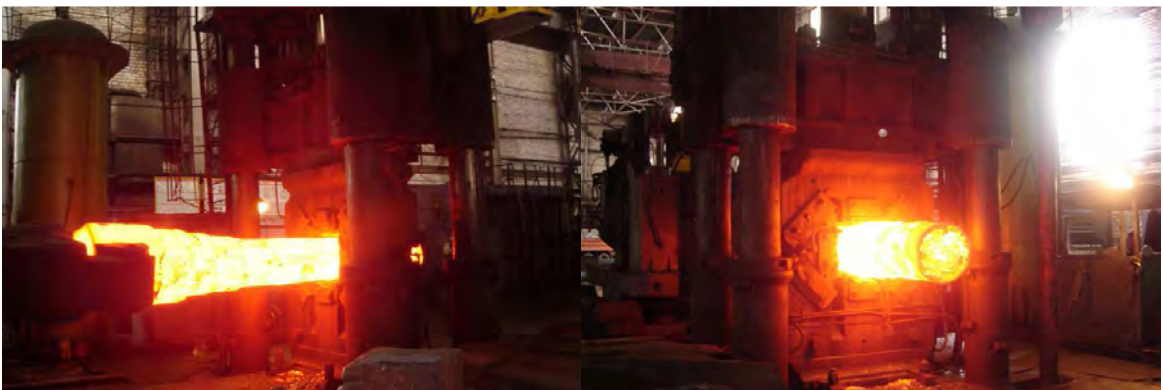
Rys. 2.13. Proces kucia obrotowego [24]
