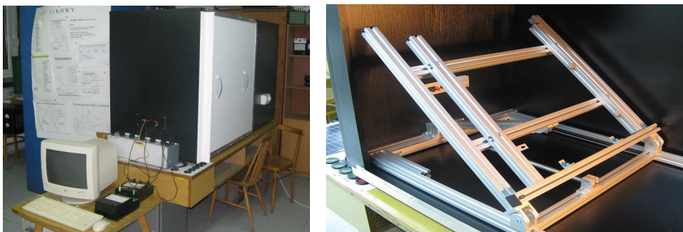
Rys. 12. Komora do badania paneli fotowoltaicznych
