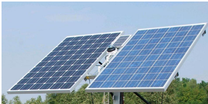
Rysunek 2.3.13. Panele oparte na modułach z ogniw krzemowych monokrystalicznych (po lewej) i polikrystalicznych (po prawej), ( http://www.poradnik.sunage.pl/ , 2014)
