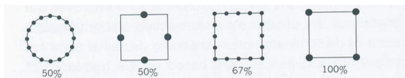
Rys. 4. Rozmieszczenie materiału w konstrukcji i efektywność rozwiązania [2]
