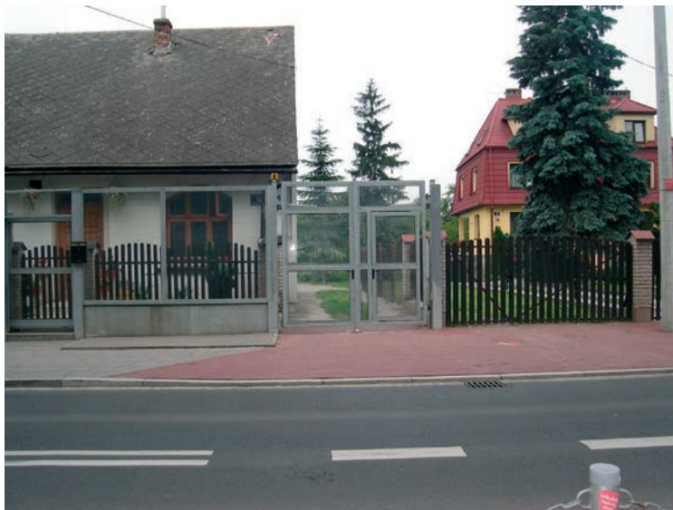
Fot. 2. Niezbyt skuteczne ekranowanie zabudowy usytuowanej zbyt blisko jezdni ( Q > 800 P/h)
