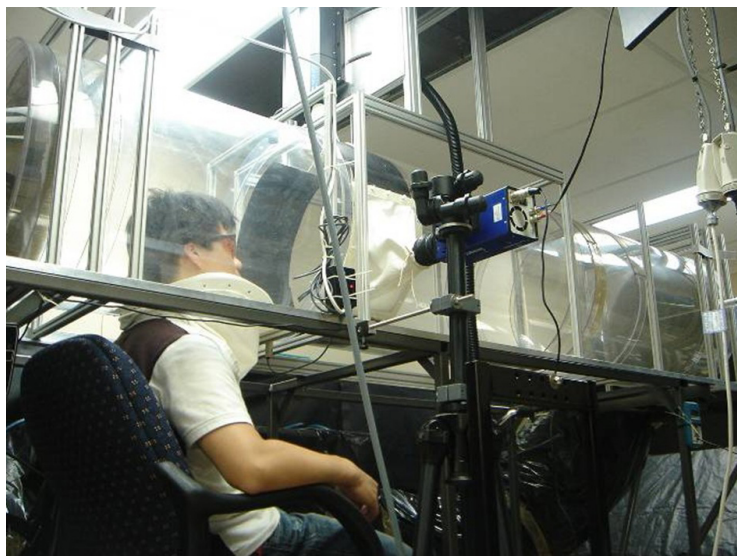
Ryc. 10. Eksperymentalny tunel pomiarowy do badań cząstek emitowanych przez ludzki układ oddechowy, zaprojektowany w 2005 r.
