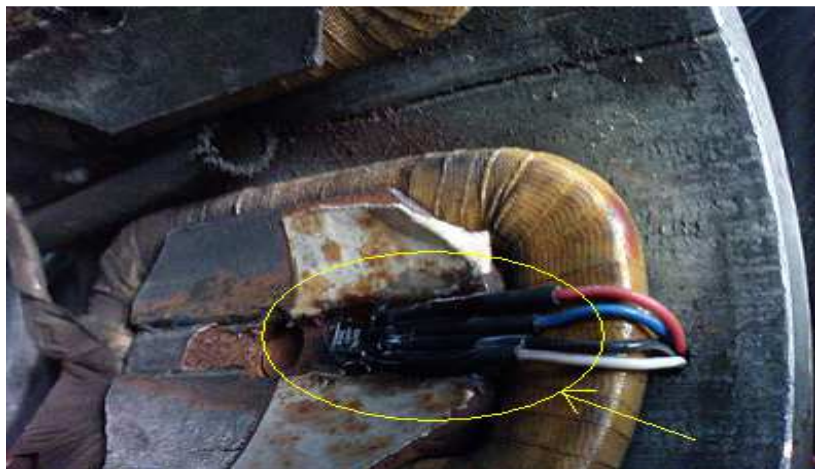
Rys. 8.11. Czujnik hallotronowy zamontowany na rdzeniu stojana rozrusznika E100
