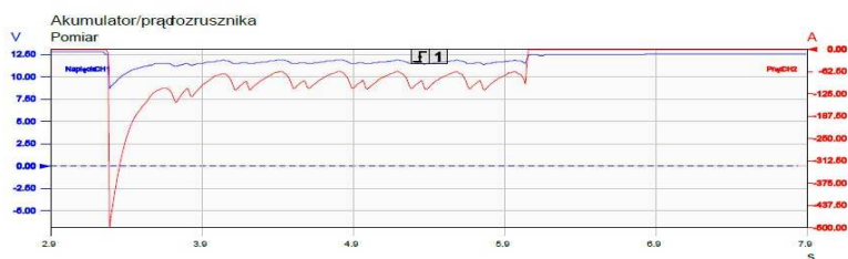
Rys. 11.16. Prąd rozrusznika przy temperaturze 80,1°C i wykręconej I i II świecy
