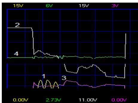
Rys. 9.10. Zestawienie charakterystyk 1 – n=f(t) , 2 – U=f(t) , 3 – I=f(t) , 4 – M=f(t) , podczas hamowania – rozrusznik sprawny, akumulator Q_2
