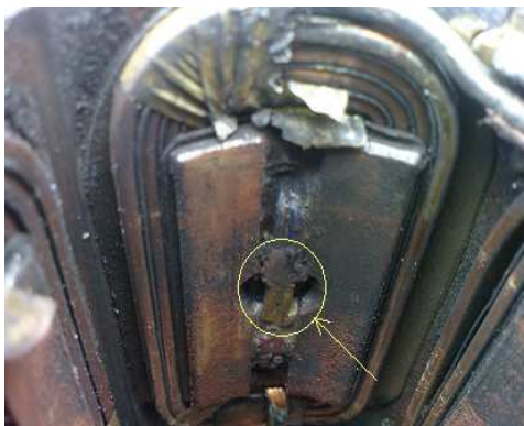
Rys. 8.12. Czujnik hallotronowy umieszczony na nabiegunkniku rozrusznika
