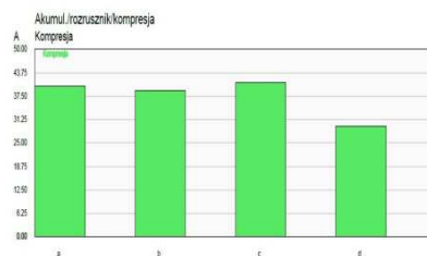
Rys. 11.26. Prąd rozrusznika przy temperaturze 25,2°C i wykręconej I i III świecy
