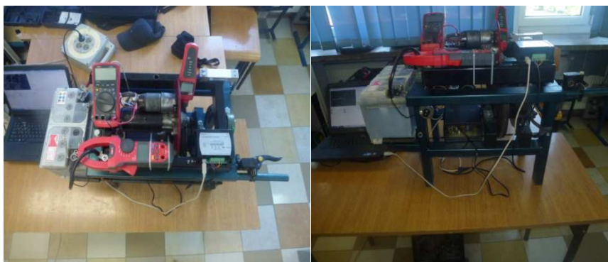
Rys. 9.1. Widok stanowiska do badań rozrusznika R76
