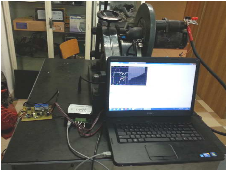
Rys. 9.19. Stanowisko do badania obwodu rozruchowego
