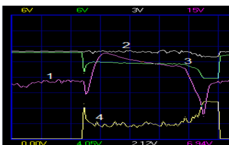
Rys. 9.25. Zestawienie charakterystyk 1 - n=f(t) , 2 - M=f(t) , 3 - U=f(t) , 4 - I=f(t) podczas hamowania rozrusznika dla tulejki (nr 2)
