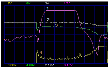
Rys. 9.28. Zestawienie charakterystyk 1 - n=f(t) , 2 - M=f(t) , 3 - U=f(t) , 4 - I=f(t) podczas hamowania rozrusznika dla zwiększonej rezystancji przewodu - R_{p2}
