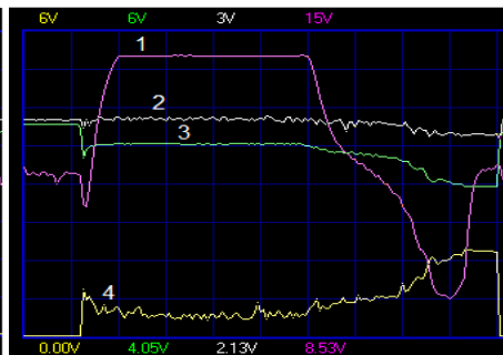
Rys. 9.33. Zestawienie charakterystyk 1 - n=f(t) , 2 - M=f(t) , 3 - U=f(t) , 4 - I=f(t) podczas hamowania rozrusznika dla \Delta U_{SZ2}
