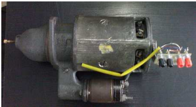
Rys. 8.14. Rozrusznik R5 z czujnikiem Halla
