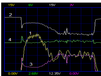
Rys. 9.4. Zestawienie charakterystyk 1 – n=f(t) , 2 – U=f(t) , 3 – I=f(t) , 4 – M=f(t) , podczas hamowania rozrusznika z zwiększoną rezystancją przewodu R_p , akumulator Q_1
