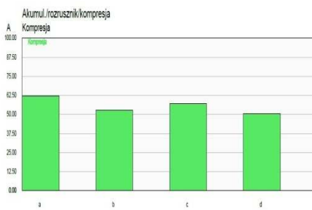
Rys. 11.22. Ciśnienie w cylindrach przy wkręconych wszystkich świecach i temperaturze 23,6^{\circ}\text{C}
