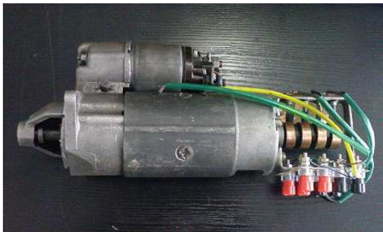
Rys. 8.10. Widok rozrusznika R76 z wyprowadzeniami z czujników hallotronowych
