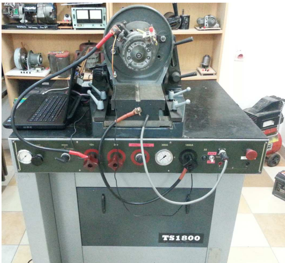
Rys. 9.18. Stanowisko do badań obwodów rozruchowych
