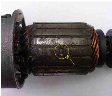
Rys. 8.13. Czujnik hallotronowy umieszczony na wirniku rozrusznika
