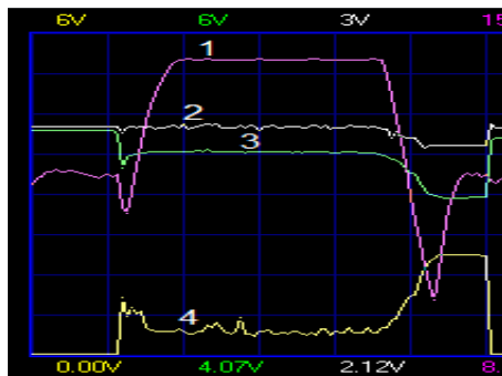
Rys. 9.21. Zestawienie charakterystyk 1 - n=f(t) , 2 - M=f(t) , 3 - U=f(t) , 4 - I=f(t) podczas hamowania rozrusznika (pomiar 2)
