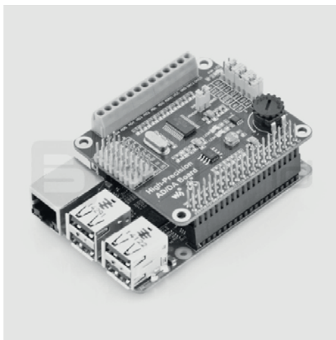
Rys. 6. Przetwornik analogowo cyfrowy (A/C) i cyfrowo analogowy (C/A) jako nakładka na mikrokomputer Raspberry Pi
