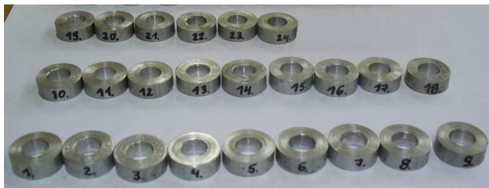
Rys. 2.12. Próbki pierścieniowe ze stopu magnezu Mg_4AlZn przygotowane do badań warunków tarcia
