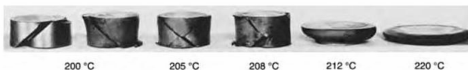
Rys. 3.1. Wpływ temperatury procesu spęczania na kruchość stopu AZ61 (Mg-Al6-Zn) [9]
