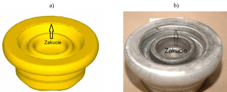
Rys. 5.42. Zakucie w odkuwce wykonanej przy zbyt małym spęczeniu wsadu: a) wyniki symulacji, b) wyniki doświadczalne [67, 77]
