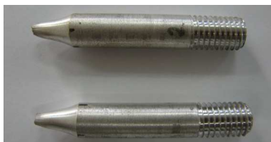
Rys. 2.25. Widok próbek ze stopu \text{Mg}_4\text{AlZn} zerwanych w próbie rozciągania na symulatorze Gleeble 3800
