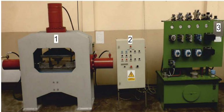
Rys. 4.13. Trójsuwakowa prasa kuznicza; 1 – część mechaniczna, 2 – szafa sterownicza, 3 – hydrauliczny układ zasilający
