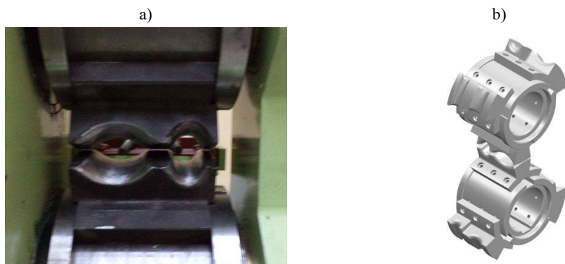
Rys. 5.20. Segmenty walcujące: a) użyte w badaniach, b) model 3D [134, 135]
