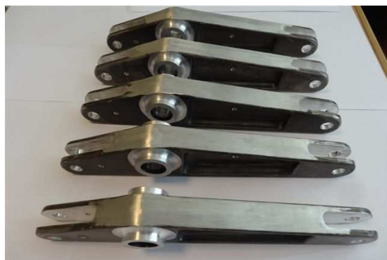
Rys. 5.12. Gotowe dźwignie ze stopu AZ31 [72]
