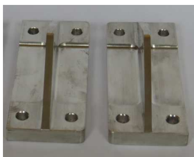
Rys. 4.25. Przykładowe wyroby wykonane z odkuwek ze stopu AZ31 [33]
