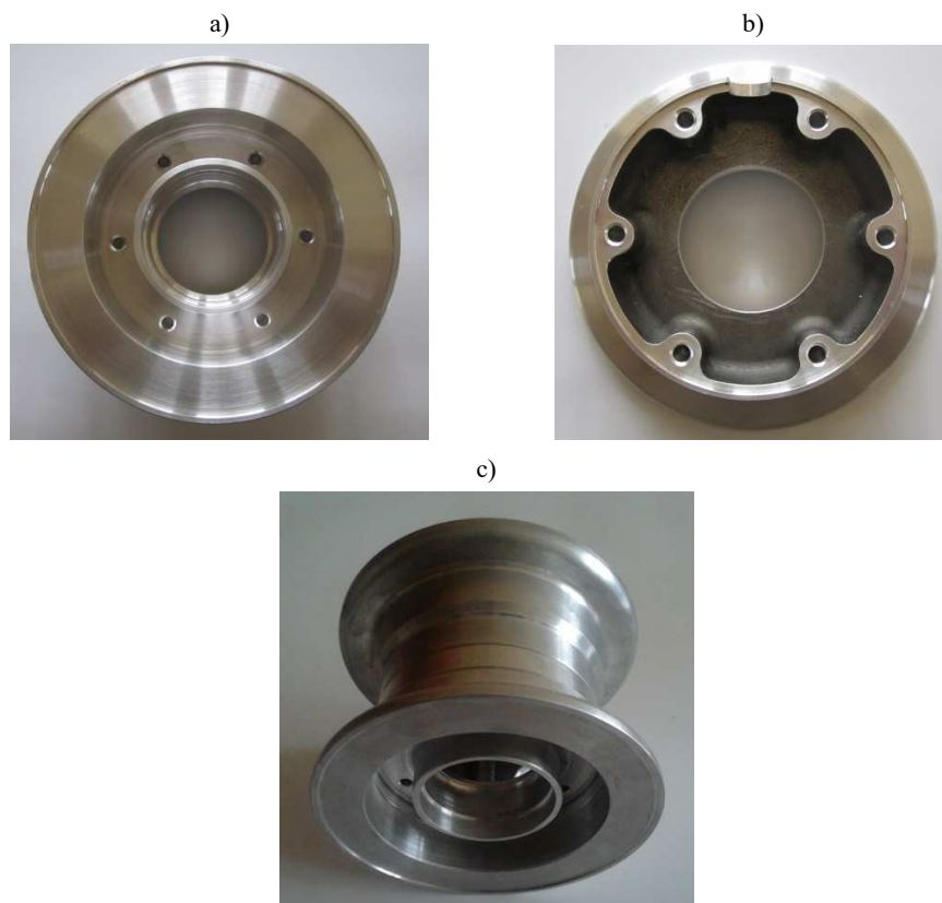
Rys. 5.45. Gotowe wyroby ze stopu AZ31: a) widok półpiasty od góry, b) widok półpiasty od dołu, c) kompletna piasta [67]
