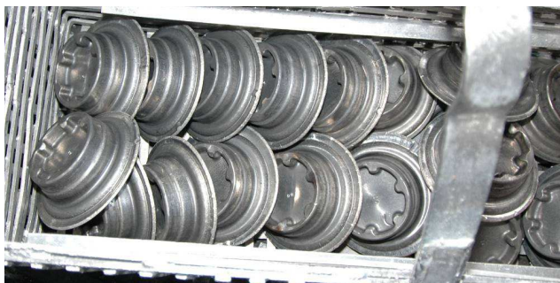
Rys. 5.44. Seria próbna odkuwek półpiasty ze stopu AZ31 [64]
