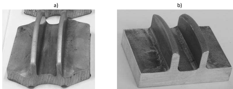
Rys. 4.30. Odkuwki z dwoma żebrami ze stopu AZ31 uzyskane metodą kucia: a) półswobodnego, b) w wykroju zamkniętym [33, 44]
