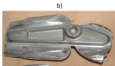
Rys. 5.24. Kształt wyrobów z wypływką po operacji kucia wstępnego z wsadu w postaci: a) walcowanej przedkuwki, b) pręta [64]
