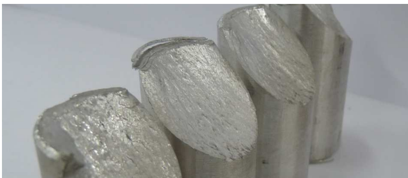
Rys. 2.19. Przykład złomu poślizgowego powstałego przy spęczaniu próbki ze stopu magnezu Mg_4AlZn
