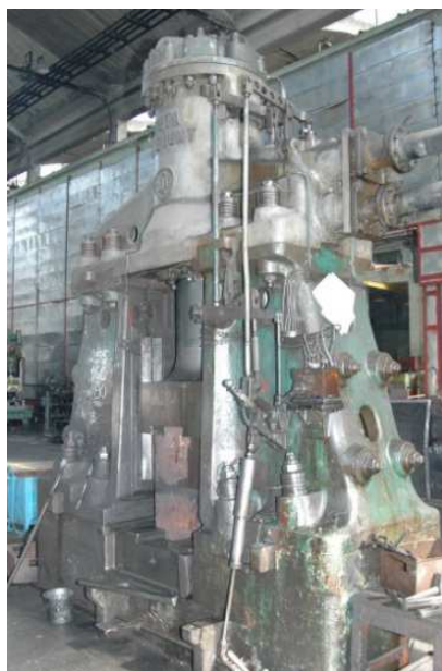
Rys. 5.37. Fotografia młota matrycowego parowo-powietrznego MPM 10000B o energii uderzenia 110 kJ
