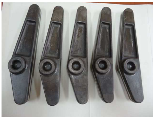
Rys. 5.11. Seria próbna odkuwek dźwigni ze stopu AZ31 [72]
