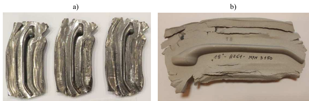
Rys. 5.51. Odkuwki klamki ze stopu AZ61A uzyskane w procesie kucia: a) na prasie śrubowej, b) na młocie [25]
