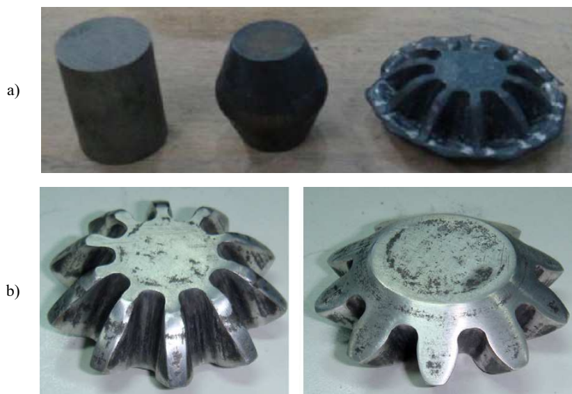
Rys. 4.8. Etapy kucia (a) i gotowy wyrób (b) koła zębatego ze stopu AZ31B [115]
