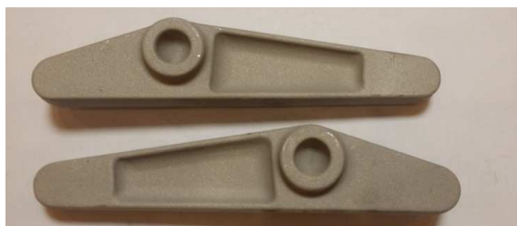
Rys. 5.23. Odkuwki dźwigni ze stopu AZ31 uzyskane w procesie kucia z przedkuwki wykonanej metodą walcowania wzdłużnego [64]
