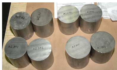
Rys. 5.38. Próbki zastosowane do kucia odkuwki półpiasty ze stopów: AZ31, AZ61, AZ80, WE43
