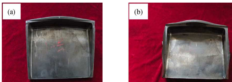
Rys. 4.10. Gotowe wyroby wykonane z użyciem nacisku równego: a) 18 MN, b) 25 MN [154]
