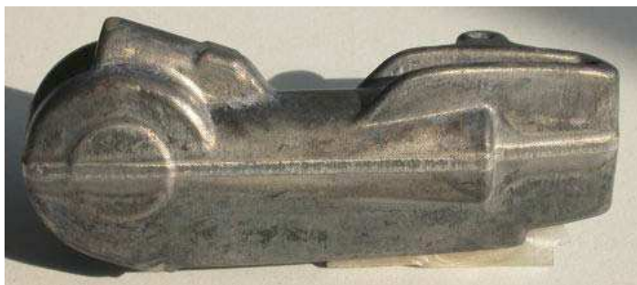
Rys. 3.2. Odkuwka części rowerowej ze stopu AZ80A wykonana przez firmę Leiber [145]
