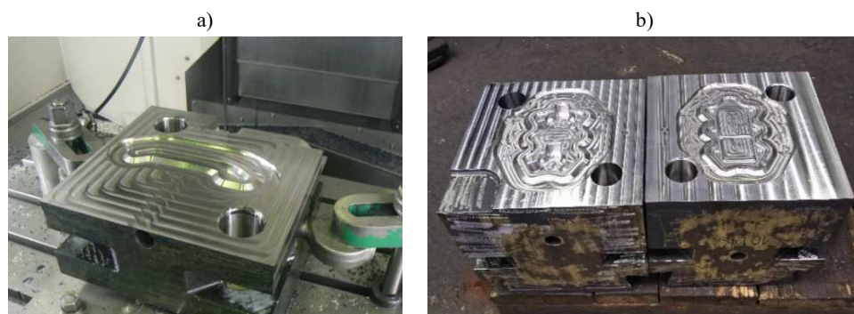
Rys. 5.49. Matryce w trakcie obróbki mechanicznej: a) do kucia odkuwki klamki, b) do kucia odkuwki wspornika [25]
