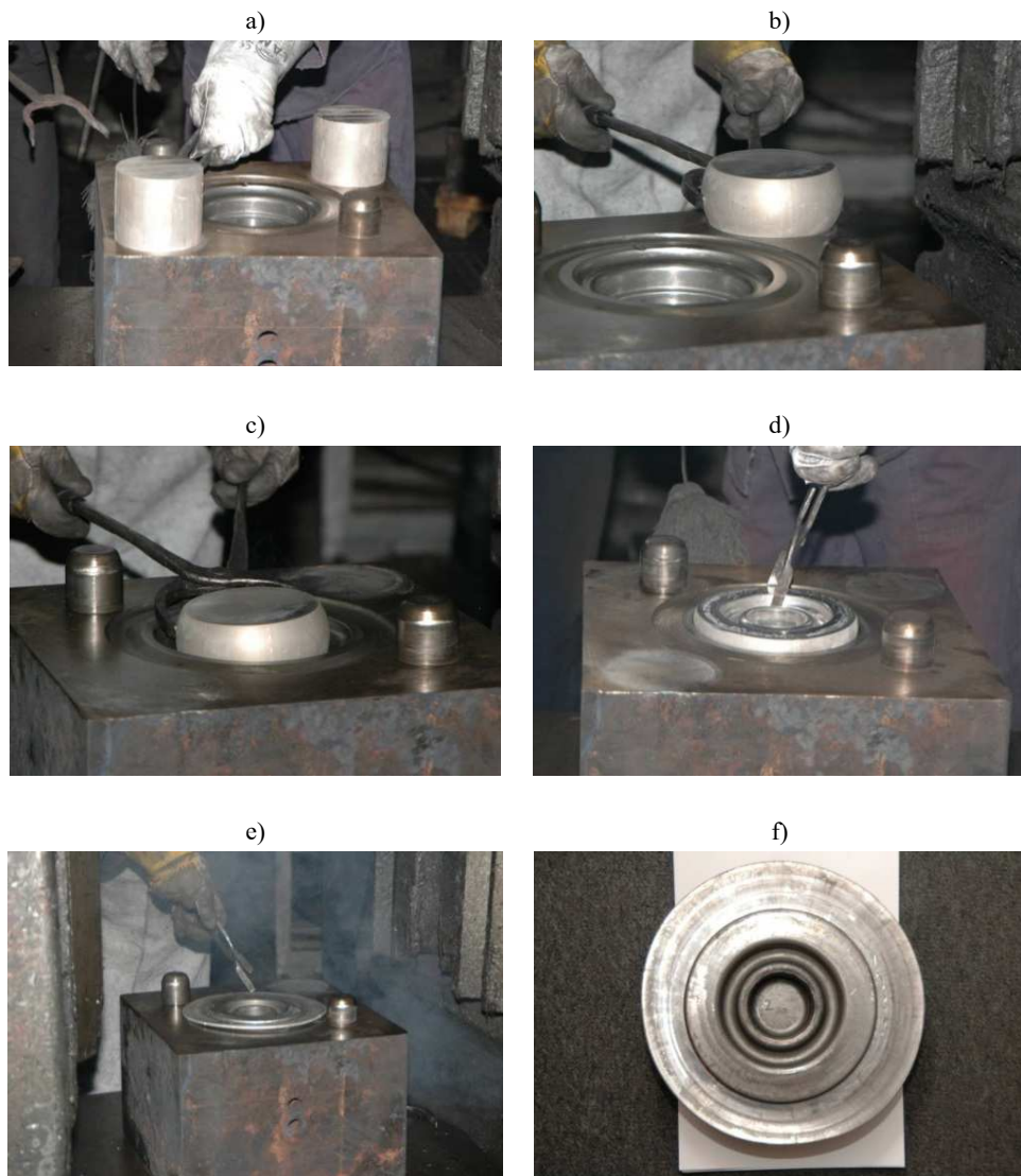
Rys. 5.39. Kolejne czynności w procesie kucia: a) ułożenie wsadu na boku matrycy przed spęczaniem, b) koniec operacji spęczania, c) ułożenie spęczki w wykroju przed kuciem wstępnym, d) koniec operacji kucia wstępnego, e) koniec operacji kucia matrycującego, f) przykładowa odkuwka z wypływką [64]
