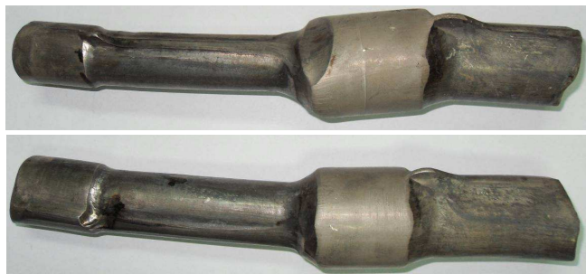
Rys. 5.22. Przedkuwki ze stopu AZ31 uzyskane w procesie walcowania wzdłużnego [17, 66, 135]
