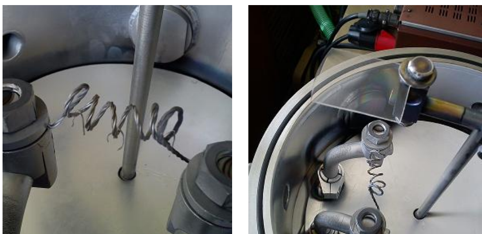
Rys. 12.2. Wnętrze komory próżniowej napyłarki NAL-301: po lewej - grzejnik wolframowy z zawieszonymi skrawkami aluminium, po prawej - sposób mocowania płytki z tworzywa nad źródłem naporowywanego metalu
