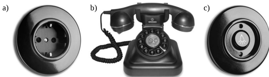
Rys. 30. Przykłady przedmiotów wykonanych z tworzyw fenolowych metodą prasowania wysokociśnieniowego tłocznego lub przetłocznego: a) gniazdo elektryczne, b) telefon, c) ścienny włącznik elektryczny [3]
