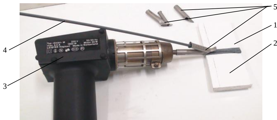
Rys. 1.1. Wygląd palnika do spawania gorącym powietrzem oraz fragment elementów łączonych wraz ze spoiną: 1, 2 - elementy spawane, 3 - korpus palnika elektrycznego, 4 - pręt spawalniczy, 5 - wymienne dysze spawalnicze
