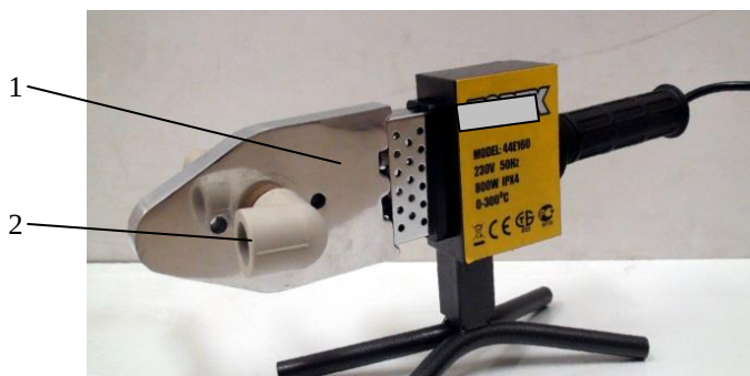
Rys. 3.5. Wygląd urządzenia do zgrzewania: 1- płyta grzejna, 2 - złączka tzw. „kolanko”
