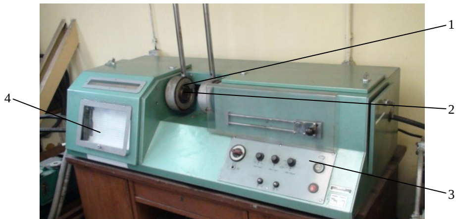
Rys. 58. Wygląd plastografometru Mooney'a do badania wulkanizacji gumy: 1- komory pomiarowo-grzejne, 2 - miejsce mocowania wirnika, 3 - układ napędowy, 4 - układ rejestrujący
