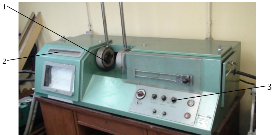
Rys. 13.1. Wygląd plastografometru Mooney'a do wulkanizacji gumy: 1- komora pomiarowa, 2 - układ pomiaru momentu obrotowego i rejestracji, 3 - układ regulacji temperatury
