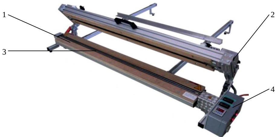
Rys. 2.1. Wygląd ogólny zgrzewarki rezystancyjnej: 1 - rama nieruchoma, 2 - rama ruchoma, 3 - element grzejny - listwa, 4 - układ sterownia temperatury i czasu zgrzewania
