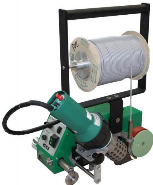
Rys. 3. Wygląd ogólny urządzenia do spawania automatycznego [15]
