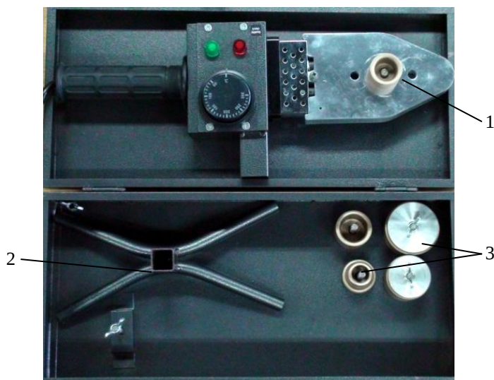
Rys. 3.2. Wygląd urządzenia do zgrzewania 44E160 z płytą grzewczą wraz z dodatkowym wyposażeniem: 1 - korpus zgrzewarki z płytą grzejną, 2 - podstawa, 3 - wymienne tuleje kształtowe
