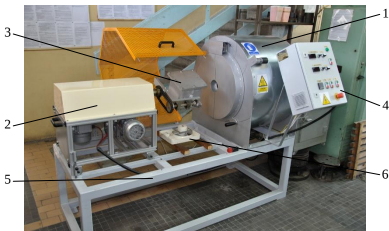
Rys. 10.1. Wygląd ogólny laboratoryjnego urządzenia do odlewania planetarnego tworzyw: 1 - układ grzewczy, 2 - układ rotacyjny, 3 - forma odlewnicza, 4 - układ sterowania i regulacji, 5 - podstawa, 6 - wentylator
