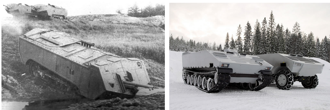
Rys. 13. Pojazdy o napędzie spalinowo-elektrycznym: a) francuski czołg St. Chamond - 1916 rok, b) szwedzki pojazd SEP w wersji kołowej i gąsienicowej –2008 rok
