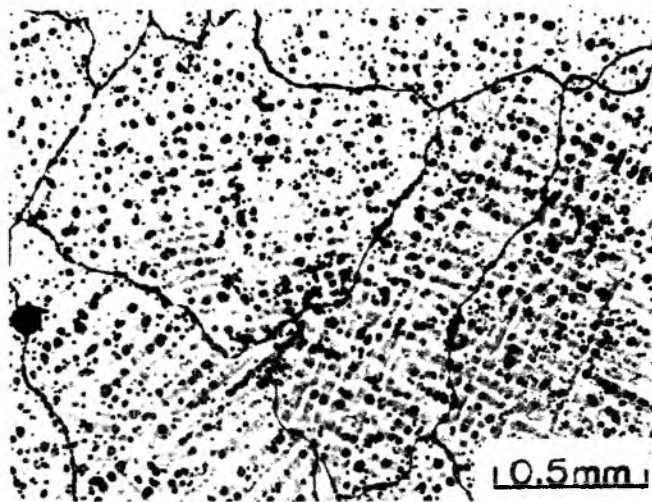
Rys. 3.3. Mikrostruktura stopu typu Vitallium po przesycaniu; czerw. kwasem szczawiowym [19]
