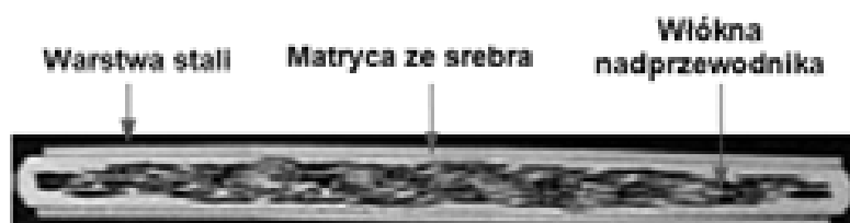
Rys.10 Przekrój taśmy nadprzewodnikowej dla uzwojeń elektromagnesu nadprzewodnikowego zasobnika energii.
