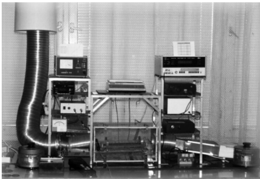
Eksperymentalna konstrukcja komory suszarniczej do suszenia konwekcyjnego ze wspomaganie wiatru jonowego (Projekt badawczy KBN: PB 397/P06/96/11)
