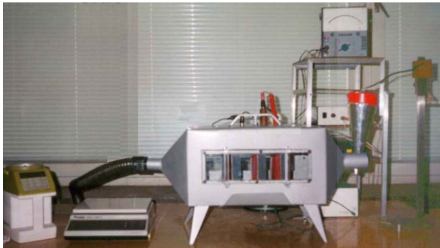
Półtechniczne wykonanie komory filtrującej z filtrami bifilarnymi (Projekt badawczy KBN: PB 0391/P06/99/17)
