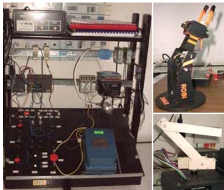
Stanowisko dydaktyczne sterowania logicznego oraz modele fizyczne manipulatorów
