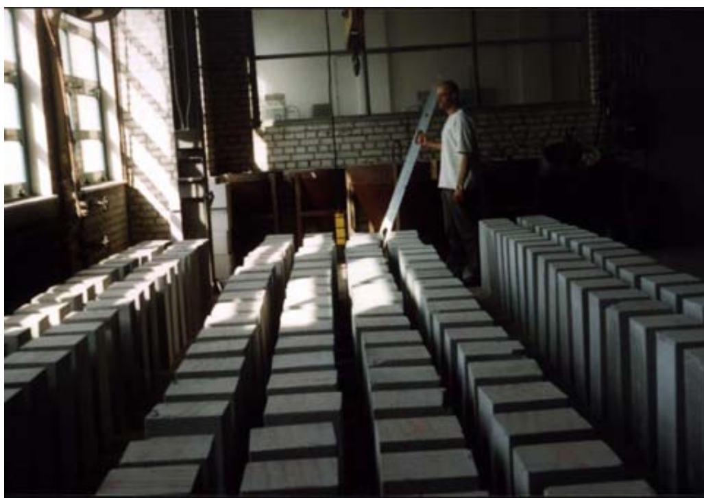
Rys. 4.2.6-1 Suszenie (sezonowanie) elementów murowych z betonu komórkowego przed wmurowaniem
