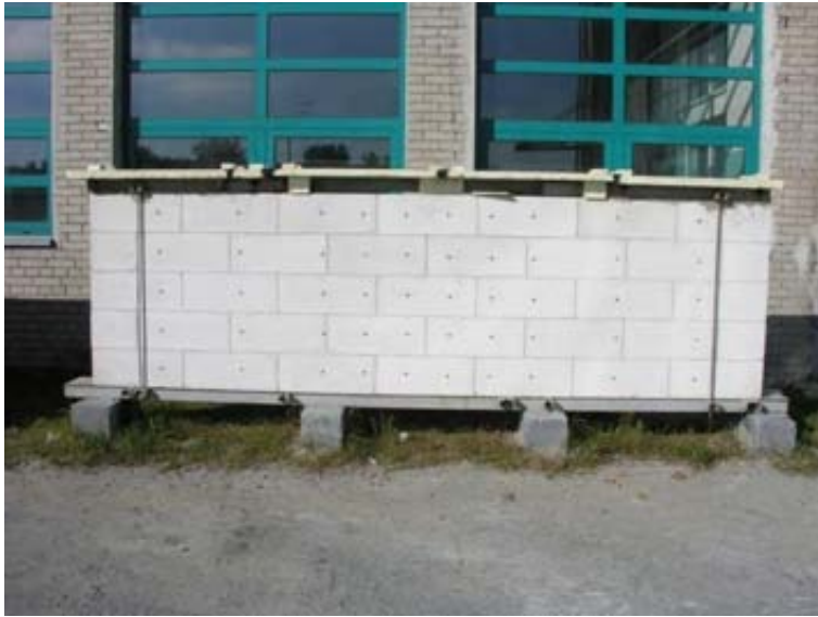
Rys. 4.2.7-5 Rozmieszczenie siatki reperów na jednym z murów badawczych
