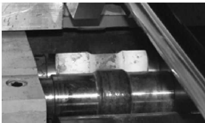
Rys. 4.49. Próbką ze stali 45 po walcowaniu na gorąco, realizowanym zgodnie ze schematem 5 (rys. 3.14)
