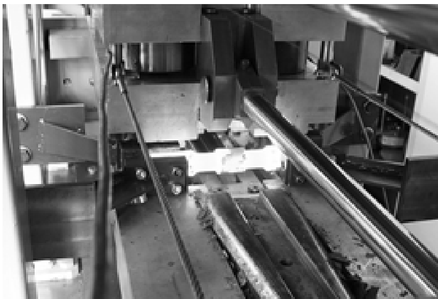
Rys. 4.15. Walcowanie poprzeczno-klinowe na gorąco wyrobu ze stali 45, w walcarce laboratoryjnej LUW-2 [114]
