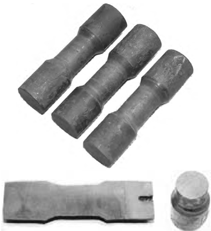
Rys. 4.50. Próbki ze stali 45, w widoku i przekrojach, ukształtowane w procesie WKR wg schematu 5 (rys. 3.14)
