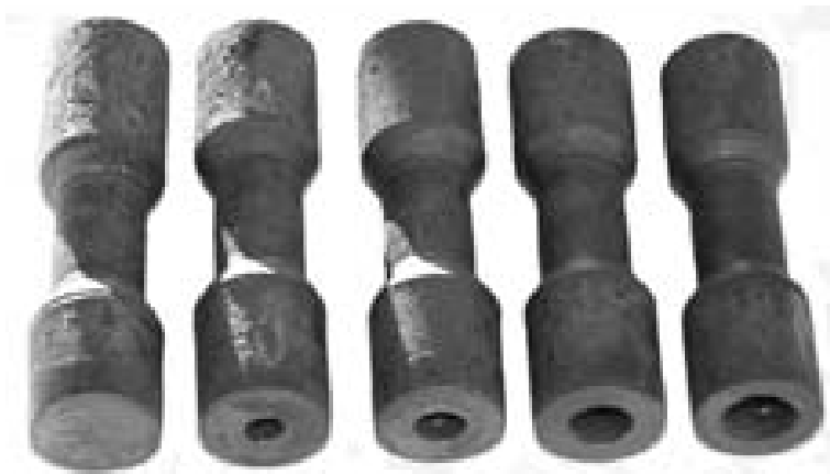
Rys. 4.52. Przykłady próbek ze stali 45 odwalcowanych w procesie WKR przy: \alpha=30^\circ , \beta=5^\circ , d_0=25 mm, d=17,2 mm, h_R=h_K=5 mm oraz licząc od prawej d_n wynoszącym 15,0 mm, 12,5 mm, 10,0 mm i 7,5 mm
