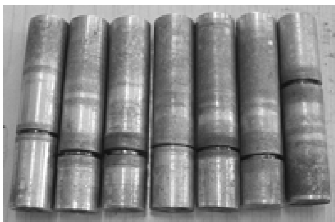
Rys. 4.37. Widok próbek, z aluminium A0, z odwalcowanym na zimno rowkiem klinowym przy różnym \Delta r oraz \alpha=60^\circ
