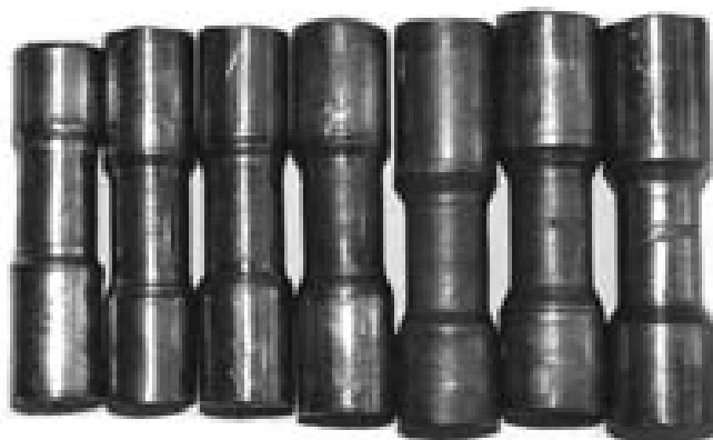
Rys. 4.44. Próbki z ołowiu Pb1 odwalcowane w procesach WKR na rollkach profilowych (przy h_R=h_K=3 mm) z materiału wyjściowego o średnicach w mm: \varnothing 22,0 ; \varnothing 22,5 ; \varnothing 23,0 ; \varnothing 23,5 ; \varnothing 24,0 ; \varnothing 24,7 ; \varnothing 25,8 ; \varnothing 26,4 (licząc od lewej)
