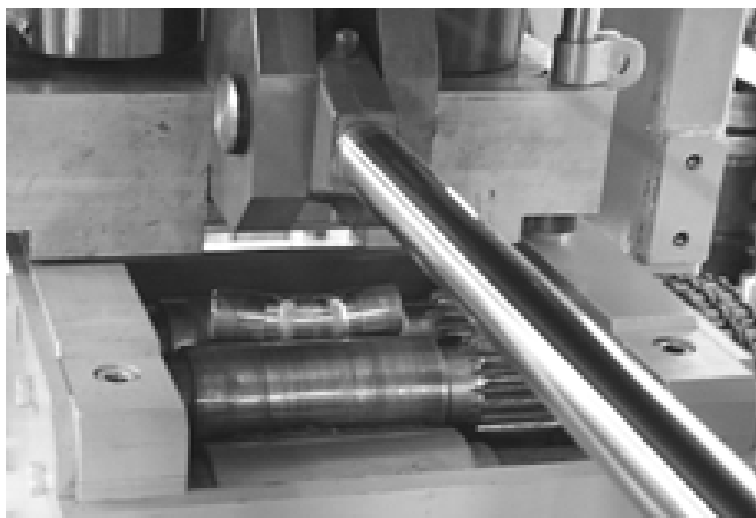
Rys. 4.23. Wyrób odwalcowany w procesie WKR, przeprowadzonym wg schematu 1 (rys. 3.10)
