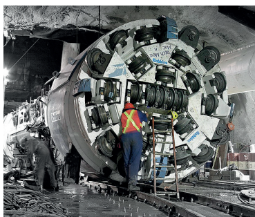
Rys. 2. Maszyna tunelowa typu TBM z dyskami symetrycznymi (a), maszyna tunelowa firmy WIRTH wyposażona w „podcinające” dyski asymetryczne (b).
