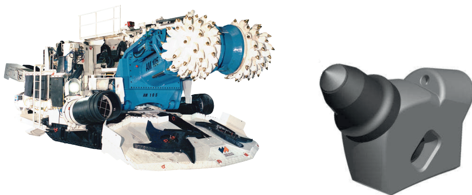
Rys. 1. Kombajn chodnikowy wyposażony w głowicę urabiającą zbrojoną stycznymi nożami obrotowymi.
