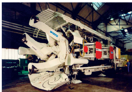
Rys. 2. Maszyna tunelowa typu TBM z dyskami symetrycznymi (a), maszyna tunelowa firmy WIRTH wyposażona w „podcinające” dyski asymetryczne (b).
