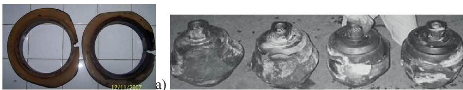
Rys.15. Efekty przyspieszonego zużycia dysków, wskutek dużej zmienności właściwości fizycznych i mechanicznych skał: a) wg. [4] , b) wg. [49].
