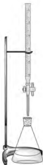
Rys. 8.2. Zestaw do miareczkowania z biuretą zwykłą i automatyczną Pelleta
