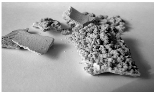
Fot. 11.1. Kamień kotłowy z rurek wymiennika ciepła
