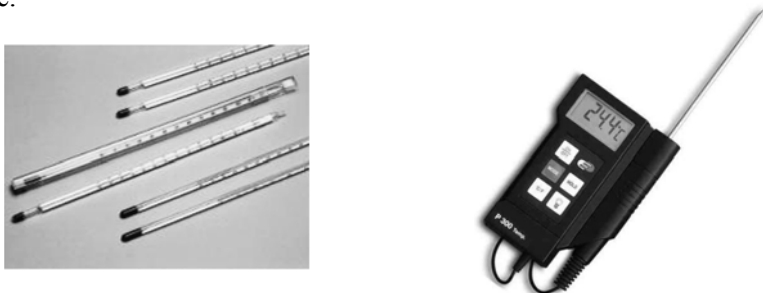
Fot. 4.9. Termometry cieczowe i elektroniczny
