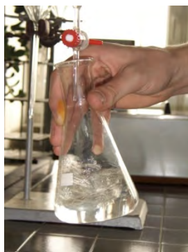
Fot. 12.1. Próbkę chlorków w trakcie miareczkowania i po zmianie zabarwienia w punkcie równoważnikowym.
