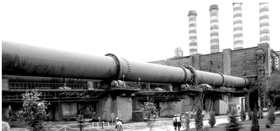
Fot. 10.1. Piece do wypalania cementu metodą mokrą
