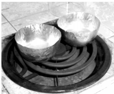
Fot. 6.1. Roztworzenie próbek cementu w \text{HClO}_4 i w HF w parownicach platynowych
