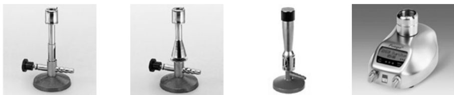
Fot.4.6. Palniki laboratoryjne: Bunsena, Teclu, Mekera – Fishera, Fuego SCS sterowany elektronicznie
