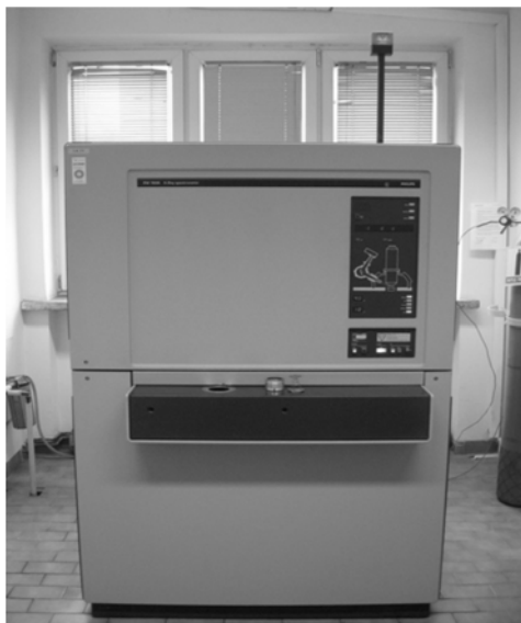
Fot. 10.2. Fluoroscencyjny spektrometr rentgenowski XRF z dyspersją długości fali do badania składu stałych próbek cementowych w laboratorium cementowni Chełm
