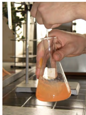
Fot. 12.1. Próbkę chlorków w trakcie miareczkowania i po zmianie zabarwienia w punkcie równoważnikowym.
