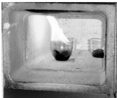
Fot.6.3. Spalanie sączków z osadem siarczanów w piecu elektrycznym
