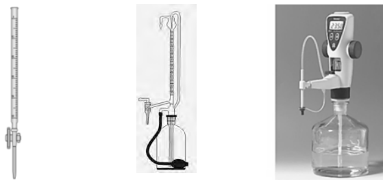
Fot. 4.2. Biurety: klasyczna, Pelleta, elektroniczna
