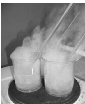
Fot. 6.1. Roztworzenie próbek cementu w \text{HClO}_4 i w HF w parownicach platynowych
