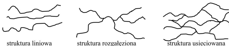
Rys. 15.4. Przykłady budowy polimerów
