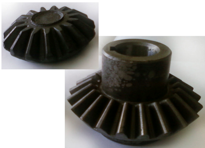
Rys. 4.1. Przykładowe stożkowe koła zębate o module 4,25 mm, które uzyskano stosując tradycyjny sposób kucia matrycowego – stan po obróbce wykańczającej
