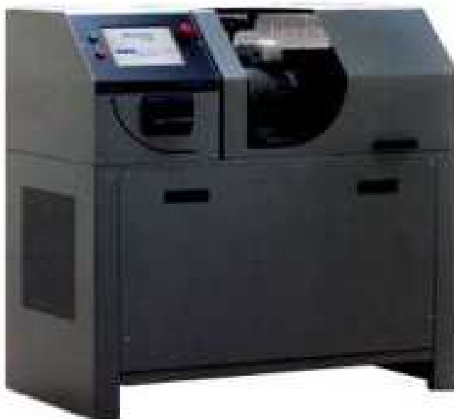
Rys.3.11. Stanowisko do badania rozruszników TOPAZ
