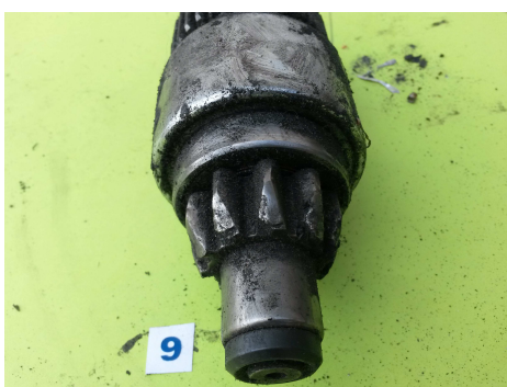
Rys.5.20. Uszkodzenia mechanizmu sprzęgającego – zużycie zębniaka
