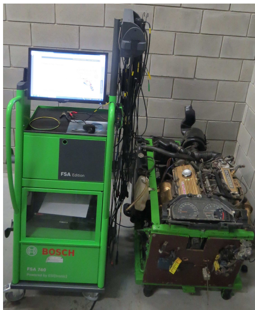
Rys. 26. Stanowisko badawcze z silnikiem Mitsubishi
