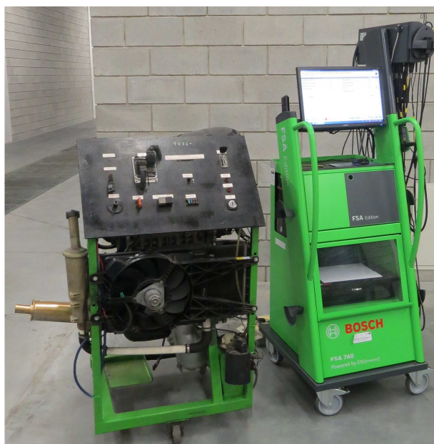
Rys. 16. Stanowisko badawcze z silnikiem Fiat Bravo
