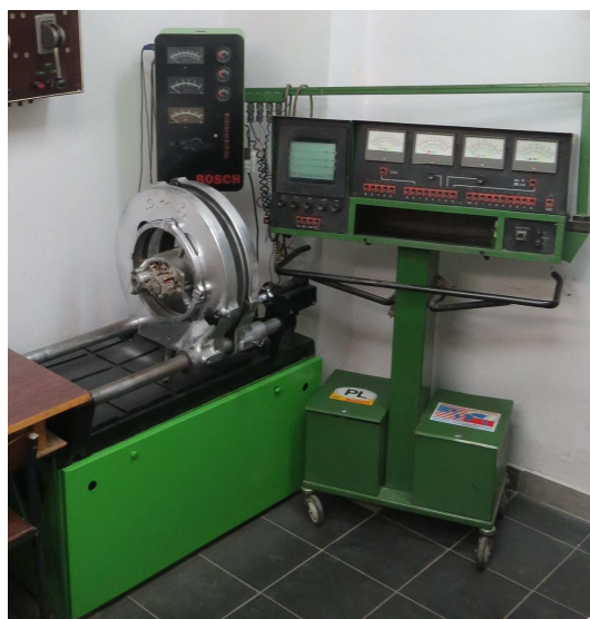
Rys. 4. Stanowisko do badań rozruszników firmy Bosch
