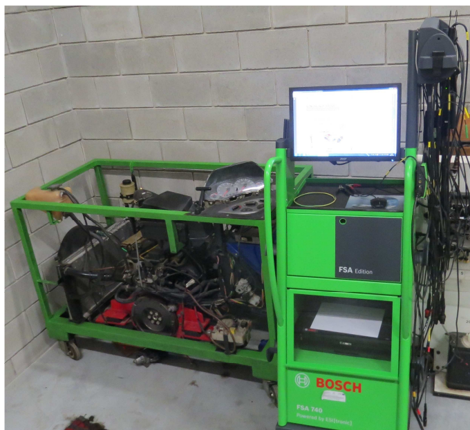
Rys. 27. Stanowisko badawcze z silnikiem Forda Focusa
