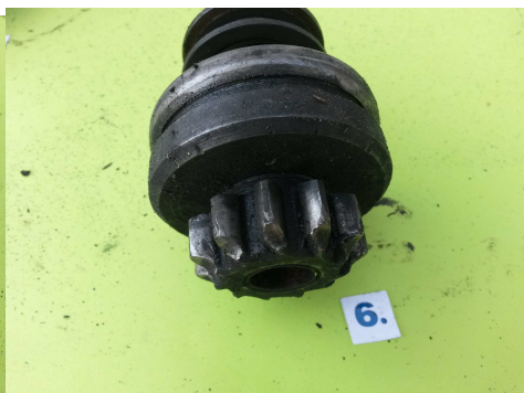
Rys.5.20. Uszkodzenia mechanizmu sprzęgającego – zużycie zębniaka
