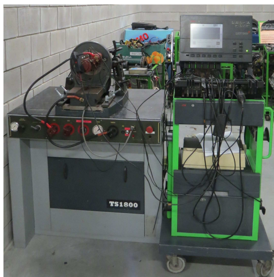
Rys. 2. Stanowisko do badań rozruszników TS 1800
