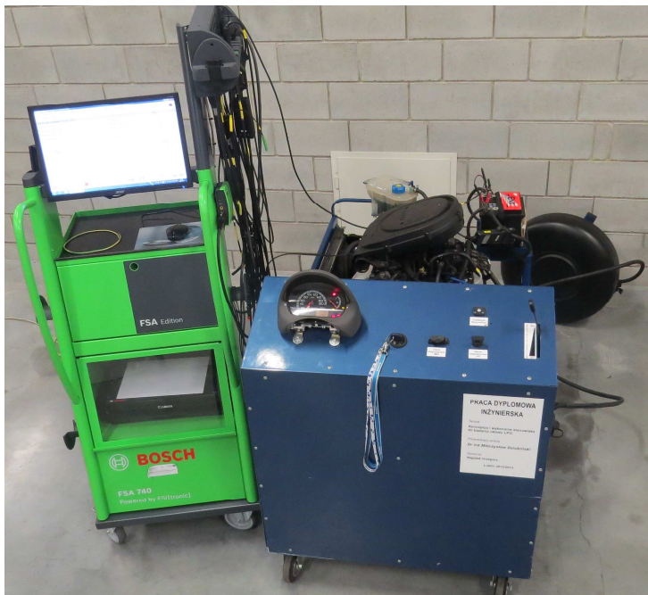
Rys. 22. Stanowisko badawcze z silnikiem Fiat Seicento, wtrysk Magneti Marelli
