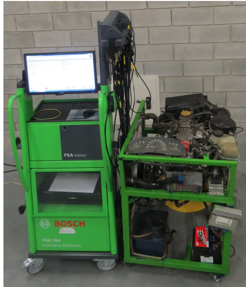
Rys. 23. Stanowisko badawcze z silnikiem Opel, wtrysk wielopunktowy Multec
