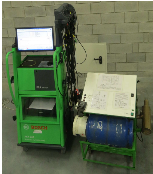
Rys. 24. Stanowisko badawcze z silnikiem Fiat, wtrysk Multec, LPG
