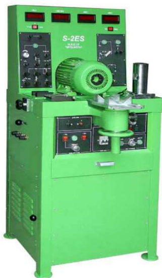
Rys.3.8. Stanowisko do badania rozruszników S – 2ES
