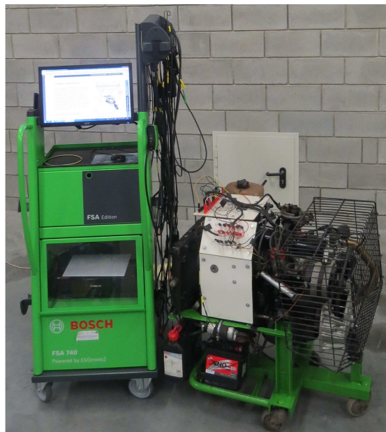
Rys. 25. Stanowisko badawcze z silnikiem Renault, wtrysk jednopunktowy Bosch Mono Jetronic
