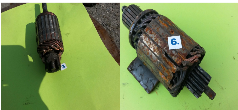
Rys. 5.14. Uszkodzenie wirnika w postaci skorodowania
