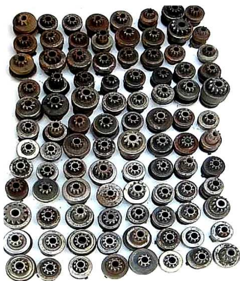
Rys. 5.18. Uszkodzenia mechanizmu sprzęgającego – typowe zużycie zębniaków
