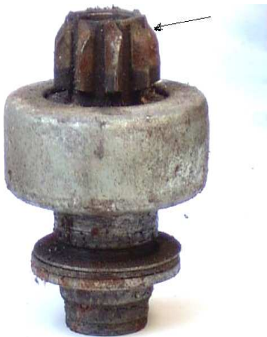
Rys. 5.19. Uszkodzenia mechanizmu sprzęgającego – zużycie zębów
