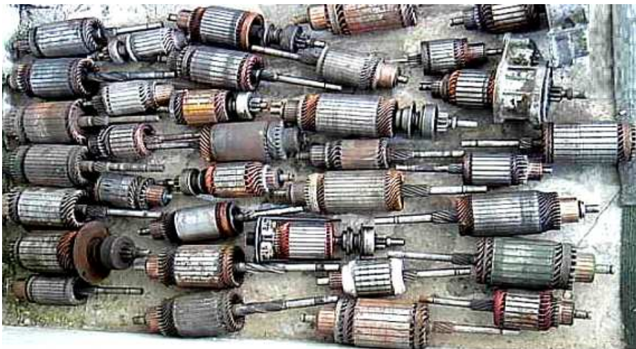
Rys. 5.11. Mechaniczne i elektryczne uszkodzenia wirników
