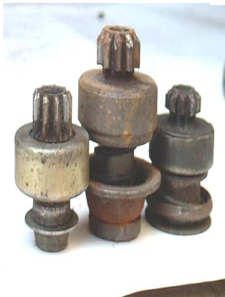
Rys. 5.18. Uszkodzenia mechanizmu sprzęgającego – typowe zużycie zębniaków
