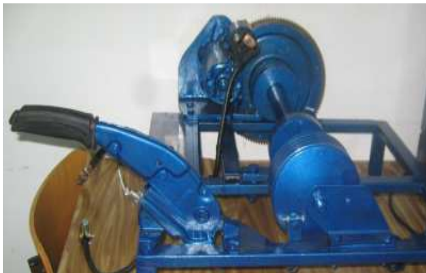
Rys. 8. Stanowisko do badań rozruszników D4 opracowane przez autora
