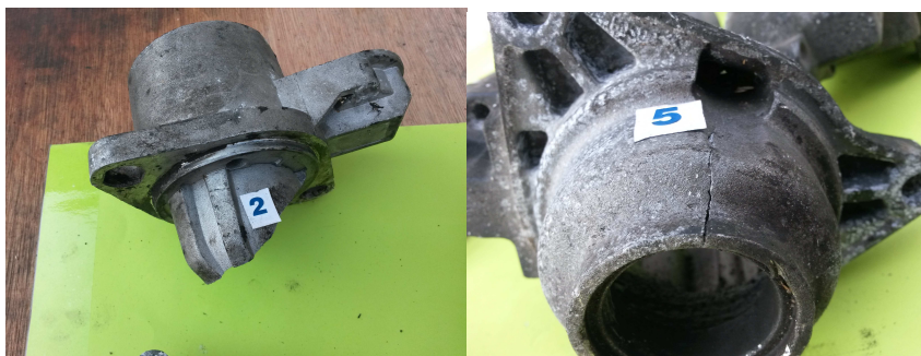
Rys. 5.10. Uszkodzenia głowicy rozrusznika w postaci wyłamania (2) i pęknięcia (5)
