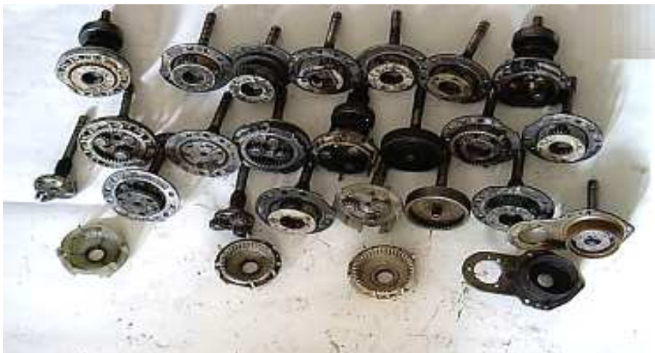
Rys. 5.21. Typowe uszkodzenia przekładni planetarnej
