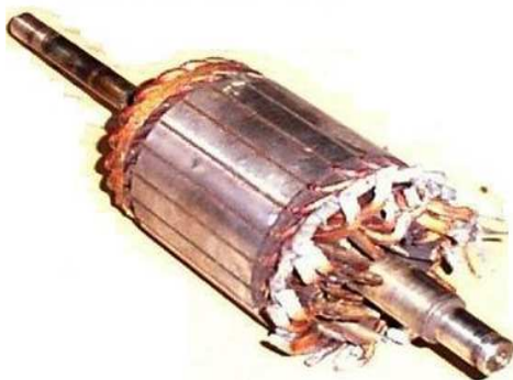
Rys. 5.12. Uszkodzenia uzwojenia wirnika (odłączenie komutatora oraz przegrzanie uzwojenia wirnika)
