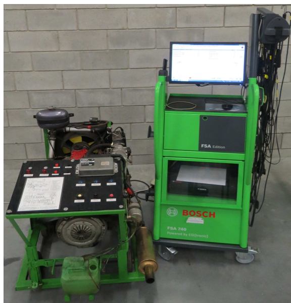
Rys. 17. Stanowisko badawcze z silnikiem Opel, wtrysk wielopunktowy Bosch ML 4.1
