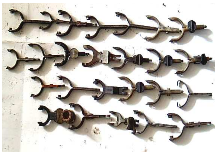
Rys. 5.24. Zużycie eksploatacyjne dźwigiennik
