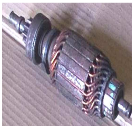
Rys. 5.12. Uszkodzenia uzwojenia wirnika (odłączenie komutatora oraz przegrzanie uzwojenia wirnika)
