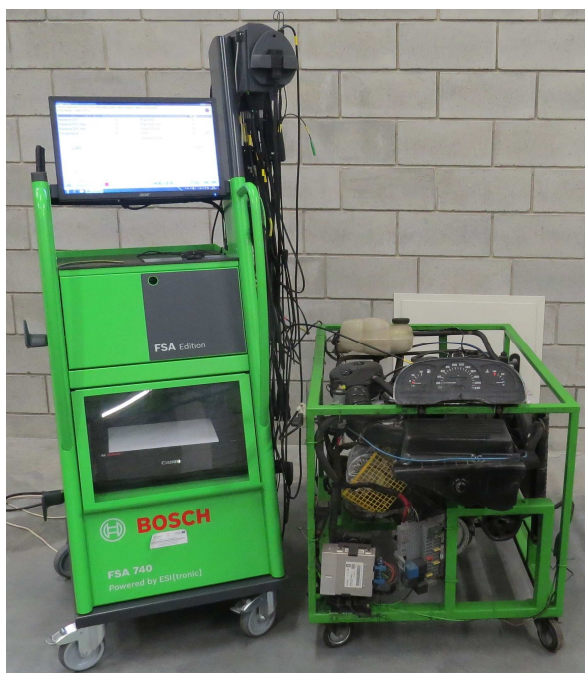
Rys. 20. Stanowisko badawcze z silnikiem Opel, wtrysk jednopunktowy Multec
