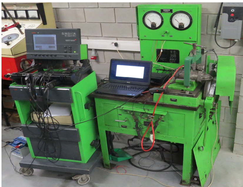
Rys. 3. Stanowisko do badań rozruszników firmy Bosch
