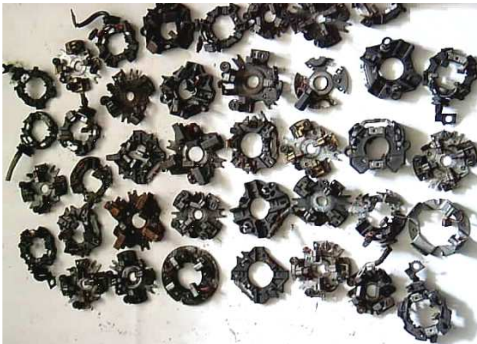
Rys. 5.15. Uszkodzenia mechaniczne szczotkotrzymaczy
