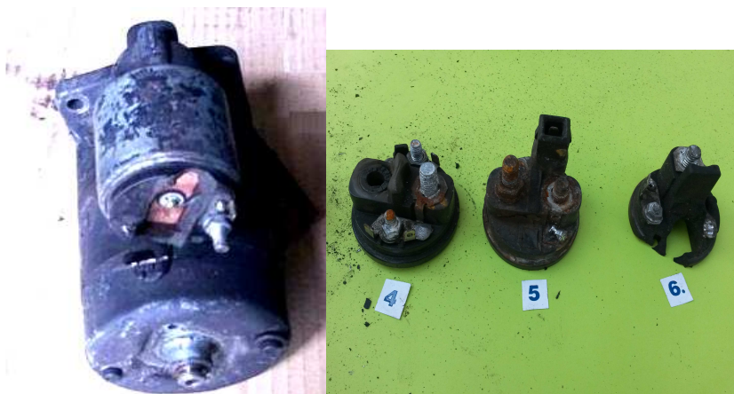
Rys. 5.25. Uszkodzenie styków wyłącznika: korozja styków (4), wypalenie styku (5), pęknięcie kopułki (6)
