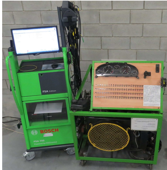
Rys. 21. Stanowisko badawcze z silnikiem ZS, CR
