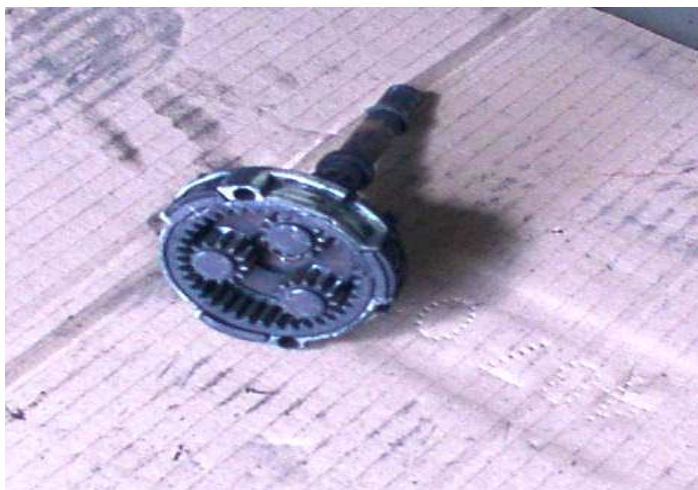
Rys. 5.23. Uszkodzenie przekładni planetarnej przez zatarcie mechanizmu sprzęgającego – widoczne odbarwienie wałka przekładni
