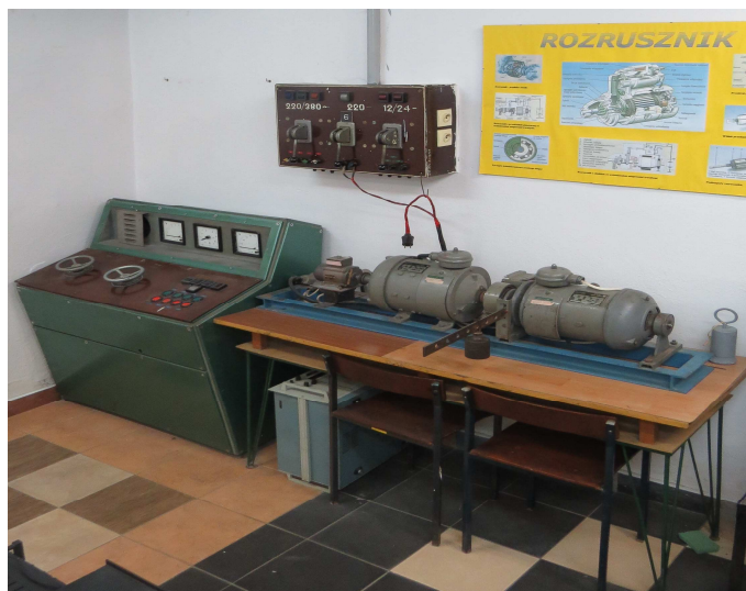
Rys. 10. Stanowisko badawcze silników szeregowych
