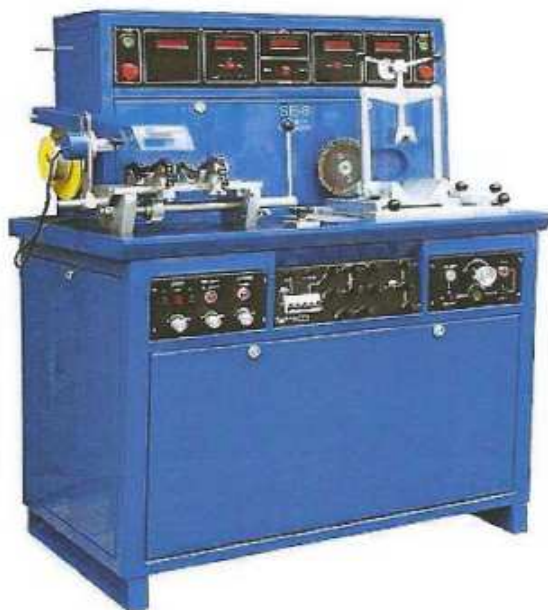
Rys. 3.9. Stanowisko do badania rozruszników SE – 7
