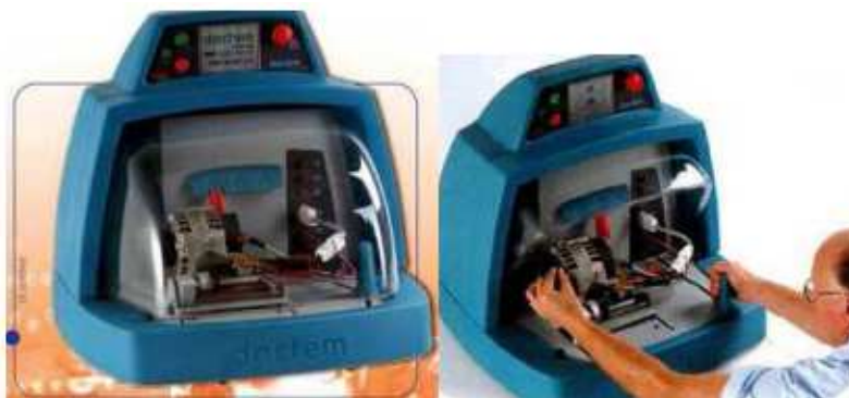
Rys.3.10. Stanowisko do badania rozruszników OPAL
