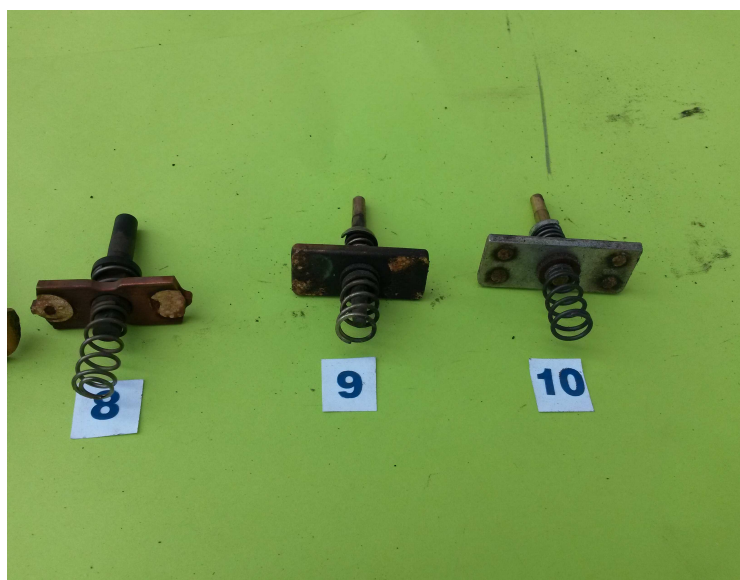
Rys. 5.28. Rodzaje uszkodzeń zwory wyłącznika elektromagnetycznego: termiczne przegrzanie (8), wypalenie styku (9), minimalne zużycie styków (10)
