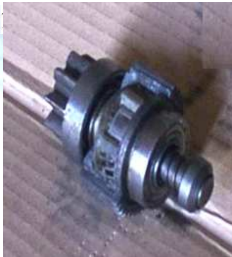
Rys. 5.19. Uszkodzenia mechanizmu sprzęgającego – zużycie zębów
