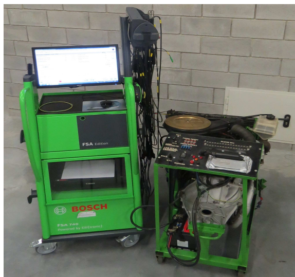
Rys. 19. Stanowisko badawcze z silnikiem Fiat 1500, wtrysk jednopunktowy Bosch MA 1.7
