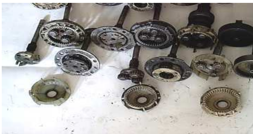
Rys. 5.22. Uszkodzenia przekładni planetarnej w postaci uszkodzenia koła słonecznego i satelit
