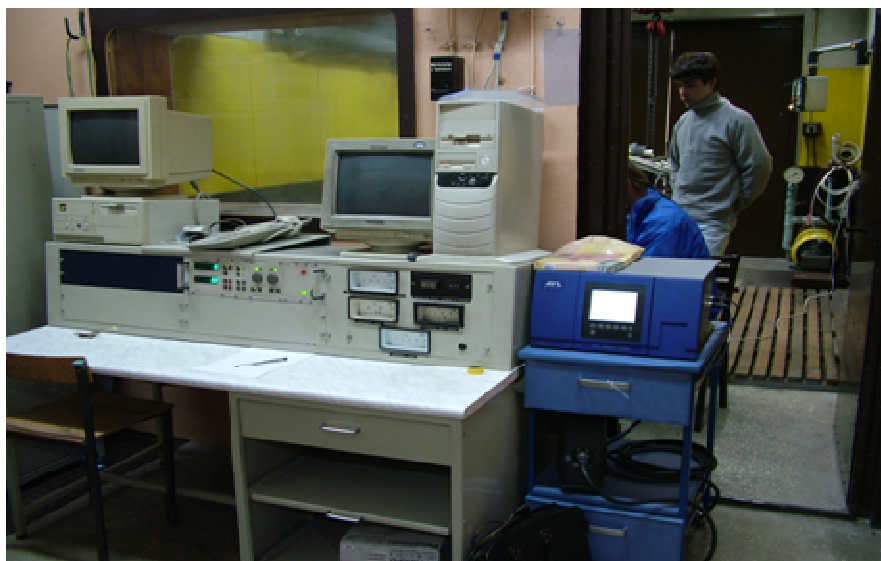
Rys. 14. Sterownia stanowiska do badania układu rozruchu silnika Focus
