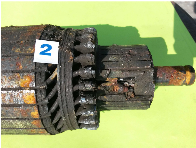
Rys. 5.13. Uszkodzenie wycinków komutatora
