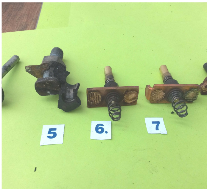
Rys. 5.27. Rodzaje uszkodzeń zwory wyłącznika elektromagnetycznego: wyłamanie (5), nadpalenie styków (6), nierównomierne zużycie (7)
