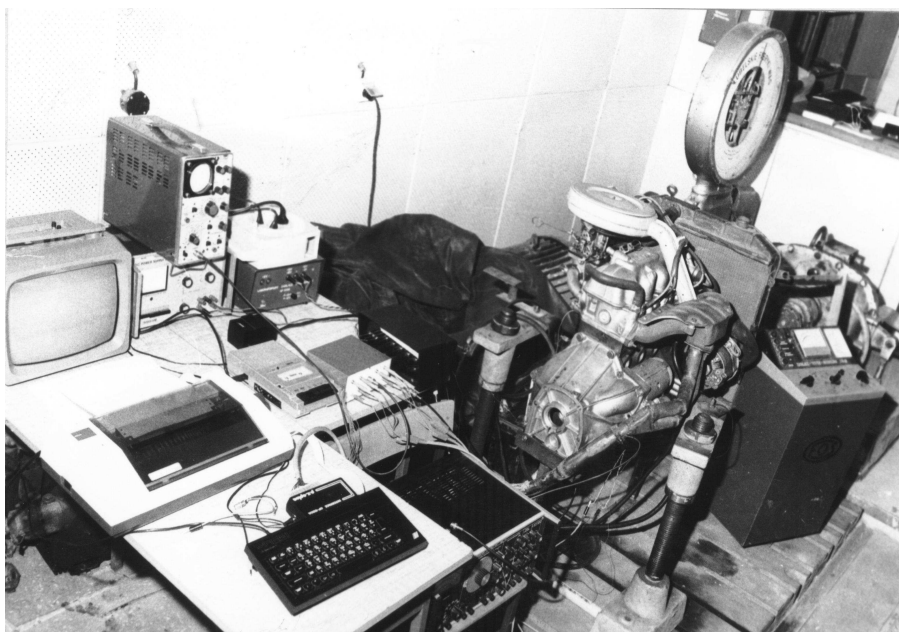
Rys. 12. Stanowisko do badania układu rozruchu silnika Fiat 1500
