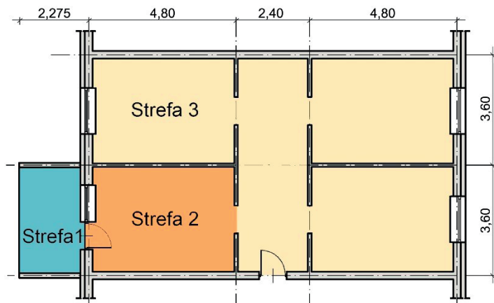
Rys. 5.2. Schemat mieszkania z wydzielonymi strefami termicznymi: strefa 1 – balkon, strefa 2 – pomieszczenie sąsiadujące z balkonem, strefa 3 – pozostała część mieszkania.
