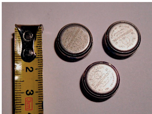
Rys. 9.1. Rejestratory pastylkowe typu iButton.
