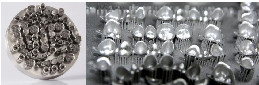
Rys. 5.13. Zastosowanie DMLS w protetyce stomatologicznej [4]
