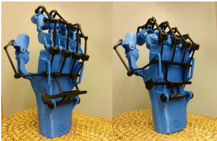
Rys. 3.21. Orteza w pozycji odblokowanej (po lewej) oraz zablokowanej (po prawej) [zbiory autora]
