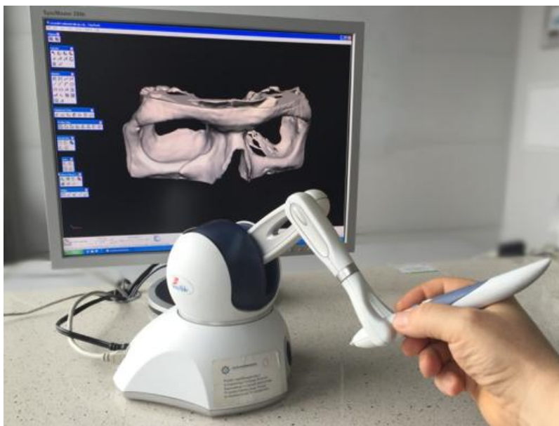
Rys. 1.5 Ramię dotykowe podczas modelowania
