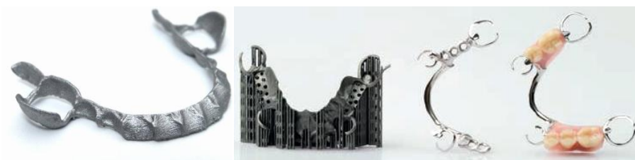
Rys. 5.12. Zastosowanie DMLS w protetyce stomatologicznej [4]
