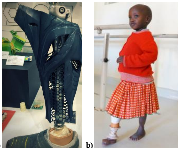
Rys. 4.8. a) Proteza uda z obudową wydrukowana w technologii FDM [16] b) Proteza uda czteroletniej Ugandyjki [17]
