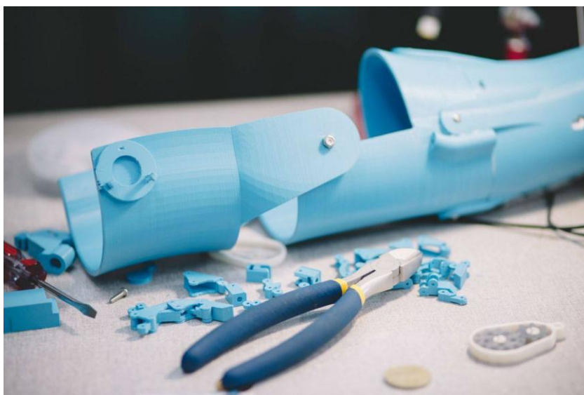
Rys. 7.1. Budowa protezy ręki z wykorzystaniem technologii FDM [1]
