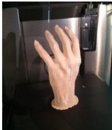
Rys. 4.9. Model epitezy ręki a) model CAD, b) model wytworzony metodą FDM [18]
