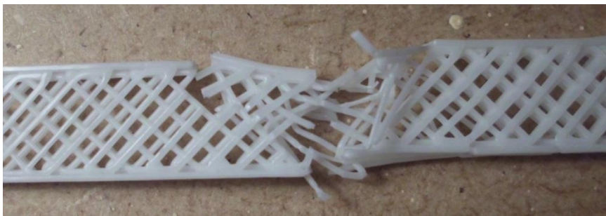
Rys. 7.7. Rozerwanie krawędzi i deformacja warstw próbki podczas próby rozciągania. (źródło: opracowanie własne)
