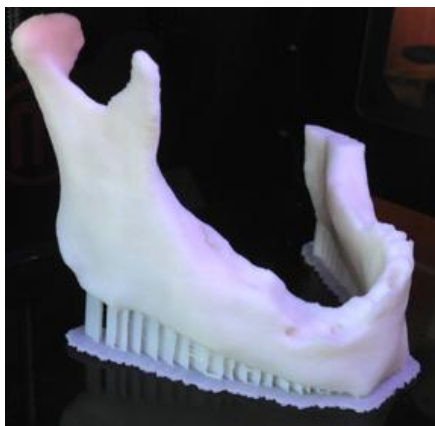
Rys. 1.2. Model bezpośrednio po wydruku, widoczne podpory
