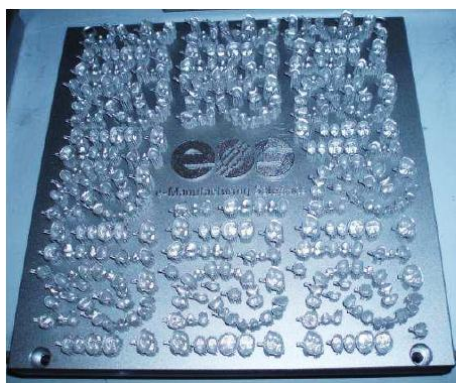
Rys. 5.11. Płyta robocza, na której znajdują się 384 spersonalizowane elementy dentystyczne wykonane w czasie niepełna 20 godzin [4]
