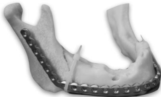
Rys. 4.11. Dopasowanie rekonstrukcji do wydrukowanego metoda przy użyciu metody FDM - model żuchwy [20]
