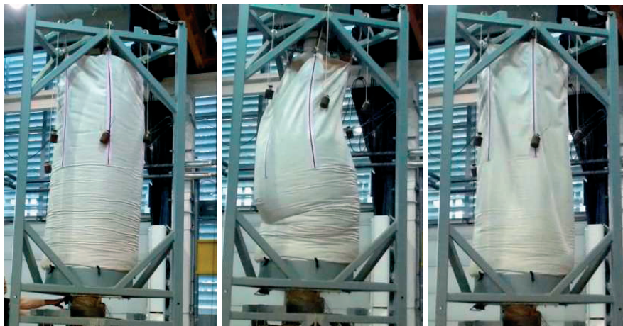
Rys. 12. Fazy badania wiotkiego płaszcza silosu: a) po napełnieniu, b) podczas opróżniania, c) po opróżnieniu
