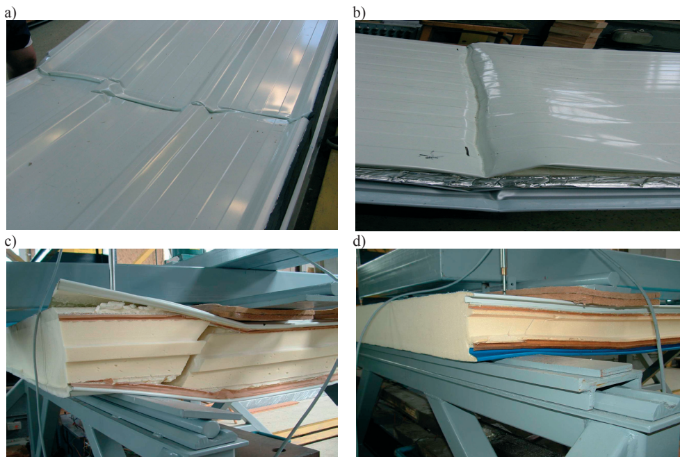
Rys. 1. Podstawowe mechanizmy zniszczenia płyt warstwowych: a) pomarszczenie okładziny profilowanej połączone z uplastycznieniem tej okładziny, b) pomarszczenie okładziny gładkiej, c) ścięcie rdzenia, d) ścięcie rdzenia wraz połączone ze zgnieciem na podporze
