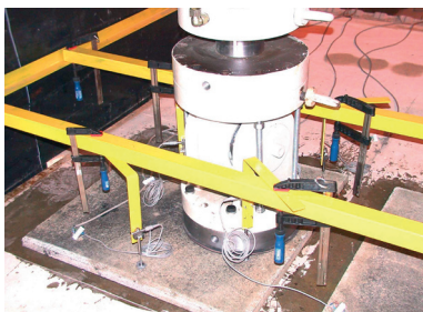
Rys. 10. Rozmieszczenie czujników indukcyjnych (fot. Michał Cwiakała)
