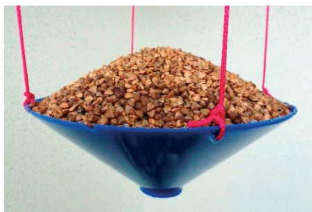
Rys. 11. Równowaga sił w stożkowej powłoce leja: a) wg rys. A.1 normy PN-EN 1993-4-1, b) w rzeczywistości, podwieszonym na pionowych cięgnach stożku, który jest bryłą sztywną
