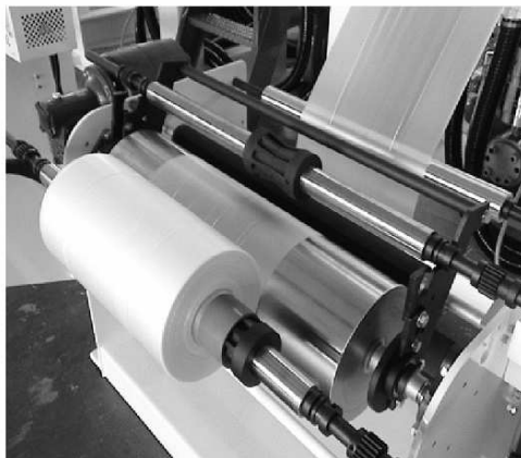
Rys. 4. Wygląd fragmentu linii technologicznej wytłaczania pionowo w górę: a) głowica wytłaczarska oraz pierścień chłodzący, b) urządzenie nawijające [www.chinfach.com.tw]
