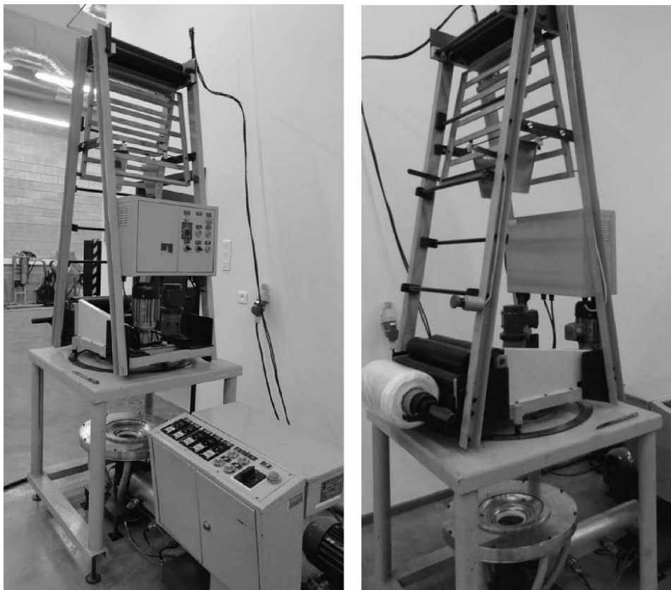
Rys.13. Wygląd stanowiska technologicznego W 25/25 wytłaczania z rodmuchiowaniem folii
