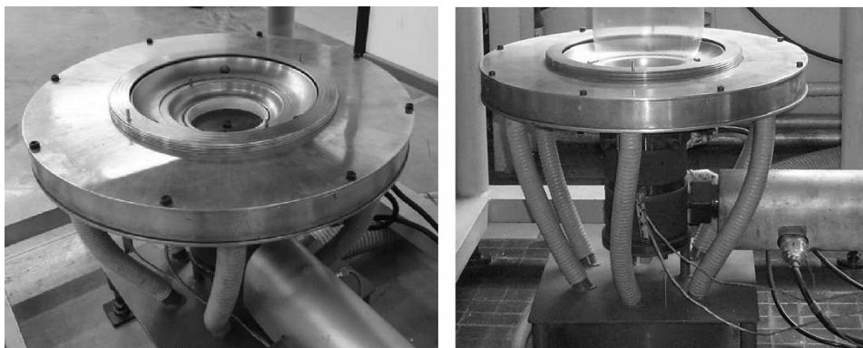
Rys. 12. Wygląd głowicy krzyżowej pierścieniowej wraz z urządzeniem nadmuchiującym chłodzącym
