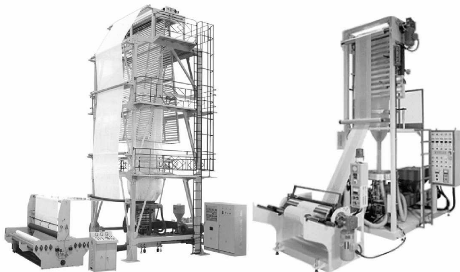
Rys. 3. Przykład linii technologicznych produkcji folii metodą wytłaczania z rozdmuchiwaniem pionowo w górę [www.chinajinda.en, www.cacoplastics.com]
