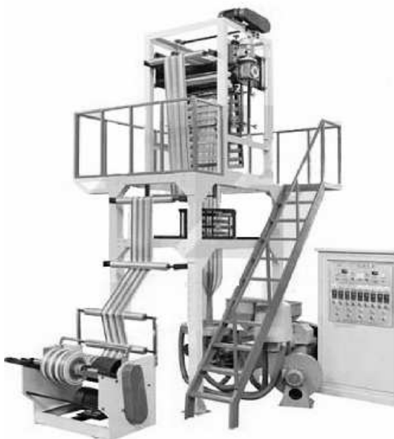
Rys. 9. Przykład linii technologicznej do wytwarzania folii dwuwarstwowej oraz wygląd otrzymywanej folii dwuwarstwowej (dwukolorowej) [www.herowu.com]
