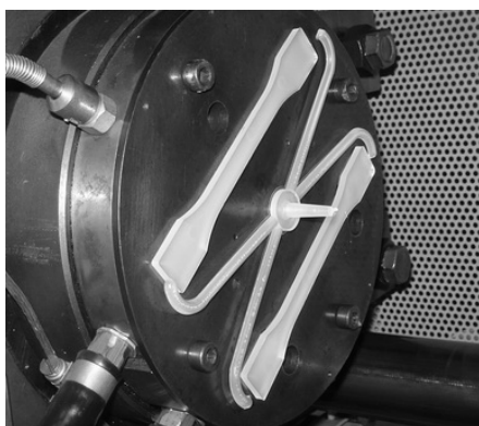
Rys. 3.9. Wygląd próbek rodzaju 1A wykonanych metodą wtryskiwania przy zastosowaniu formy wtryskowej dwugniazdowej
