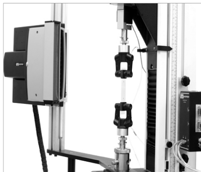
Rys. 3.6. Ekstensometry bezdotykowe firmy Instron: a) ekstensometr do badania folii, b) video ekstensometr [www.instron.com]
