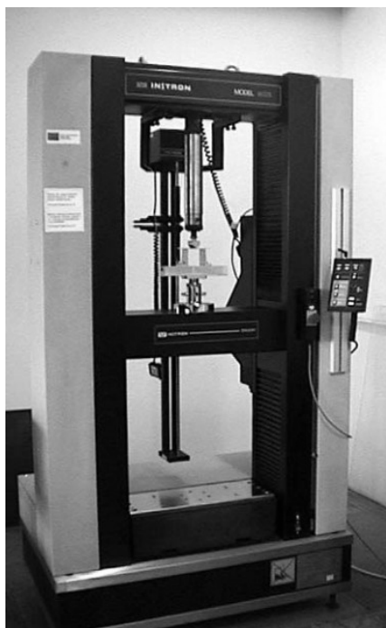
Rys. 4.3. Maszyny wytrzymałościowe podłogowe, dwukolumnowe firm: a) Instron, b) Zwick z komorą termiczną [www.instron.com, www.zwick.com]
