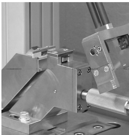
Rys. 8.5. Wygląd uchwytu mocowania próbki wraz z młotem podczas próby rozciągania uderowego
