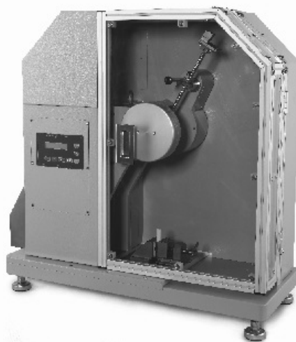
Rys. 8.3. Wygląd młota uderowego Comatech Testing Machines, typ 639F wraz z oprzyrządowaniem do badań rozciągania uderowego
