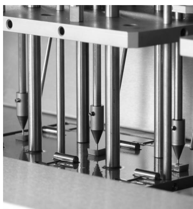
Rys. 10.7. Wygląd aparatu Vicata firmy Zwick z widocznym układem pomiarowym [www.zwick.com.pl]
