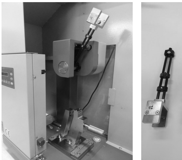
Rys. 8.4. Młot uderowy Comatech Testing Machines, typ 639F; wygląd młota wraz z oprzyrządowaniem do badań rozciągania uderowego, oraz odpowiadającego stosowanej metodzie, wahadła uderowego
