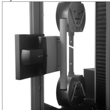
Rys. 3.6. Ekstensometry bezdotykowe firmy Instron: a) ekstensometr do badania folii, b) video ekstensometr [www.instron.com]
