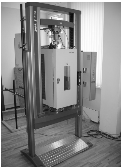
Rys. 4.3. Maszyny wytrzymałościowe podłogowe, dwukolumnowe firm: a) Instron, b) Zwick z komorą termiczną [www.instron.com, www.zwick.com]
