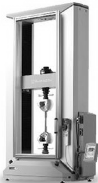
Rys. 3.3. Maszyny wytrzymałościowe podłogowe, dwukolumnowe firm: a) Instron b) Shimadzu [www.instron.com, www.shimadzu.com]
