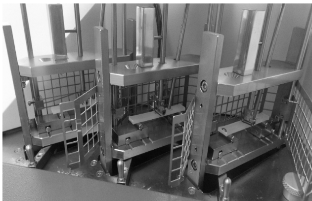
Rys. 10.12. Wygląd trzech stacje pomiarowych do pomiarów temperatury ugięcia metodą HDT, wraz z próbkami pomiarowymi oraz widocznymi trzpieniami do ugięcia próbek
