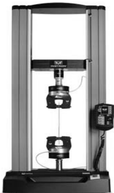
Rys. 3.3. Maszyny wytrzymałościowe podłogowe, dwukolumnowe firm: a) Instron b) Shimadzu [www.instron.com, www.shimadzu.com]
