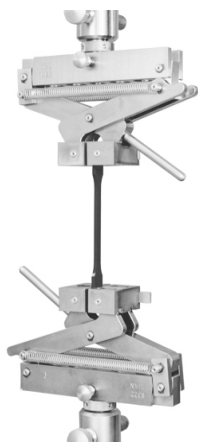
Rys. 3.4. Przykłady uchwytów mocujących do badania wytrzymałości na rozciąganie [www.zwick.com]
