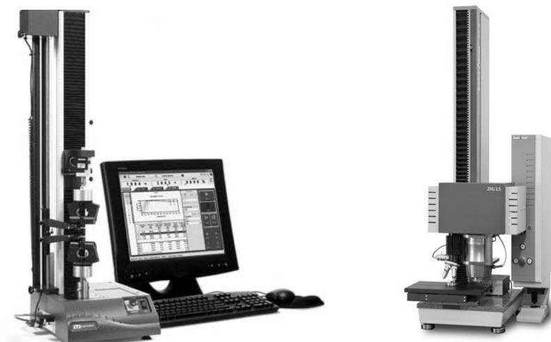
Rys.3.2. Maszyny wytrzymałościowe jednokolumnowe, przykłady: a) Instron 3340 b) Zwick Z2,5 [www.instron.com, www.zwick.com]
