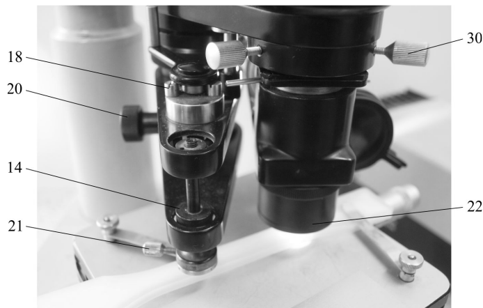
Rys. 2.4. Mikrotwardościomierz PMT-3; widok stolika pomiarowego wraz z próbką i mechanizmu obciążeniowego
