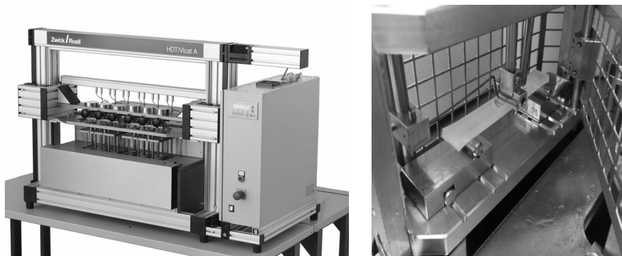
Rys. 10.5. Wygląd aparatu HDT firmy Zwick z widocznym układem obciążeniowym [www.zwick.com.pl]
