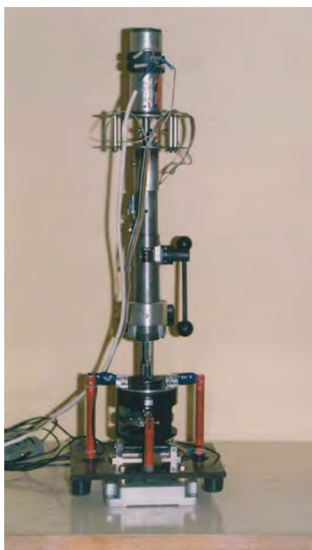
Rys. 4. Głowica wkręcająca zamontowana na stanowisku badawczym
