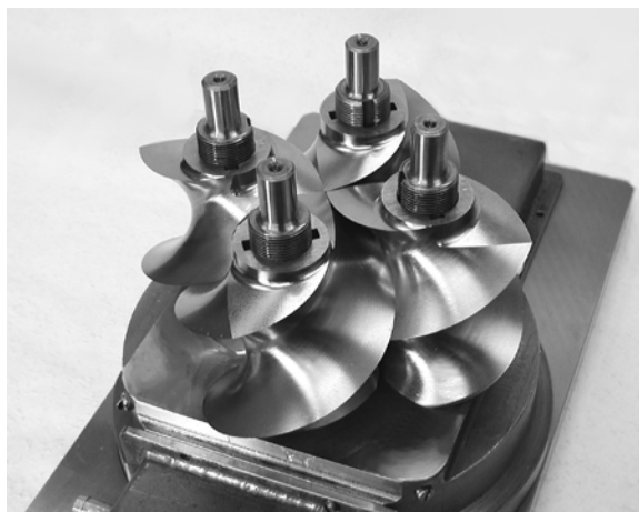
Rys. 11. Sprężarka z rotorami śrubowymi w trakcie montażu (odjęta płyta przednia i osłona boczna)
