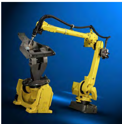
Fot. 7. Stanowisko do spawania stali nierdzewnej i aluminium [6]
