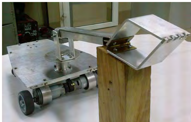
Fot. 9. Widok ramienia z chwytakiem i platformą z silnikami robota „Inspektor 1”
