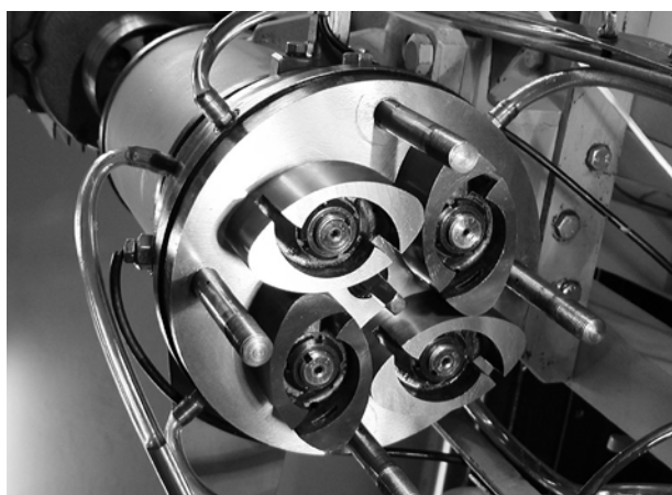
Rys. 9. Sprężarka z rotorami walcowymi podczas montażu (bez krzyżaka z blokiem zaworowym) – widoczne rotory z kanałami rozrządu
