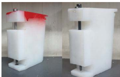
Rys. 5. Usprawnienie konstrukcyjne klocków (z lewej rozwiązanie przed usprawnieniem)
