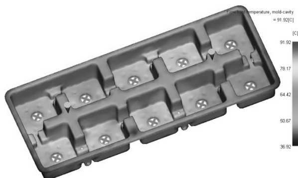
Rys. 7. Wyniki zmiany temperatury frontu przepływu tworzywa w formie
