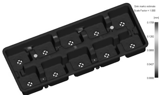
Rys. 9. Diagram przedstawiający lokalizację oraz wartości jam skurczowych
