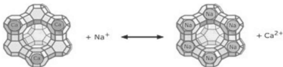
Rys. 3. Schemat reakcji wymiany jonowej z udziałem zeolitów [8]
