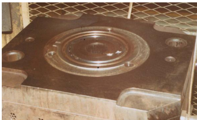
Rys. 2.7. Matryca formy doświadczalnej z gniazdem formującym w kształcie spirali Archimedesesa
