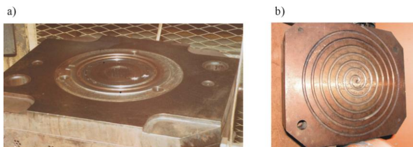
Rys. 1.24. Wygląd ogólny części formy doświadczalnej do określania przetwarzalności tworzyw metodą gniazda spiralnego; a) forma prasownicza, b) forma wtryskowa
