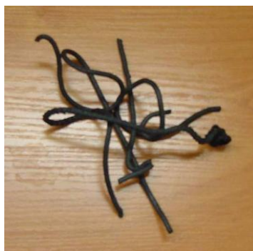
Rys. 3.2. Wygląd ogólny próbki tworzywa wyciśniętego podczas pomiaru
