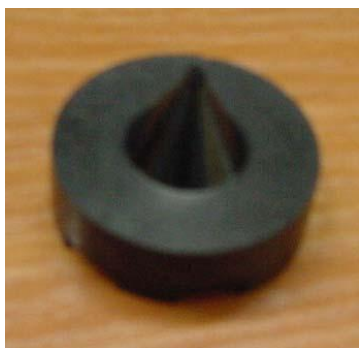
Rys. 3.1. Wypraska pozostała w komorze zasypowej plastometru BIP po prasowaniu
