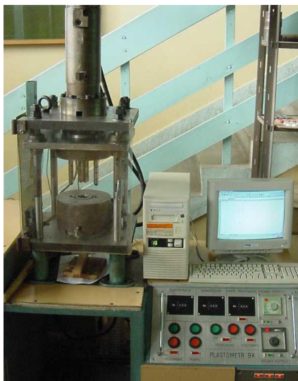
Rys. 2.5. Wygląd ogólny zmodernizowanego plastometru BIP
