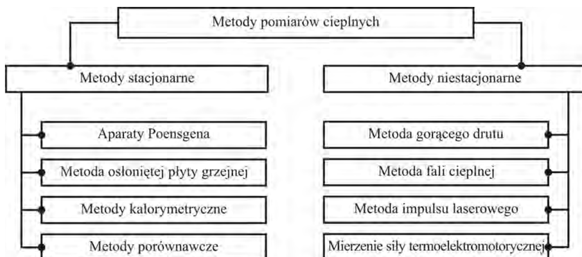
Rys. 4.6. Metody pomiarów cieplnych materiałów budowlanych
