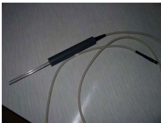
Rys. 4.9. Sonda LP/mts (moisture, temperature, salinity) do mierzenia zawartości wody, temperatury i zasolenia materiałów porowatych TDR
