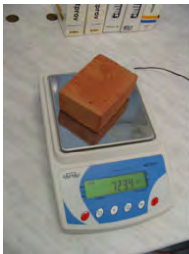
Rys. 4.10. Wyznaczanie wilgotności materiału za pomocą metody wagowej
