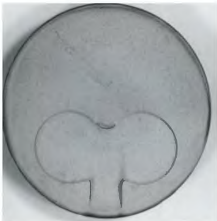
Rys. 10.13. Próbką pokryta trzecim zestawem powłokowym po testach zmęczenia cieplnego
