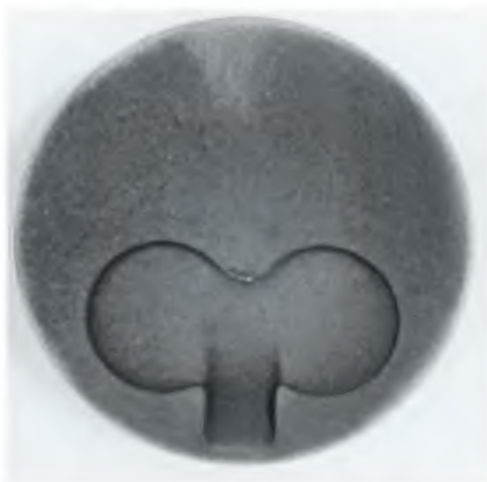
Rys. 10.14. Próbką pokryta pierwszym zestawem powłokowym po badaniach zmęczenia cieplnego
