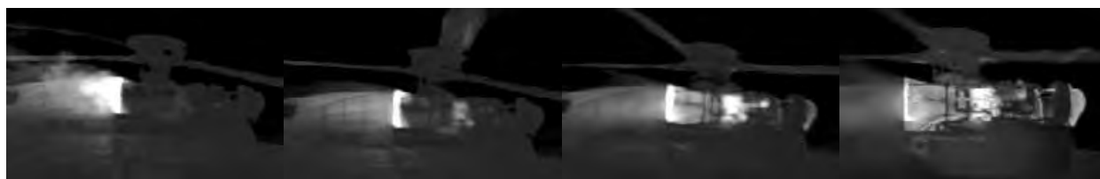
Badanie rozruchu turbinowego silnika śmigłowca 10W przy użyciu kamery termowizyjnej S65
