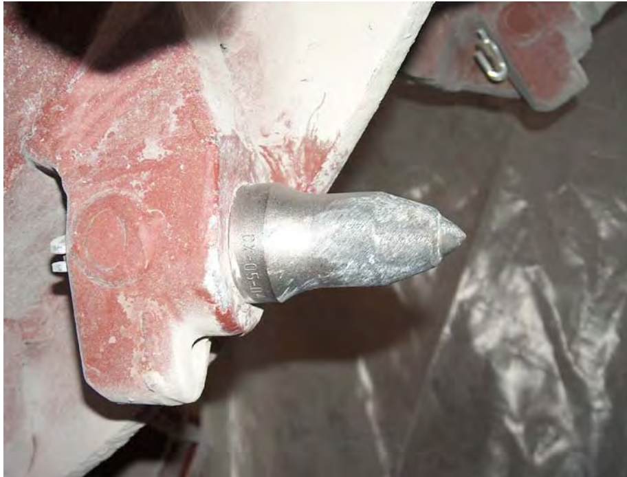
Rys.11. Nóż styczno-obrotowy w trakcie badań stanowiskowych.
