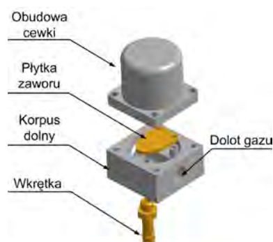
Rys. 5.3. Elementy składowe wtryskiwacza
