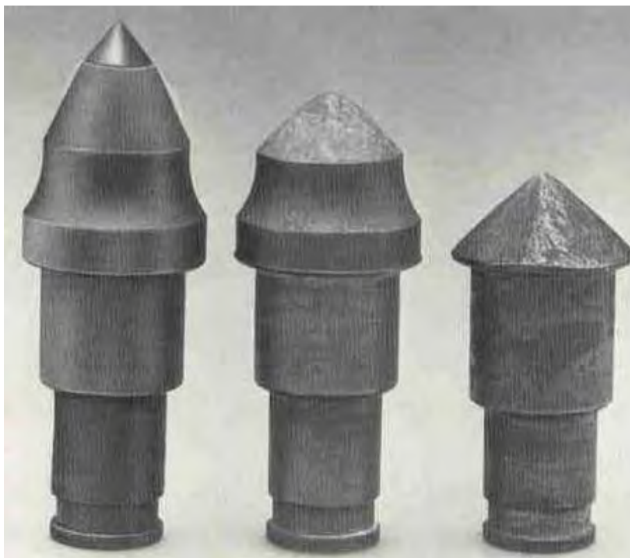
Rys. 1. Typowy przebieg zużycia obrotowego noża stożkowego [6]
