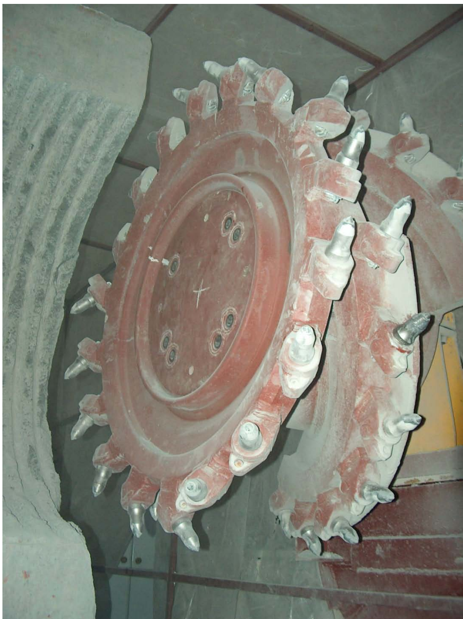
Rys 9. Głowica wielonarzędziowa do urabiania z zamontowanym zespołem noży obrotowych.
