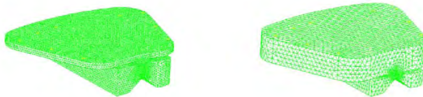
Rys. 16. Siatki elementów skończonych modeli segmentów H=5\text{mm} , H=20\text{mm}
