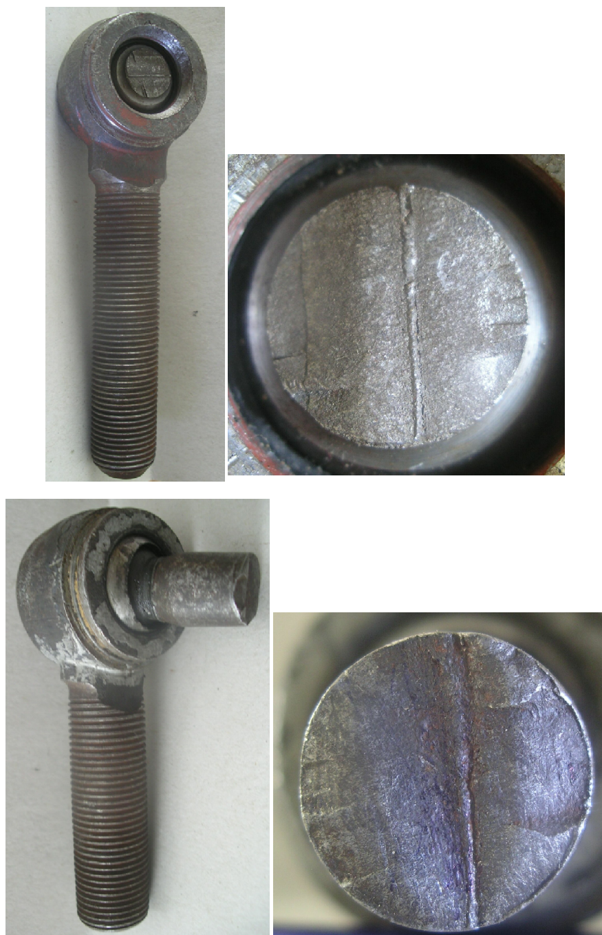
Rys. 19. Zmęczeniowo pęknięcie sworznie końcówek drążków kierowniczych [opracowanie własne]
