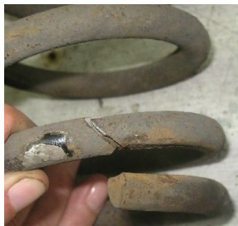
Rys. 16. Przełom zmęczeniowy sprężyny zawieszenia oraz wyjaśnienie jego zainicjowania w postaci karbu „wybitego” przez koniec pręta sprężyny [opracowanie własne]
