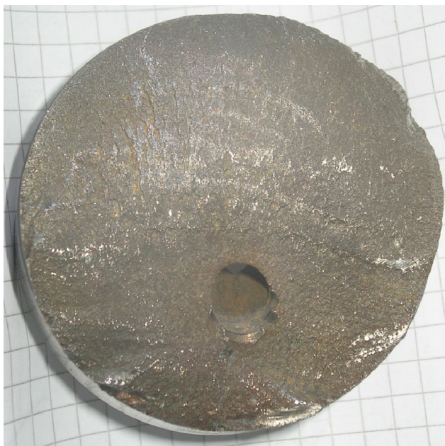
Rys. 26. Mniej „wyraźny” przełom zmęczeniowy czopa wału korbowego wykonanego z żeliwa sferoidalnego (Ford Transit). Pęknięcie wystąpiło po naprawie wcześniej zatartego czopa przez szlifowanie na mniejszy wymiar. Wcześniejsza awaria spowodowała obniżenie twardości a tym samym wytrzymałości zmęczeniowej elementu [opracowanie własne]
