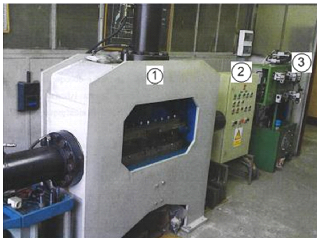
Rys. 2. Trójsuwakowa prasa kúźnicza: 1 – część mechaniczna, 2 – szafa sterownicza, 3 – hydrauliczny układ zasilający [opracowanie własne]
