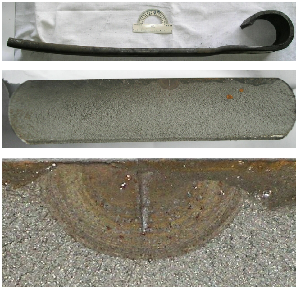
Rys. 18. Przykład zmęczeniowego złamania pióra resoru (Volvo FL 10), poniżej wygląd przełomu i powiększenie strefy zmęczeniowej i fragmentu obszaru strefy dołamania – typowy obraz przełomów piór resorów. W górnej strefie przełomu pas produktów korozji powstałych prawdopodobnie w czasie przechowywania elementu, już po uszkodzeniu [opracowanie własne]
