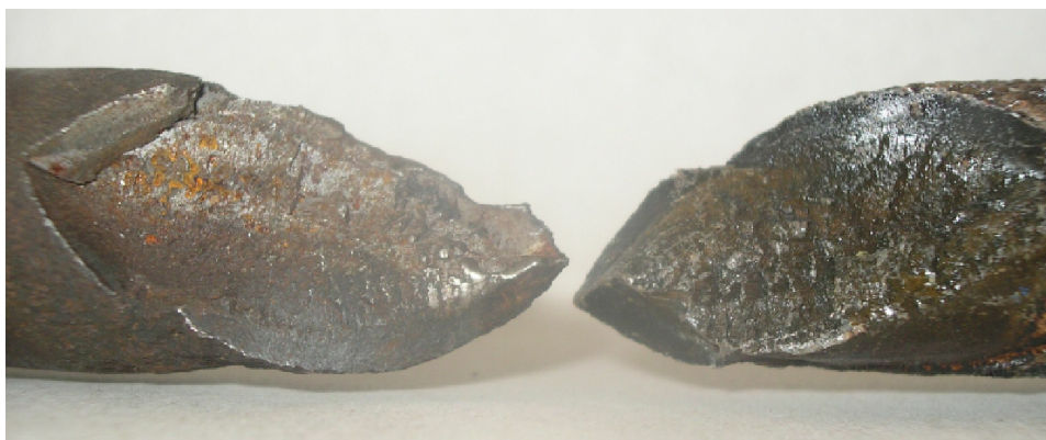
Rys. 3. Dwie powierzchnie przełomu półosi napędowej, powstałego w miejscu osłabionym przez korozję pod gumowym tłumikiem drgań skrętnych (Nissan Primera). Widoczne różnice w wielkości ziarna przy powierzchni i wewnątrz przekroju. Spiralny kształt wynika z działania naprężeń skręcających [opracowanie własne]
