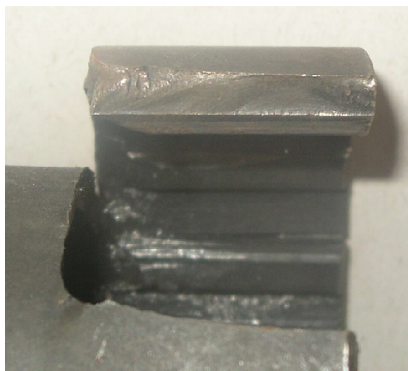
Rys. 17. Wielokrotny przełom tulei sprzęgającej o charakterze zmęczeniowym. Ogniska przełomów w karbach utworzonych przez dna rowków wpustowych [opracowanie własne]
