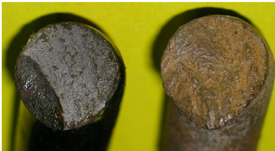
Rys. 15. Powierzchnie dwu przełomów zmęczeniowych drążków stabilizatorów (Ford Escort). Po prawej obraz przełomu zatarty przez produkty korozji powstałe po wystąpieniu uszkodzenia [opracowanie własne]
