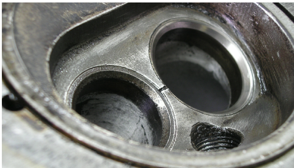
Rys. 27. Pęknięcie mostka międzyzaworowego głowicy aluminiowej, czterosurowego silnika iskrowego, chłodzonego powietrzem (PF 126p) [opracowanie własne]
