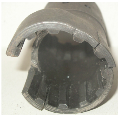
Rys. 17. Wielokrotny przełom tulei sprzęgającej o charakterze zmęczeniowym. Ogniska przełomów w karbach utworzonych przez dna rowków wpustowych [opracowanie własne]
