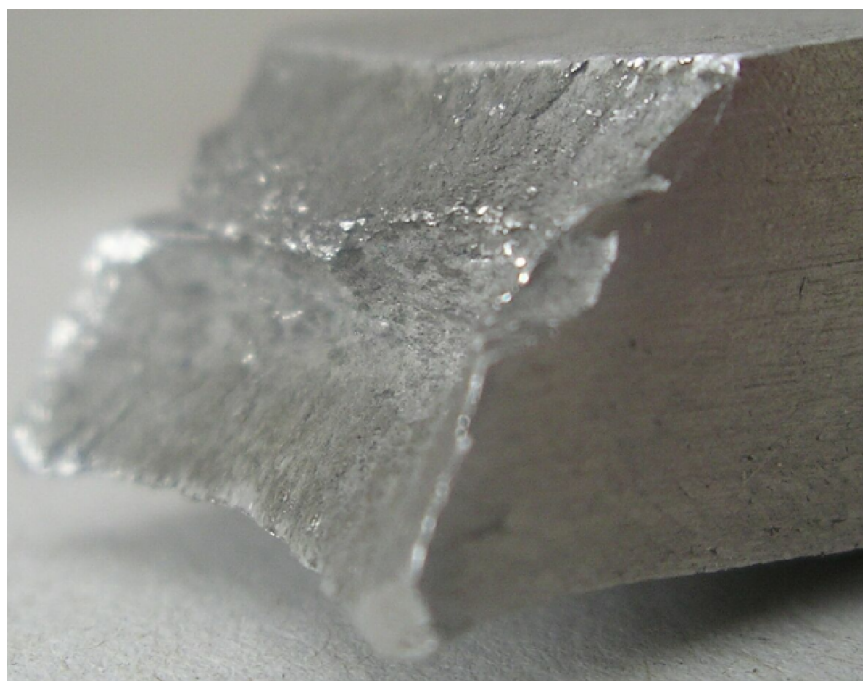
Rys. 5. Przełom powstały w wyniku zerwania próbki stalowej na maszynie wytrzymałościowej. W środkowej strefie „bardziej chropowaty” występ (uskok) – wynik mniejszego stopnia przewalcowania wewnątrz materiału. Pęknięcie próbki nastąpiło pod kątem 45^\circ , a więc w płaszczyźnie największych naprężeń tnących [opracowanie własne]
