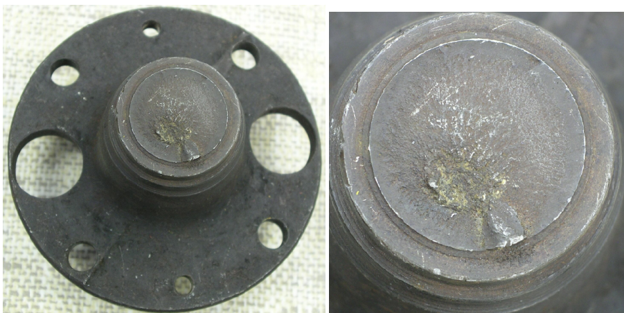
Rys. 13. Obraz przełomu pękniętej zmęczeniowo półosi samochodu FSO Polonez. Obraz przełomu zatarty częściowo przez produkty korozji powstałe po zdarzeniu. Strefa zmęczeniowa pierścieniem otacza strefę dołamania. Pęknięcie zostało zainicjowane w karbie utworzonym przez uskok średnicy przy czopie łożyskowym. Bezpośrednią przyczyną awarii była próba regeneracji czopa przez napawanie [opracowanie własne]
