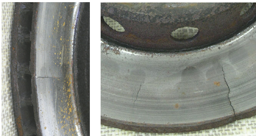
Rys. 36. Pęknięcia cieplne wentylowanej i monolitycznej tarczy hamulcowej [opracowanie własne]
