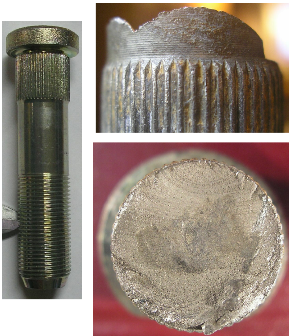
Rys. 22. Przełom jednej ze śrub mocowania tylnego koła bliźniaczego (STAR 1142), urwany na skutek nieprawidłowego wykonania śrub. Karby geometryczne w postaci obwodowych rys pochodzących z obróbki skrawaniem nakładające się na początek strefy rowków ustalających. Poniżej przykład prawidłowego wykonania śruby [opracowanie własne]
