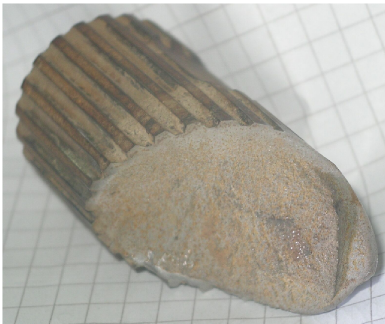
Rys. 7. Doraźnie „ukręcona” końcówka czopa wału głównego przekładni kierowniczej (BMW serii 7), zastosowanej w samochodzie terenowym. Przyczyna – najechanie przednim kołem na twardą przeszkodę. Później powstały nalot korozyjny [opracowanie własne]
