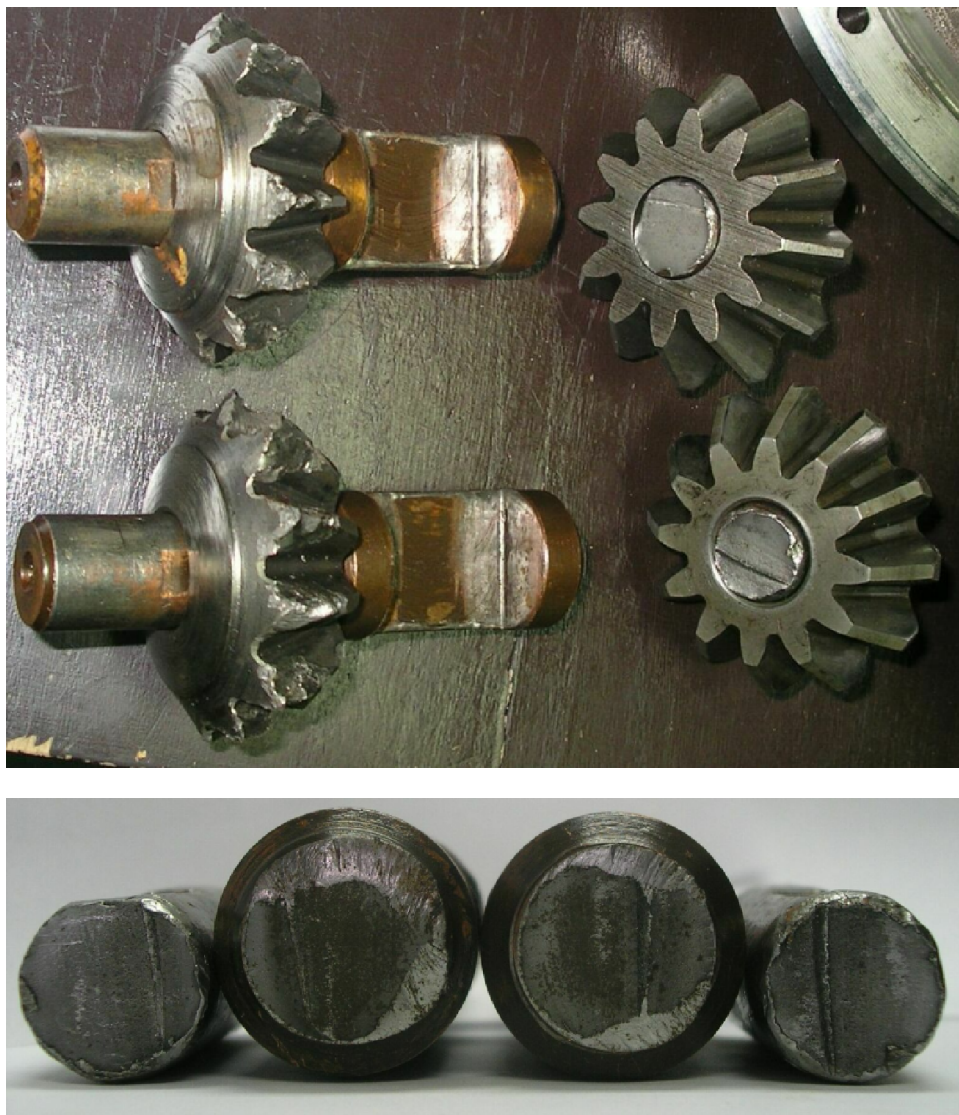
Rys. 23. Pęknięcia zmęczeniowe osi satelitów mechanizmu różnicowego (Bizon Super), powstałe w miejscach karbu geometrycznego [opracowanie własne]
