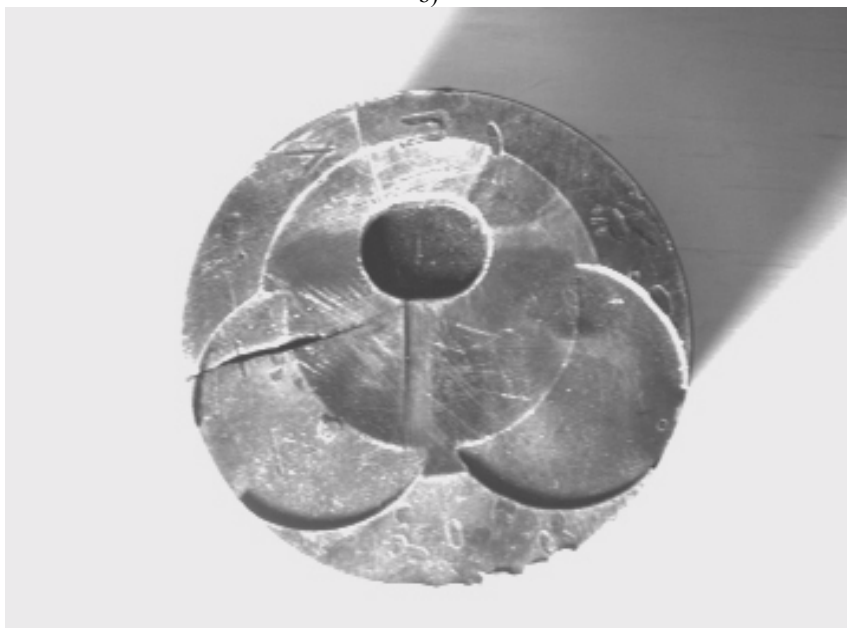
Rys. 28. Przykłady pęknięcia denek tłoków silników ZS z wtryskiem do komory wirowej (a), na przykładzie tłoka silnika Opel 2.5 D ( D=92 mm) i komory wstępnej (b), Mercedes-Benz ( D=91 mm). W obydwu przypadkach pęknięcia denka na wskroś [opracowanie własne]
