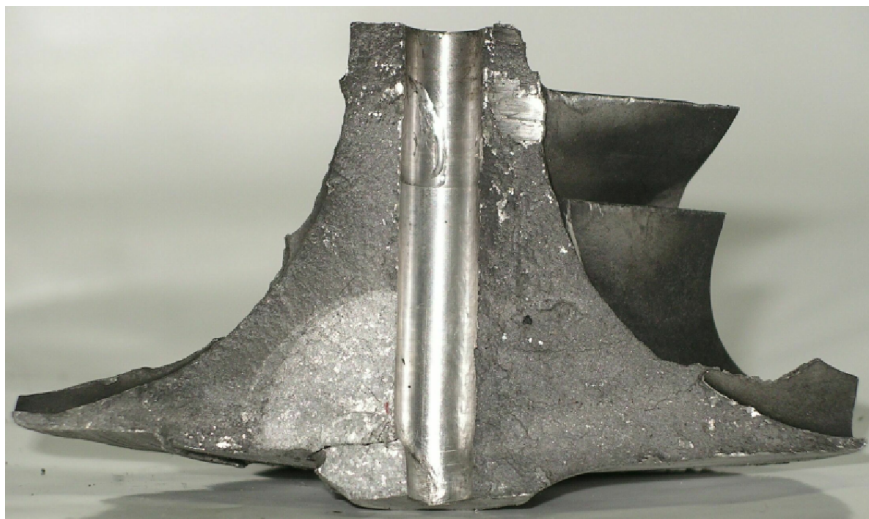
Rys. 27. Rozerwany na skutek zmęczenia wirnik sprężarki doładowującej wykonany ze stopu aluminium (Renault Magnum). Strefa zmęczeniowa na lewo od otworu wałka [opracowanie własne]
