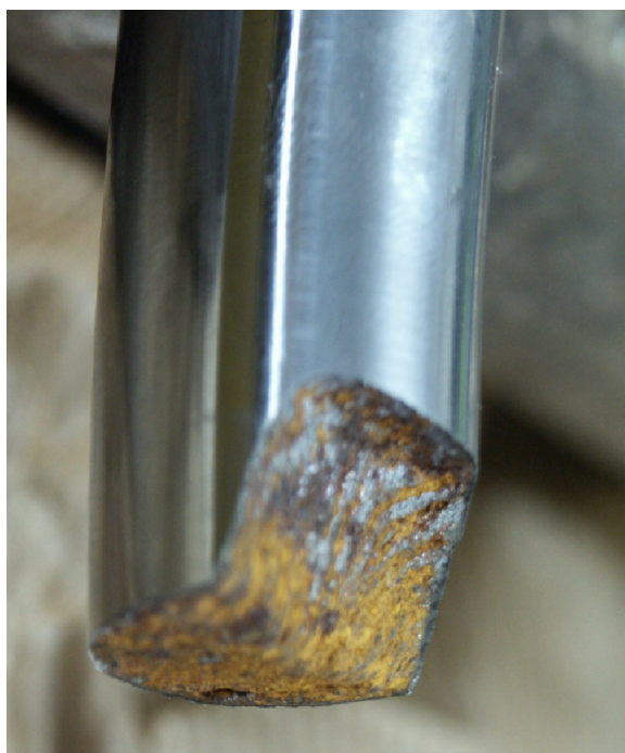
Rys. 4. Dwie części przełomu doraźnego tłoczyska amortyzatora kolumny McPhersona (Daewoo Nubira). Przełom powstał przy pełnym wysunięciu tłoczyska w wyniku uderzenia pojazdu w drzewo. Powierzchnie obu przełomów pokryte nalotem produktów korozji powstałych po zdarzeniu [opracowanie własne]
