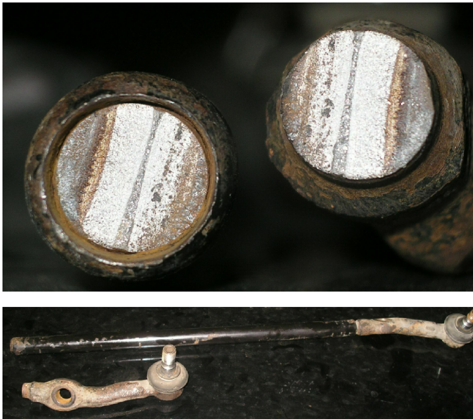
Rys. 20. Pęknięcie zmęczeniowe końcówki drążka układu kierowniczego (Polonez Truck) w miejscu początku zaciśniętej na nim rury. Obraz przełomów charakterystyczny dla dwukierunkowego zginania [opracowanie własne]
