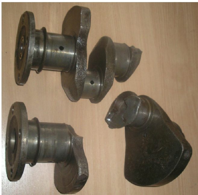
Rys. 24. Pękanie wałów korbowych ma może mieć miejsce niekoniecznie w okolicy koła zamachowego (maksymalna wartość wytworzonego przez silnik momentu obrotowego). Jego umiejscowienie zależy od przypadkowych czynników takich jak np. luzy łożyskowe, prawidłowa geometria korpusu silnika oraz jakość obróbki powierzchni czopów, zwłaszcza w odniesieniu do łuków przejściowych [opracowanie własne]
