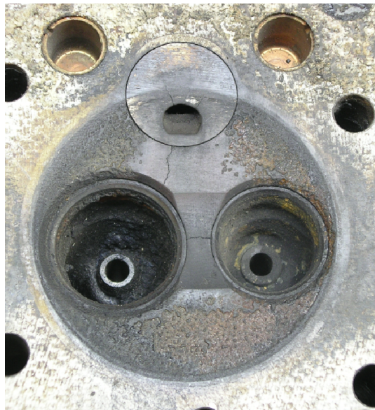
Rys. 34. Pęknięcia zmęczeniowe na jednej z powierzchni ogniowych głowicy silników 4C90
