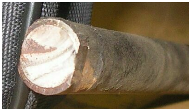
Rys. 21. Przełom zmęczeniowy dźwigni zmiany biegów (Lublin) [opracowanie własne]
