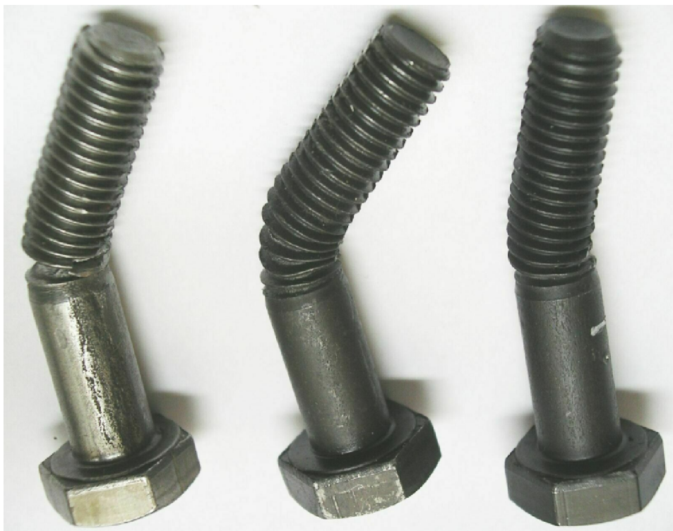
Rys. 2. Wygląd łbów i przełomów badanych śrub M10 oraz zestawienie w celu zilustrowania kątów trwałego zgięcia, przy których śruby uległy zniszczeniu [opracowanie własne]
