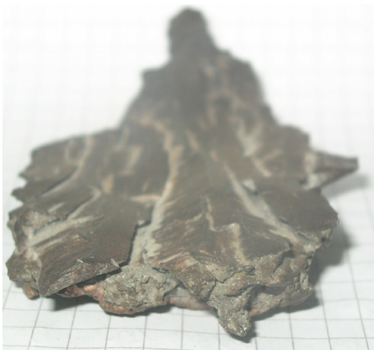
Rys. 8. Odłamek korpusu artyleryjskiego pocisku odłamkowo-burzącego. Wielokrotne przełomy doraźne w płaszczyznach największych naprężeń tnących skorupy [opracowanie własne]
