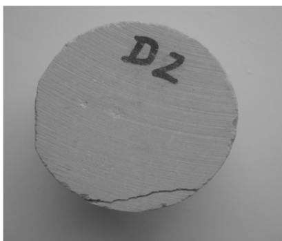
Rys. 8.20. Stan opoki K2o po badaniu mrozoodporności: a) próbka C4 po 10 cyklu; b) próbki z preparatem B po 50 cyklach; c) pęknięcie na próbce D2 po 45 cyklu; d) stan opoki niehydrofobizowanej K3 po 4 cyklu zamrażania – rozmrażania
