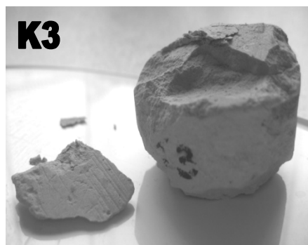
Rys. 8.20. Stan opoki K2o po badaniu mrozoodporności: a) próbka C4 po 10 cyklu; b) próbki z preparatem B po 50 cyklach; c) pęknięcie na próbce D2 po 45 cyklu; d) stan opoki niehydrofobizowanej K3 po 4 cyklu zamrażania – rozmrażania
