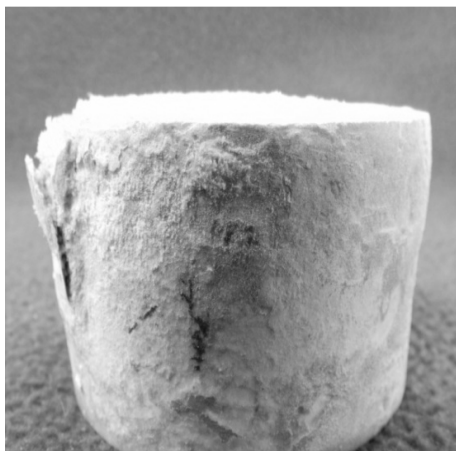
Rys. 8.14. Destrakcja powierzchni opoki K2 spowodowana krystalizacją soli podczas schnięcia laboratoryjnego
