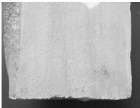
Rys. 8.1. Opoka K1-40 podczas badania głębokości hydrofobizacji preparatem B – prawie niewidoczny film hydrofobowy na spodzie próbki
