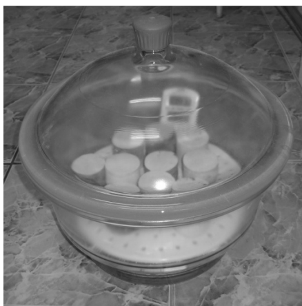
Rys. 8.9 Eksykator z próbkami opoki podczas oznaczania wskaźnika absorpcji kropli wody WA
