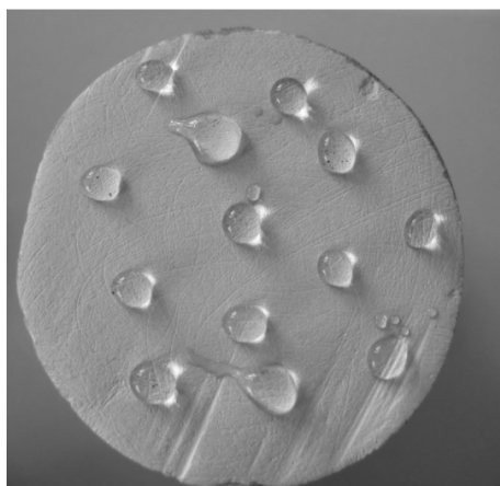
Rys. 8.10 Test absorpcji kropli wody przez zhydrofobizowaną powierzchnię opoki. Kamień K1-40-30, preparat A
