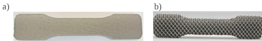
Rys. 5. Przykładowe próbki z metamateriałów otrzymanych metodą LPBF o porowatości: a) bliskiej 0 (lity materiał) oraz b) 81,5%
