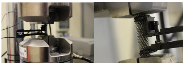
Rys. 6. Próbką z metamateriału otrzymanego metodą LPBF ze spieku stopu tytanu Ti6Al4V o porowatości 81% umieszczona w uchwytach maszyny wytrzymałościowej MTS 858 Mini Bionix (Falkowska i inni, 2020)
