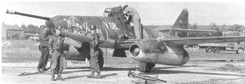
Rys. 8.51. Messerschmitt Me 262A-1a/U4, z działem kalibru 50 mm, który rozwijał prędkość maksymalną 872 km/h (na wysokości 6000 m)
