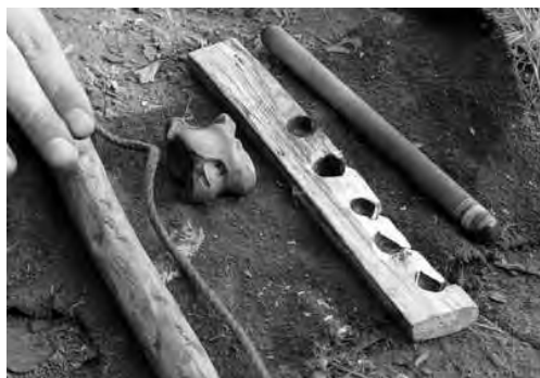
Rys. 2.1. Oprzyrządowanie do niecenia ognia przez pocieranie o siebie miękkiego i twardego kawałka drewna
