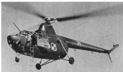
Rys. 8.88. Śmigłowiec PZL SM-1: masa własna - 1785 kg, masa startowa - 2210 kg, max. prędkość - 185 km/h, pułap - 3500 m, zasięg - 380 km
