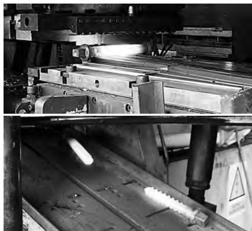
Rys. 4.59. Walcowanie gwintu wkrętów kolejowych w układzie podwójnym: a) początek procesu, b) ukształtowane wkręty szynowe
