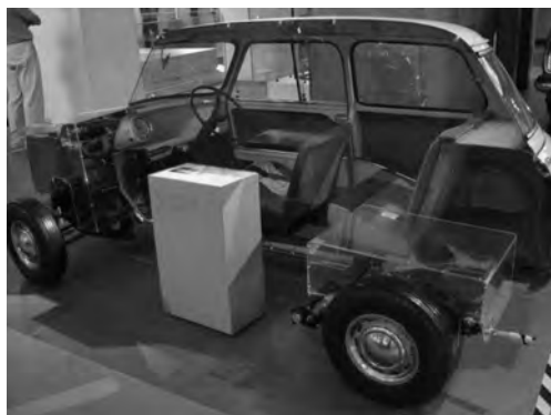
Rys. 6.26. Przekrój przez Mini Morrisa przygotowany na wystawę w 1959 roku
