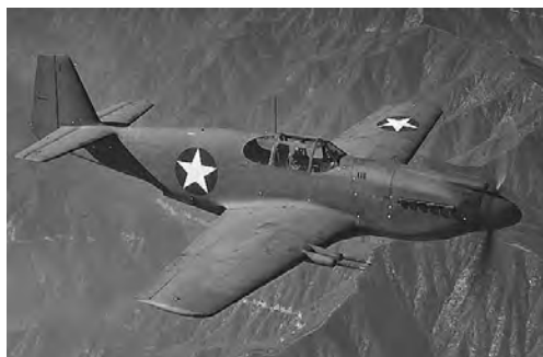
Rys. 8.46. Mustang Mk. IA, jeden z najszybszych samolotów śmigłowych (prędkość maksymalna 730 km/h)
