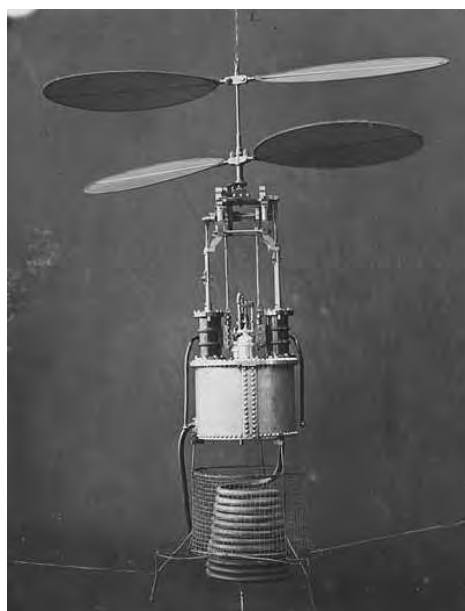
Rys. 8.67. Śmigłowiec zbudowany przez Pontona d'Amercourta, 1862 r.
