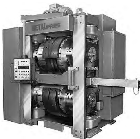
Rys. 4.32. Nowoczesny agregat do walcowania poprzeczno – klinowego, serii ULS, produkowany przez firmę Šmeral w Brnie (na walcach widoczne są segmenty klinowe)
