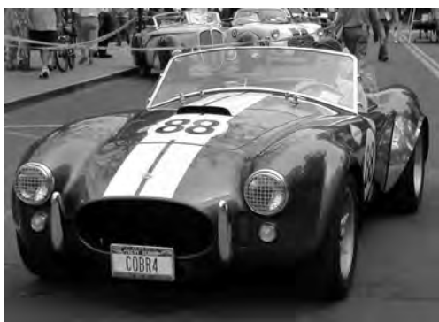
Rys. 6.27. AC Cobra 427 lub Shelby Cobra 427 z roku 1965, wyposażony w silnik V8 o pojemności 6989 cm 3 i mocy 425 KM. W samochodzie tym zastosowano m.in. aluminiowe nadwozie oraz gruntownie przebudowano elementy zawieszenia. Od wielu lat na całym świecie powstaje wiele replik tego słynnego samochodu.
