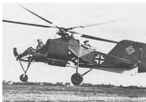
Rys. 8.76. Śmigłowiec FL-282: silnik 119 kW, średnica wirnika 11,96 m, długość 6,65 m, wysokość 2,2 m, masa startowa 1000 kg, prędkość max. 150 km/h, pułap 3300 m, zasięg 170 km
