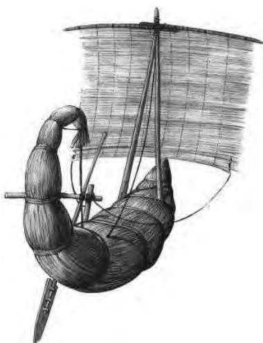
Rys. 7.2. Egipska łódź wykonana z trzciny
