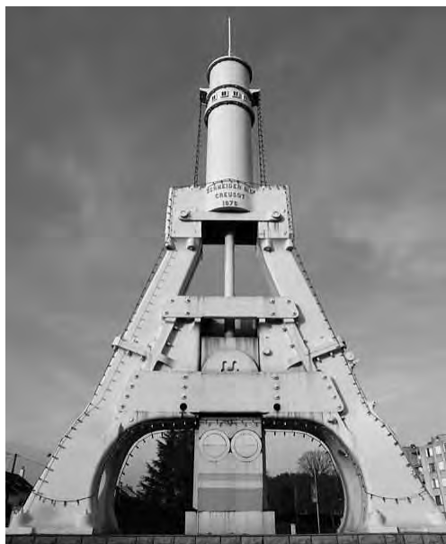
Rys. 4.17. Młot parowy w Le Creusot (masa bijaka ok. 100 t), widok obecny
