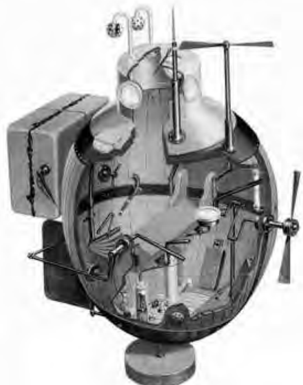
Rys. 7.39. Pojazd podwodny „Turtle”, skonstruowany przez Davida Bushnell’a, 1776 r.
