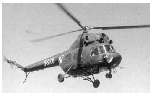
Rys. 8.90. Śmigłowiec Mi-2. Dane techniczne: w kadłubie zbiornik na 440 litrów paliwa; dodatkowy zbiornik zewnętrzny mieszczący 476 l., pojemność wersji pasażerskiej - 8 osób, wersji towarowej - 700 kg ładunku, max. pułap - 4000 m, max. prędkość - 200 km/h, zasięg - 797 km
