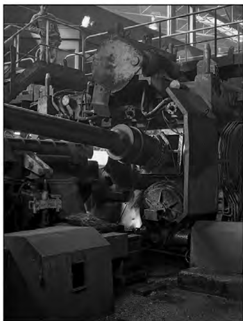
Rys. 4.31. Dziurowanie tulei rurowej we współczesnej dwuwalcowej walcarni skośnej
