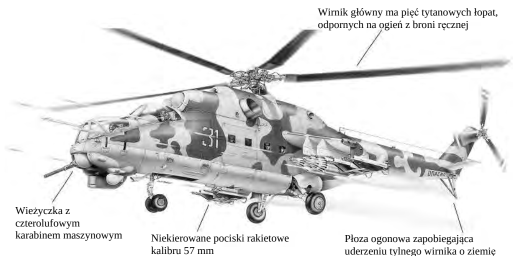
Rys. 8.83. Mi-24 Hind-D: produkcja od 1969 r., długość 21,35 m, wysokość 5,47 m, średnica wirnika głównego 17,3 m, masa własna 8450 kg, maksymalna masa startowa 11800 kg, prędkość maksymalna 335 km/h, pułap praktyczny 5000 m, zasięg 500 km
