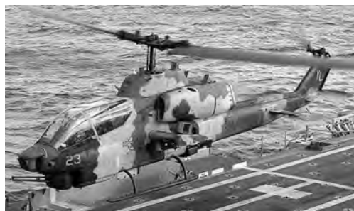
Rys. 8.78. Bell AH-1 Cobra: maszyna ta ma specjalne ostrza umieszczone pod i nad kabiną załogi, służące do przecinania kabli wysokiego napięcia
