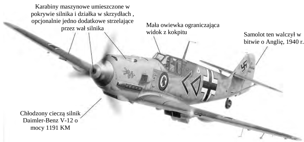
Rys. 8.49. Messerschmitt Bf 109 E, który mógł rozwijać prędkość do 560 km/h
