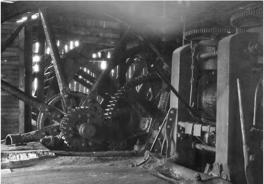
Rys. 4.27. Pochodząca z 1843 roku walcarka w Maleńcu, napędzana energią z koła wodnego, dostarczana z pomocą układu przekładni zębatach z kołem zamachowym.
