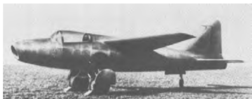
Rys. 8.42. Heinkel He 178 z napędem turboodrzutowym zalicza pierwszy lot w dniu 27.08.1939
