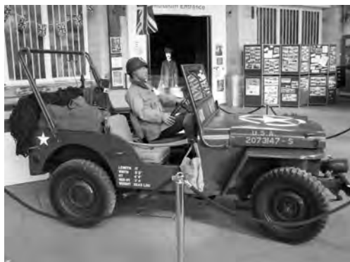
Rys. 6.21. Jeep MB, z silnikiem o pojemności 2.2 l. Uzyskiwał moc 60 KM/4000 obr/min i miał napęd na cztery koła (stały na tylne i dołączany na przednie)
