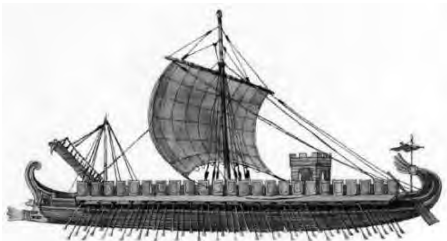
Rys. 7.9. Rzymski trójrzędowy okręt wojenny, w części dziobowej jednostki widoczny jest uniesiony pomost bojowy, tzw. kruk
