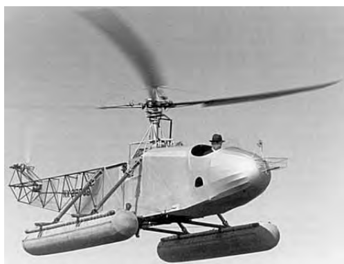
Rys. 8.75. Vought-Sikorsky VS-300: średnica wirnika 9,14 m, długość 8,53 m, wysokość 3,05 m – pierwszy lot swobodny: 13.05.1940 roku.
