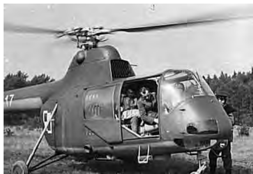
Rys. 8.89. Śmigłowiec PZL SM-2: średnica wirnika - 14,30 m, długość kadłuba - 16,90 m, szerokość kadłuba - 12,08 m, masa z uzbrojeniem - 2550 kg, prędkość max. - 170 km/h, zasięg - 310 km
