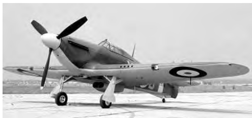
Rys. 8.44. Hawker Hurricane. Dane techniczne (wersja MK1 z 1937 r.): silnik: Rolls-Royce Merlin III o mocy 1030 KM; rozp./dł./wys.: 12,2/9,59/3,96 m; masa startowa: 2994 kg; v_{max.} : 520 km/h; pułap: 10900 m; zasięg: 965 km; uzbrojenie: karabiny maszynowe 8x 7,7 mm
