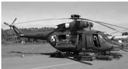
Rys. 8.91. Śmigłowiec PZL W-3 Sokół : długość - 18,79 m , wysokość - 5,14 m, średnica głównego wirnika - 15,70 m, masa własna - 3 850 kg, maksymalna masa startowa - 6400 kg, prędkość maksymalna - 243 km/h, pułap praktyczny - 6000 m, zasięg - 745 km
