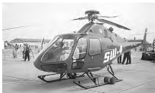
Rys. 8.92. Śmigłowiec PZL SW-4: długość: 10,57 m, wysokość: 3,05 m, średnica wirnika głównego 9 m, masa własna 1050 kg, maksymalna masa startowa 1800 kg, prędkość maksymalna 260 km/h, pułap praktyczny 5200 m, zasięg 790 km
