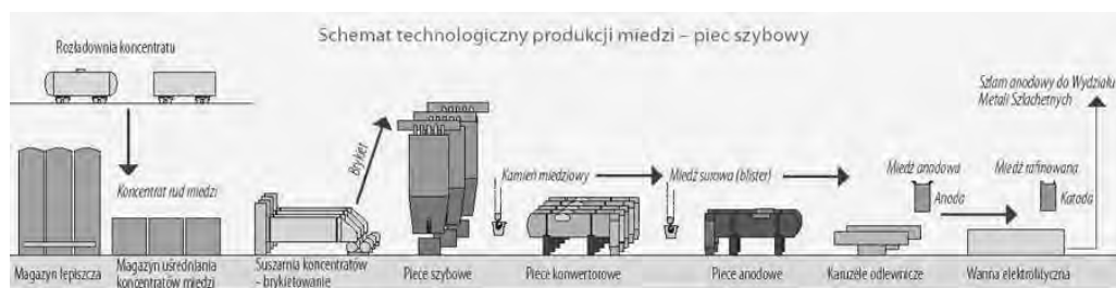
Rys. 3.35. Schemat technologiczny produkcji miedzi w HM „Legnica”
