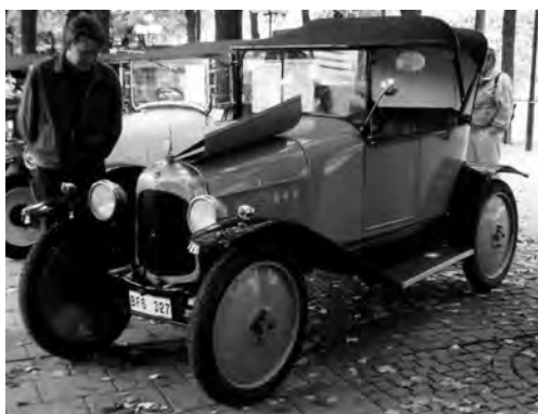
Rys. 6.18. Citroen typ A. 4-miejscowe auto z 4 cylindrowym silnikiem, które powstało początkowo w 30 egzemplarzach. Samochód ważył 990 funtów, zużywał galon benzyny na 35 mil. Standardowo wyposażono go w elektryczny rozrusznik, elektryczne światła i miękki dach.
