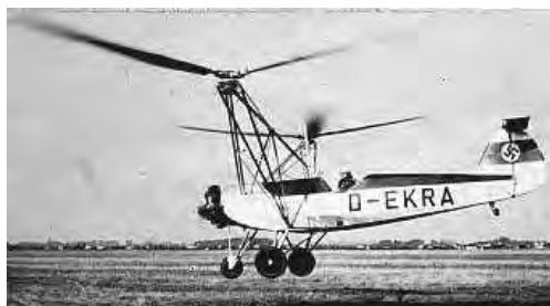
Rys. 8.74. Śmigłowiec Fw-61: prędkość max: 122 km/h, długość 7,29 m, średnica rotorów 7,0 m, zasięg 230 km, pułap 3200 m, 1937 r.
