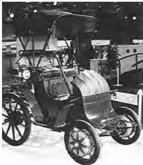
Rys. 6.16. Pierwszy samochód z napędem hybrydowym, skonstruowany przez Ferdynanda Porsche w 1899 r. (silnik spalinowy zasiliał generator, który wytwarzał prąd dla elektrycznych silników napędowych umieszczonych w bębnach przednich kół)
