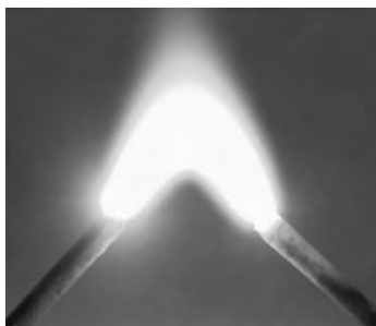
Rys. 4.49. Łuk elektryczny, czyli ciągłe wyładowanie elektryczne zazwyczaj w gazie pod ciśnieniem normalnym (atmosferycznym) lub wyższym. Łuk elektryczny ma własności i charakter plazmy. Jego temperatura zależy od natężenia prądu, rodzaju elektrod, rodzaju i ciśnienia gazu - pod ciśnieniem atmosferycznym i przy przepływie prądu 1 A wynosi ona 5000-6000 K.
