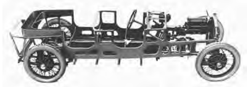
Rys. 6.19. Lancia Lambda (rys. górny), w której po raz pierwszy wykorzystano nadwozie samonośne (rys. dolny)
