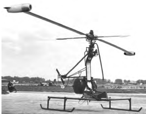
Rys. 8.86. Śmigłowiec JK-1 Trzmiel: masa startowa 340 kg, prędkość maksymalna 130 km/h, pułap 5500 m, zasięg 200 km
