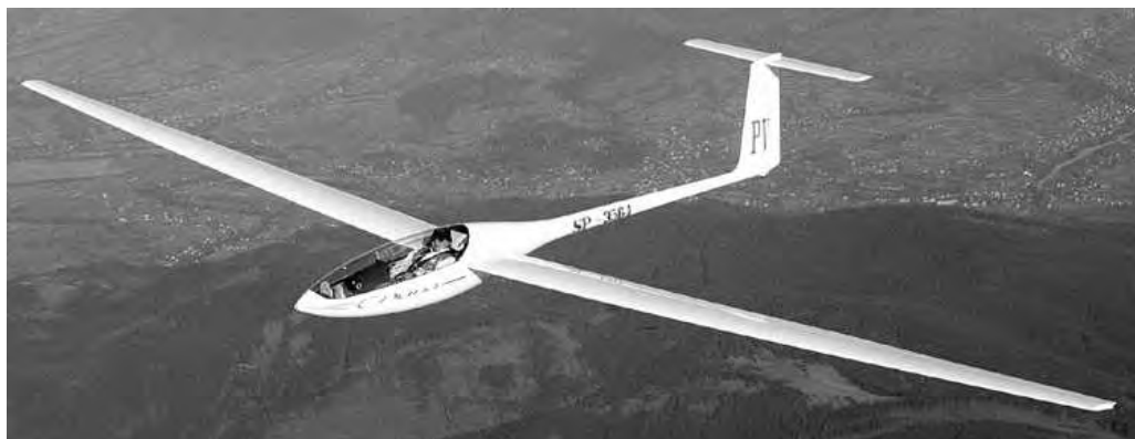
Rys. 8.15. Nowoczesny, polski szybowiec „Diana-2”. Dane techniczne: rozpiętość 15 m, długość 6,88 m, wysokość 1,35 m, pow. nośna 8,64 m 2 , masa 182 kg, max. masa startowa 500 kg.
