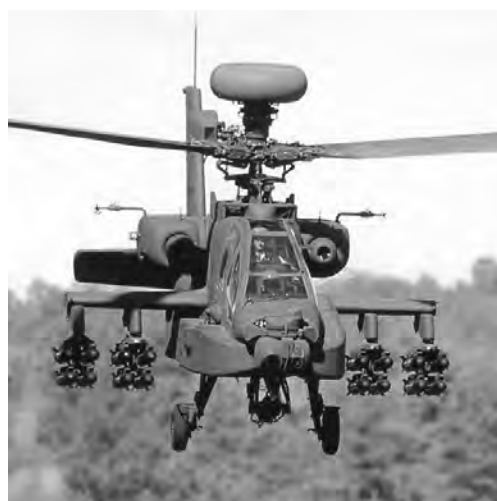
Rys. 8.84. AH-64D Apache: produkcja od 1982 r., długość: 17,7 m, wysokość 3,87 m, średnica głównego wirnika 14,63 m, masa własna 5165 kg, maksymalna masa startowa 9525 kg, prędkość maksymalna 365 km/h, pułap praktyczny 6400 m, zasięg 500 km
