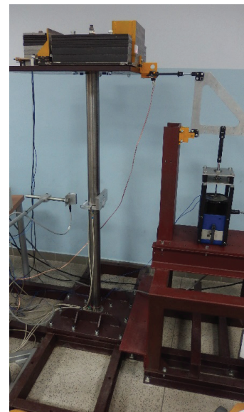
Rys. 7.28. a) Model układu maszt – gondola, b) widok stanowiska badawczego
