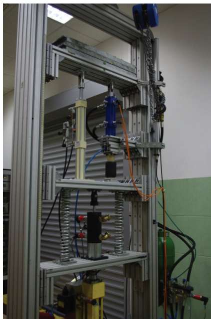
Rys. 7.8. Widok stanowiska badawczego z zamontowaną strukturą szeregowego zawieszenia aktywnego wraz z elementami pomiarowymi
