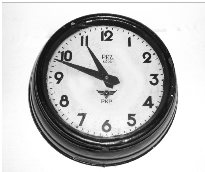
Rys. 2. Zegar ścienny z napędem sprężynowym i krótkim wahadłem wytwarzany w PFZ w Łodzi w latach 1946 i 1947, dla PKP (fot. autora)
