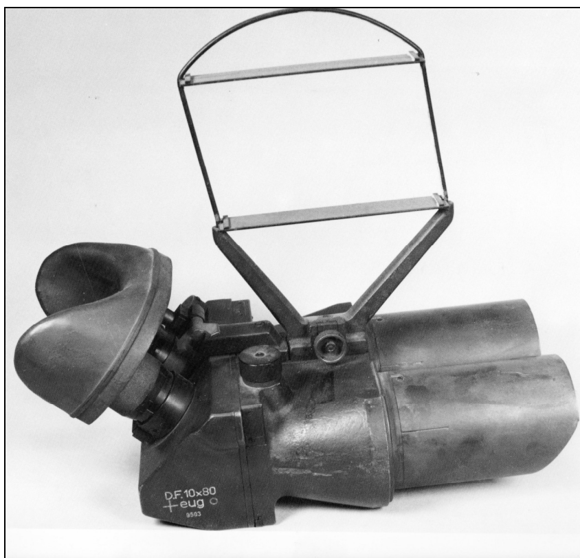
Rys. 5. Dwuoczna luneta obserwacyjna 10x80. Umieszczone na korpusie lunety napisy oznaczały: DF – Doppelfernrohr (luneta dwuoczna), 10 – powiększenie, 80 – średnica obiektywu, + stosować smar zapewniający prawidłowe funkcjonowanie lunety przy temperaturze -40 °C, eug – symbol producenta, O – symbol innego smaru zapewniający możliwość funkcjonowanie w takiej samej temperaturze, 9503 – nr serii produkcyjnej.
