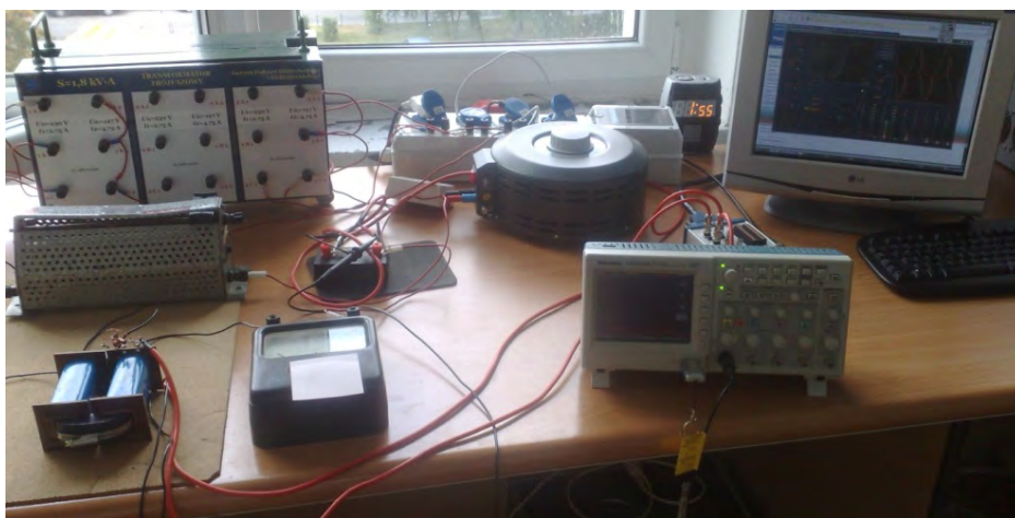
Rys. 3.54. Układ pomiarowy testowanego dławika
