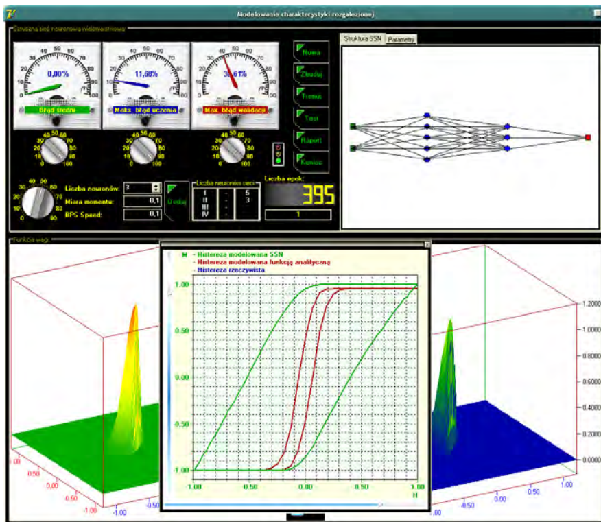
Rys. 3.20. Ekran środowiska symulacji histerezy metodą Preisacha zbudowanego w Zakładzie Elektrotechniki Teoretycznej Politechniki Lubelskiej
