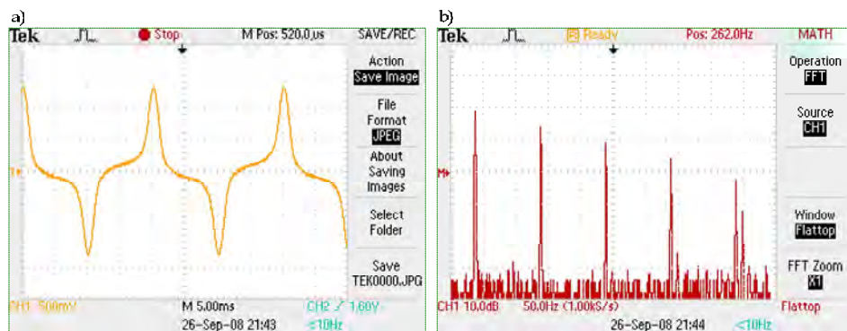
Rys. 3.55. Przebieg (a) oraz widmo (b) sygnału dla kanału pomiaru prądu (dla E_m=120 V). Pomiar wykonany oscyloskopem TDS 2024B
